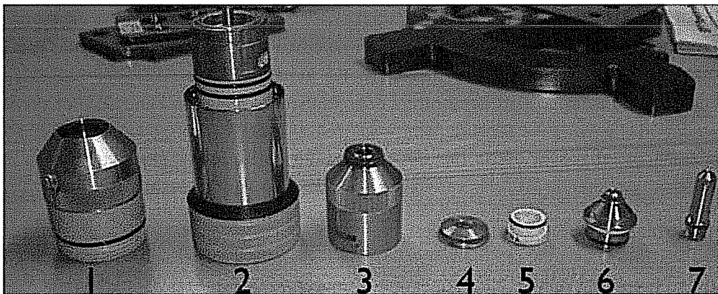
Figur 5 - Plasmaskärarens olika komponenter; 1 skyddskåpa, 2 munstyckets bas, 3 yttre dysa, 4 sköld, 5 swirl ring, 6 inre dysa, 7 elektrod
