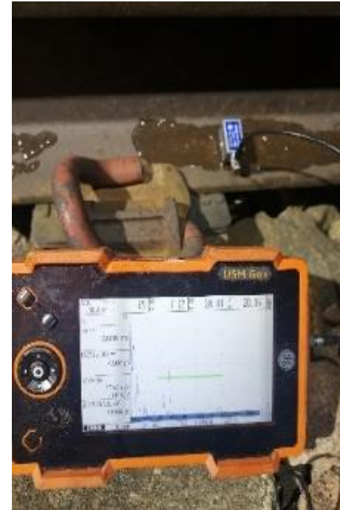
UT-kontroll med manuell sökare på rälfot
