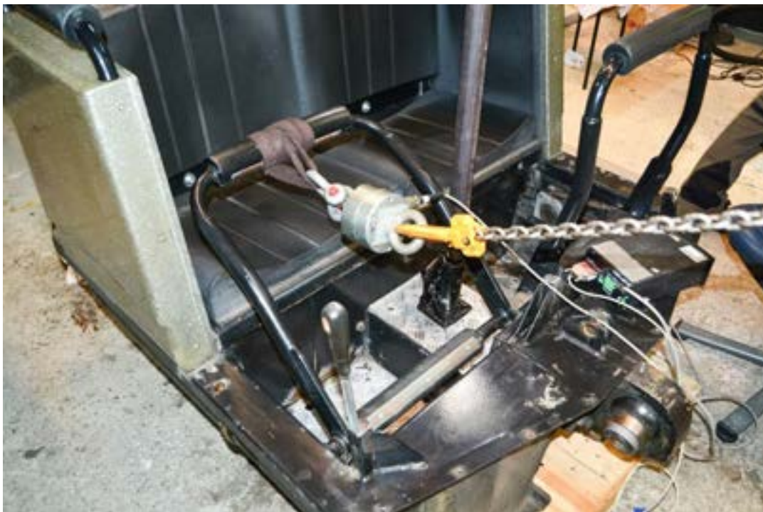
Figur 22. Riggning vid dragprov av en säkerhetsbygel.
