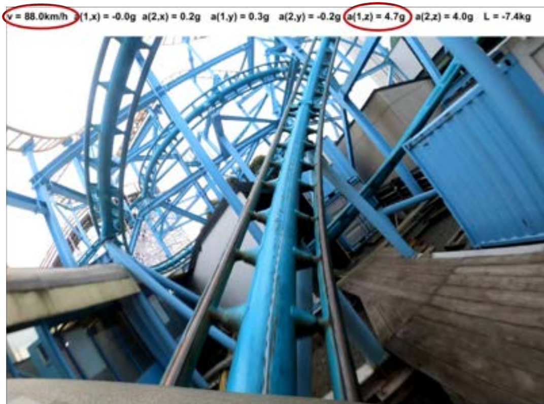
Figur 23. Bild från testkörningen som visar tåget i positionen för första islaget i banan. Hastigheten var vid detta tillfälle 88 km/h och belastningen var 4,7 g i främre vagnen.
