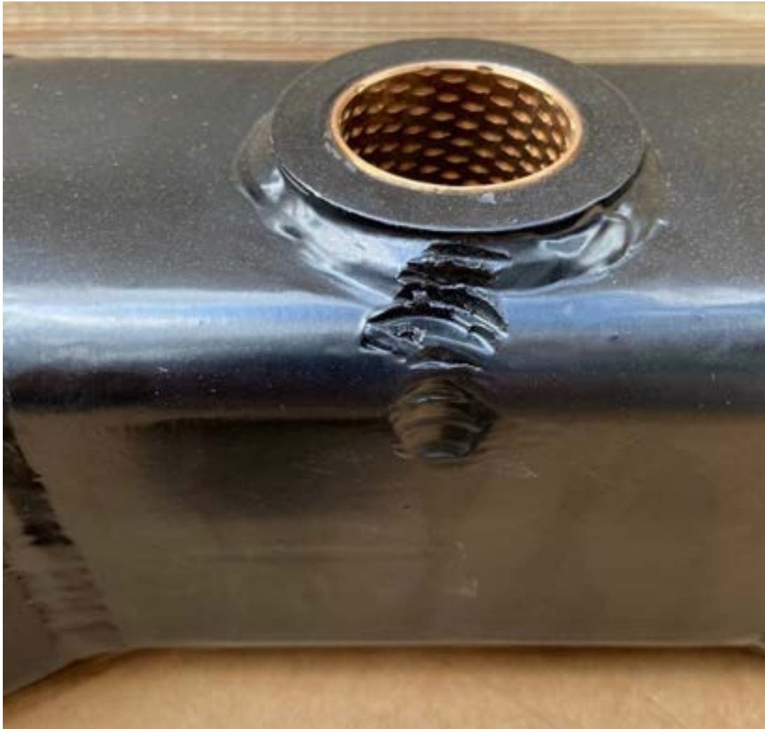
Figur 26. Skadorna som sannolikt uppkommit vid tillverkningen på en av de fem bärarmar som levererades 2019.
