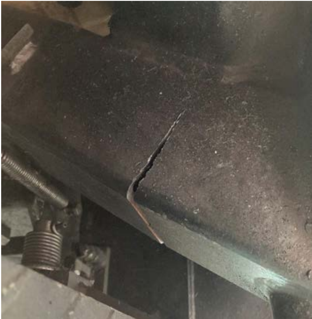
Figur 27. Sprickan som upptäcktes 28 augusti 2022 i en ursprunglig bakre bärarm från 1988. Foto: Gröna Lund AB.
