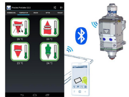
Bild 12. T.h. Övervakning av skärhuvudets kondition är välutvecklad i Precitec ProCutter.
