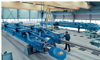
Figur 46. Hos Bosch Rexroth B.V. belägger man hydrauliska kolvar för off-shore där höga krav på slitstyrka och korrosionsskydd föreligger. T.h. tvärsnitt och yta hos en belagd cylinder före respektive efter genomförd ytfinishoperation.
