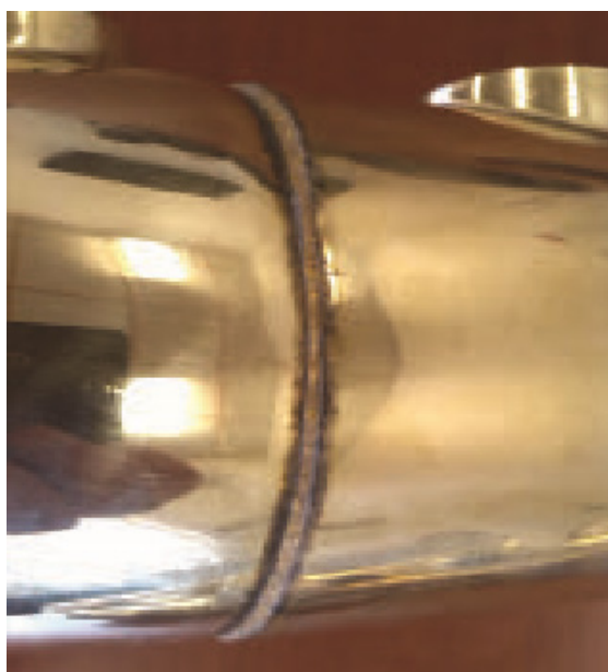
Figur 2. Med rätt parameterval, i form av lasereffekt, svets-hastighet, fokalpunktsläge och optimalt val av skyddsgasblandning, får man en hög kvalitet vid svetsning av mässingslegeringar.
