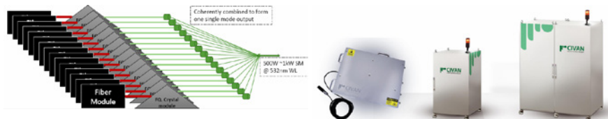
Figur 19. Ovan principen för CBC som ligger till grund för israliska Civan SM-fiberlasrar med upp till 1 kW effekt. De bästa resultaten erhöles då man använde en liten fokuspunkt på mellan 50-200 µm diameter och lasereffekter upp till 16 kW. Dock är det problematiskt att fastställa ett korrekt penetrationsdjup
