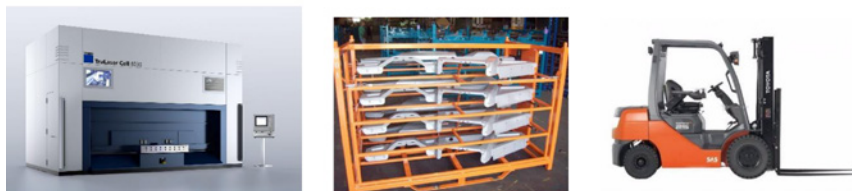
Bild 4. Renskärning och håltagning med laser i varmformade detaljer sker i stora gantrysystem med materialet staplat i rackar vilka transporteras med truck mellan stationerna.
