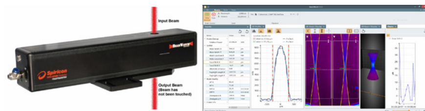
Figur 17. Med Ophirs "Beam Watch" kan laserstrålens kaustik analyseras såsom energitätheten i fokuspunkten och den så förhålliga fokuspunktsförföring.
