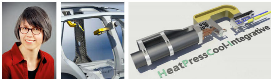
Figur 54. Frau Annett Klotzbach presenterade en av många IWS-innovationer; HPCI, vilken är en punktsvetsliknande tång med integrerad distribution av en laserstråle, och med vars hjälp man exempelvis kan foga glasfiberförstärkta artiklar till metall i en karosstruktur.
