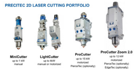
Bild 13. Precitec kan erbjuda en familj skärhuvuden för planskärning som täcker effektområdet 1-12 kW. ProCutter och ProCutter Zoom kan också erbjudas med speciell teknik för att effektivisera piercingprocessen, PierceTech. Till ProCutter Zoom finns också en option att få EdgeTech som förbättrar skärkvaliteten i tjockt material.
