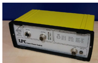
Figur 47. För att minimera inlösnings i grundsubstratet kan man använda verktyget LPowC som med CCD-kamera avläser intensiteten i processljuset inom två koncentriska cirklar och anpassar laser-effekten därefter.
