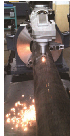
Figur 1. Insatsrör som används för att separera sediment i tung råolja kräver tusentals laserskurna slitsar. Därför behövs laserkällor med hög effekt så att satta produktivitetskrav kan innehållas.
