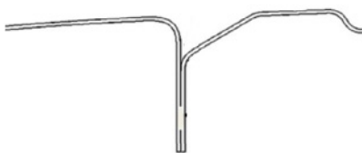
Bild 24. Lödfog på hyttens sida (övre) och fog på tak och front (undre)
