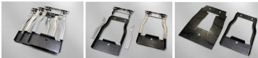
Figur 38. I IWS' "Multi Remote Station" tillverkades nedanstående lastbärande struktur till en Daimlermodell. Denna komponent består av Tepex®-material och E355-stål och där sammanfogningen utfördes med laserteknik.
