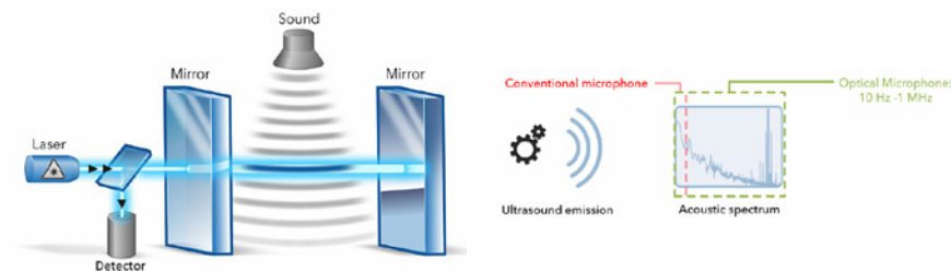
Figur 35. Med en "optisk mikrofon", där laserljusets hastighet påverkas av tryckförändringar, kan man mäta ljudvågor i ett betydligt större frekvensband än vad som är möjligt med konventionella mikrofoner.
