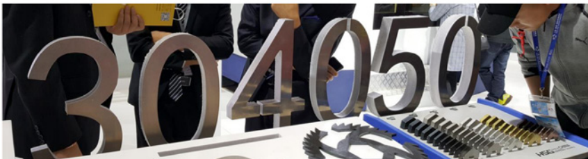
Bild 10. Materialtjockleken som kan skäras med laser och med acceptabel kvalitet och skärhastighet ökar ständigt. Gränsen ligger nu vid ca 50 mm.
