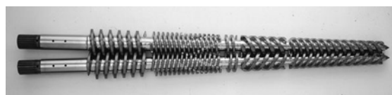
Figur 48. En verklig utmaning kan vara att ytbelägga artiklar med extremt komplexa geometrier som skruvgängan ovan utan att påverka dess geometri. Här kan verktyget LposC vara till hjälp, vilket tjänar som följning och vid variationer i ljusintensitet kan justera fokuspunktens läge för att på så sätt undvika distorsioner
