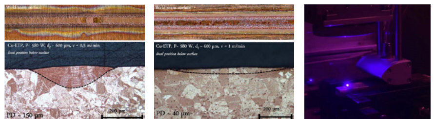
Figur 23. Initialia resultat från kopparsvetsning med en "blå" laser från Laserline; svets hastighet 0,5 och 1,0 m/min med penetrationsdjupen 150 respektive 40 µm.
