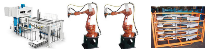
Bild 5. Renskärning av varmformade detaljer med laser och robot kan ge stora kostnadsbesparingar i utrustning och logistik.
