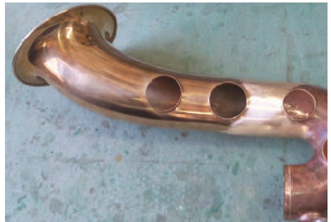
Figur 1. Exempel på lasersvetsade artiklar till saxofoner, där en lättare polering av svetsrågen innebär en näst intill osynlig fog.
