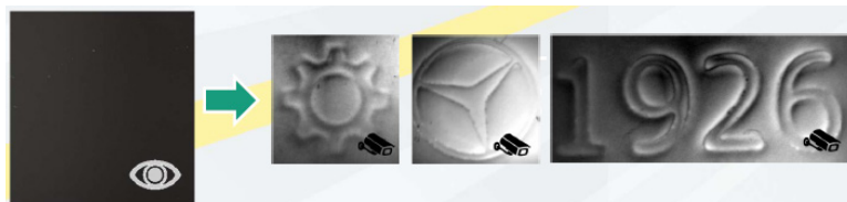
Figur 9. "Säkerhetsfeatures" i form av övermalade lasermärkningar vilka blir synliga då ett magnetfält appliceras över det märkta området.
