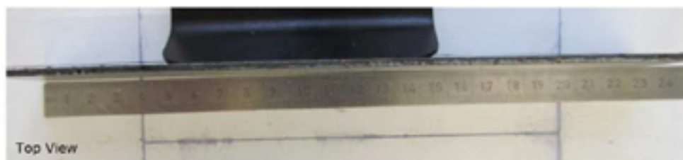
Figur 5. Sidovy, toppvy och tvärsnitt av en lasersvetsad flänsfog i zinkbelagd stålplåt med stråloscillering.
