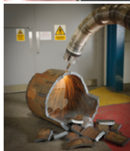
Figur 6. Lasersnake i färd med att sönderdela uttjänta kärnreaktorer med hjälp av 5 kW lasereffekt och tryckluft som skärgas.
