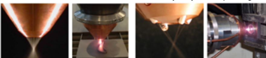
Figur 3. Pulvertillförsel vid additiv tillverkning. Fr.v. från sidan (lateralt), i mitten ringformat munstycke, t.h. multi-beam munstycken.
