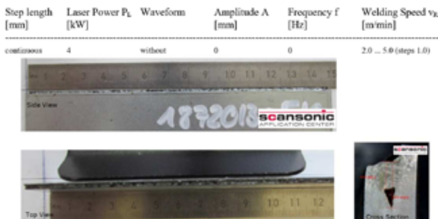
Figur 4. Sidovy, toppvy och tvärsnitt av en lasersvetsad flänsfog i zinkbelagd stålplåt utan strålscillering.
