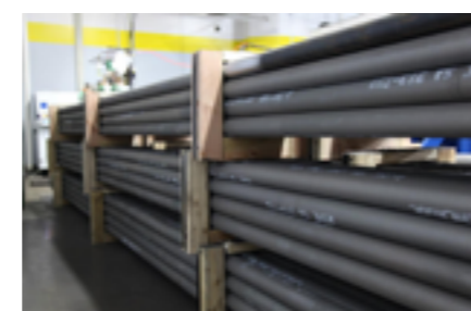
Figur 36. Laserpåläggning av rör för ångpannor har blivit något av en specialitet för företaget Joining Technologies Inc., och då rören oftast är mer än tio meter långa är det tillverkning ”round the clock” som gäller.
