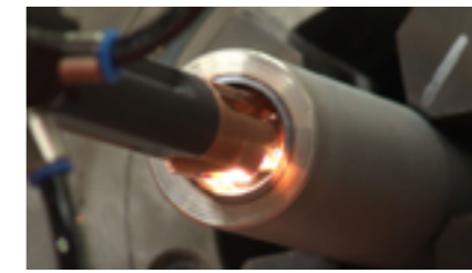
Figur 22. Invändig laserbeläggning av rör kräver speciellt utformade verktyg, vilka är vattenkylda och klarar rörlängder på 500 mm (ø 30 mm) respektive 1.500 mm (ø 50 mm).
