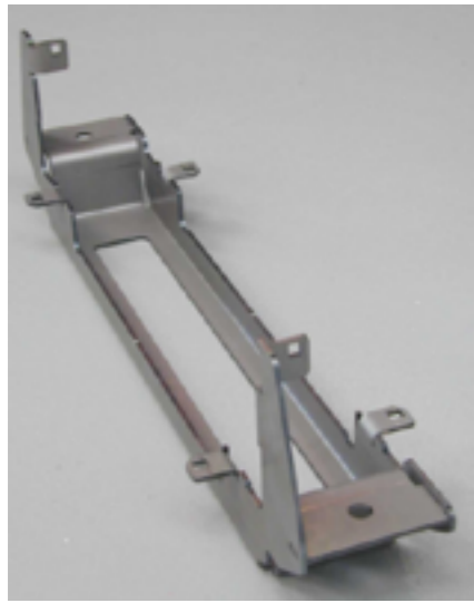
Figur 14. Att perforera viklinjer i plåtar som senare bockas till tredimensionella artiklar har blivit ett nytt användningsområde för laserskärning/-börning.
