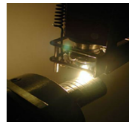
Figur 37. Lasersvetsning av katalysatorer gor man med diodlaser hos det finska foretaget EcoCat.
