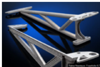
Figur 34. Genom att integrera supportstrukturen i konstruktionen kan man bespara det annars kostsamma avlägsnandet av densamma vid efterbearbetning av detaljen.
