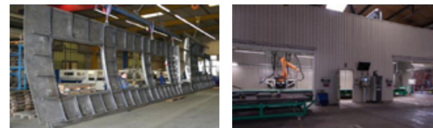
Figur 4. Såväl vagnssidor som takpaneler till ICE-tågens vagnskorgar lasersvetsas i nybyggda lokaler hos Photon Laser Manufacturing GmbH i Schönwalde-Glien nära Berlin. Lasercellen har en längd på 25 meter och totalt använder man sig av 2.400 olika svetsprogram.
