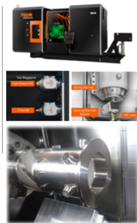
Figur 13. Yamazaki Mazak har lanserat en maskin för additiv tillverkning där man kan växla mellan påläggnings-munstycken avsedda för snabb respektive precis deponering. T.h. ett oljehus av SUS316-material som belagts med Inconel718 i denna maskin.
