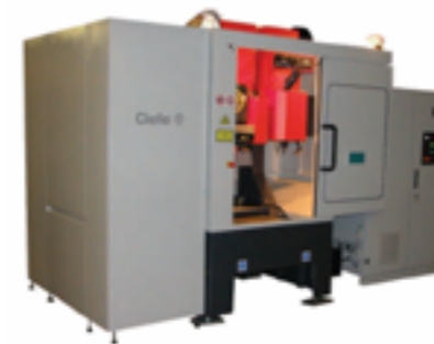
Figur 2. Kombinationsmaskinen "Gamma Dualtech 60/50" från företaget Cielle kombinerar fräsning och laserpolering. Den är utrustad med fyra axlar och har ett mobilt arbetsbord för tillverkning av tryckplåtar och stansverktyg.
