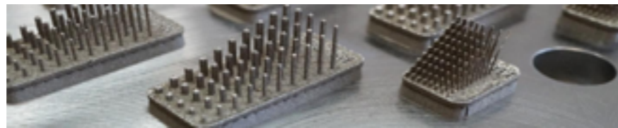
Figur 32. Ovan nagra av alla de ”mikro”-pelare med varierande tvarsnittsarea och hojd som ingick i studien, och darunder gar det att konstatera att tunnare pelare far en konvex toppyta medan grovre erhaller en konkav sadan.
