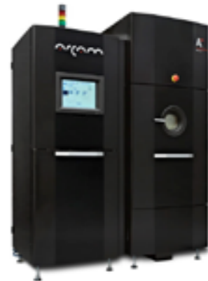
Figur 33. Arcam A2X är en elektronstrålebaserad maskin för SLM. Temperaturen i dess vakuumkammare kan varieras upp till 1.100 °C, vilket gör att man kan undvika de spänningar som annars riskeras byggas in i den tillverkade komponenten.
