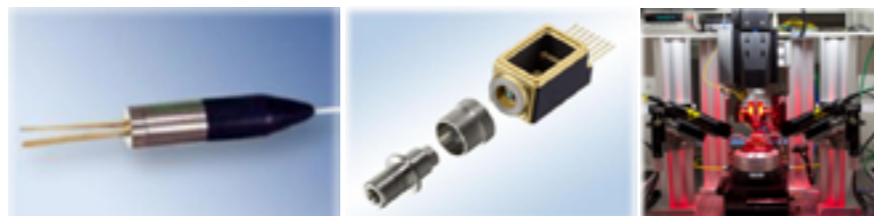
Figur 7. Dessa TOSA-element lasersvetsas med en pulsad Nd:YAG-laser, där pulsenergin ligger på 25 Joule och där man använder en uppställning (t.h.) som ger tre närliggande fokuspunkter.
