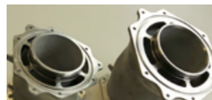
Figur 27. I mars 2016 ackrediterades foretaget Premium Aerotech att fa tillverka dessa "VentBent", en kopplingsenhet for branslepafyllning avsedd for "aerospace"-applikationer, genom additiv SLM-tillverkning.
