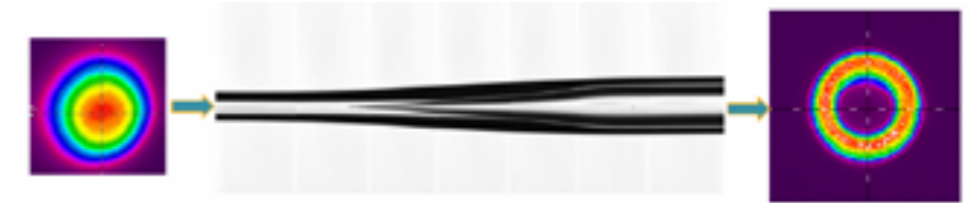
Figur 20. Med en avsmalnande optisk fiber utvecklad vid ORC går det att skapa intensitetsfördelningar av "doughnut-typ" med såväl radiell som azimutell polarisation.
