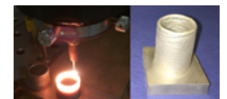
Figur 25. Cylindrar uppbyggda med LMD-teknik och bestående av 150 skikt nedsmält tillsatstråd
