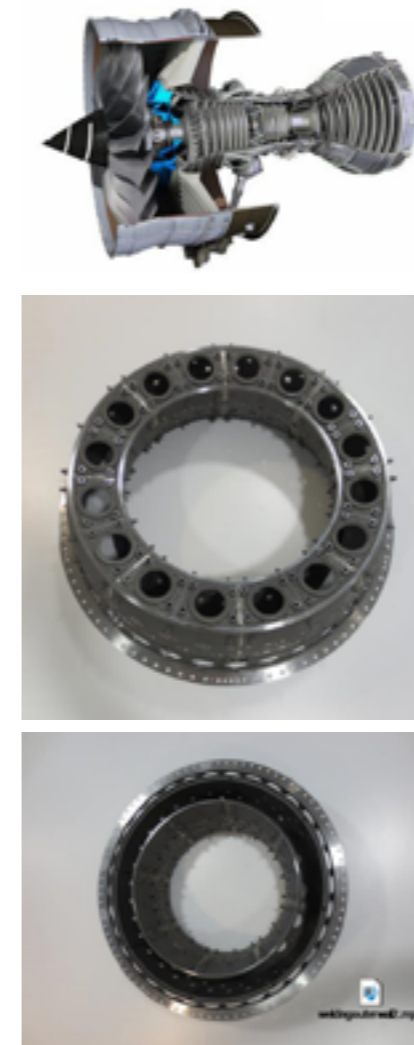
Figur 18. En med elektronstråle 3D-printad skiva (i blått) som kopplar samman fläkt och kompressorenhet i en turbin har minskat tillverkningstiden från 2 år till mellan 2-4 månader!
