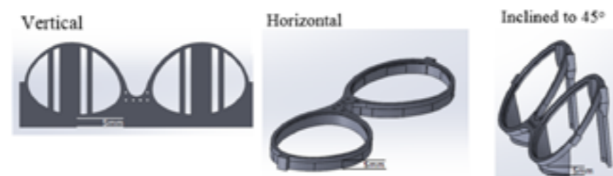
Figur 33. De tre olika byggsatt som anvandes vid SLM-framtagnin av solglasogonbagar i rostfritt 316L-material, och t.h. ser man att borttagandet av supportstrukturer utgor en stor andel av den totala tillverkningstiden.
