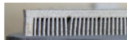
Figur 25. Misslyckade resultat vid SLM-tillverkning p.g.a. lokal overhettning t.v. och distorsioner orsakade av inbyggda spanningar (ovan).
