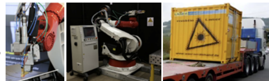
Figur 17. Senaste utrustningstillskottet hos LASER on demand är denna KR150-robot från KUKA, vilken behändigt kan förpackas i företagets container för "laserupp-gifter" på annat håll.
