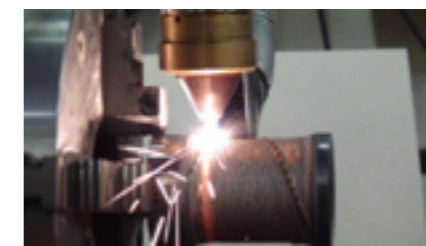
Figur 21. Reparation av en ljuddämpare där Stellite21 beläggs med Stellite6 och 6 kW lasereffekt.
