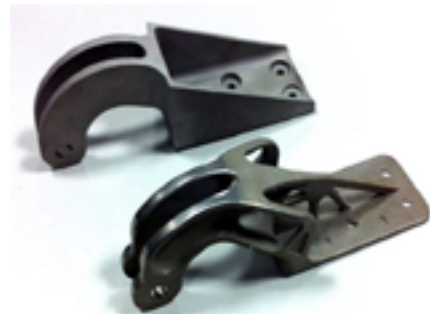
Figur 31. Några exempel på SLM-tillverkade artiklar; frv. tandersättningar, skallimplantat, insprutningsmunstycken och det välkända Airbus-gångjärnet tillverkat med konventionell teknik (överst) respektive SLM (underst).
