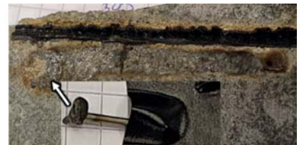
Figur 8: Stillbild från höghastighetsfilm med smält stenyta och ståltråd (vänster) och resulterande yta där det ”sammanfogade” materialet lätt lossnade från ytan.
