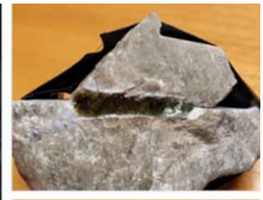
Figur 8: Stillbild från höghastighetsfilm med smält stenyta och ståltråd (vänster) och resulterande yta där det ”sammanfogade” materialet lätt lossnade från ytan.
