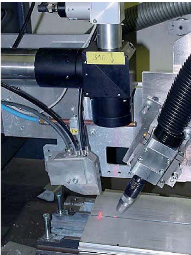
Figur 5. Uppställning för JURCA:s koncept med fogföljning och möjlighet till adaptiv fyllnadsgrad vid hybridsvetsning.
