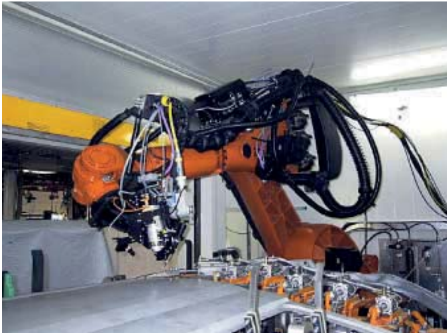
Figur 7. Kombinerad lasersvetsning/laserlödning av karossidor i VWs Poznan-anläggning.
