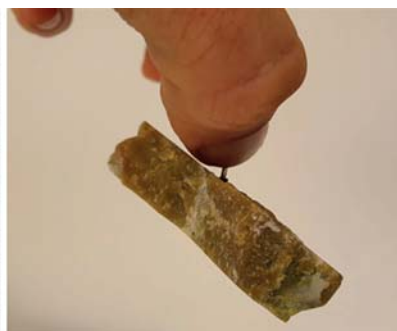
Figur 10: Stillbild från höghastighetsfilm under stelningsförloppet för ”laser plugging” då processen utförts (vänster). En bit serpentin hålls upp i den metalltråd som är fäst i den (mitten) och röntgenbild av ett flertal metalltrådar som fästs (med olika parametrar) i olivinsten.
