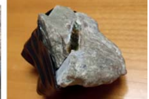
Figur 9: Stillbild från höghastighetsfilm med smält stenyta och stålplåt där smälta och två separata men intilliggande smältbad har skapats (vänster). Ihopsvetsad olivinsten (höger).
