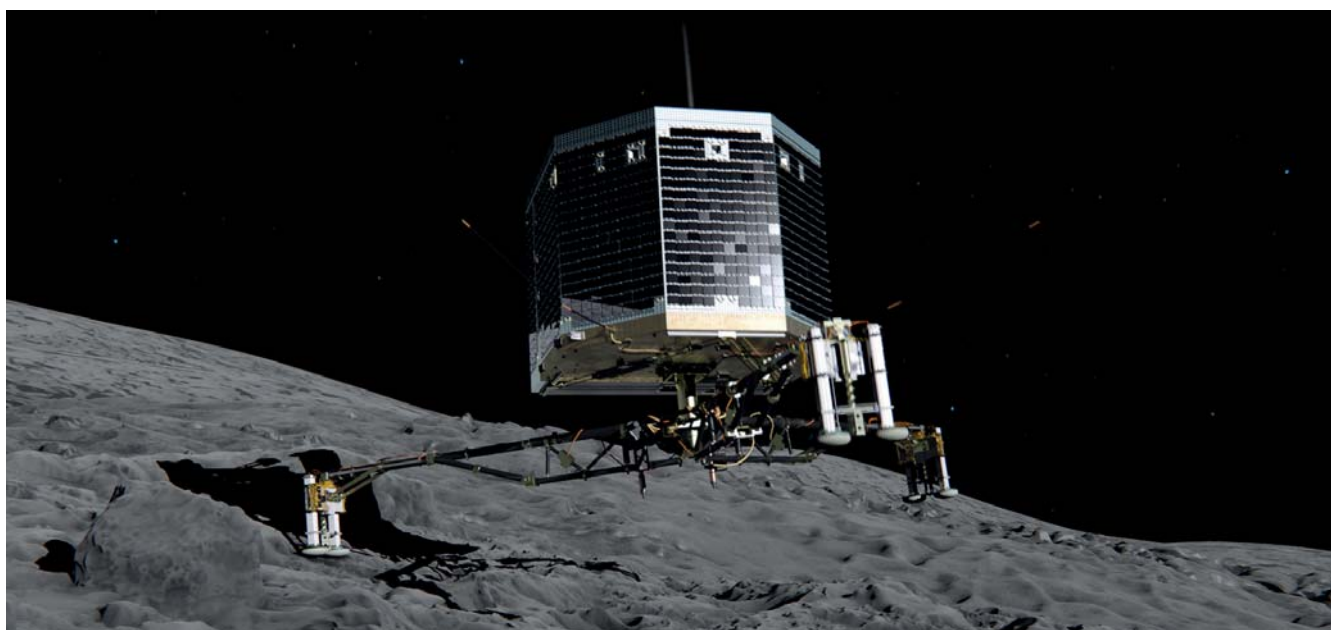
Figur 7: Illustration av satellitfot som blivit fäst vid yta på asteroid.
