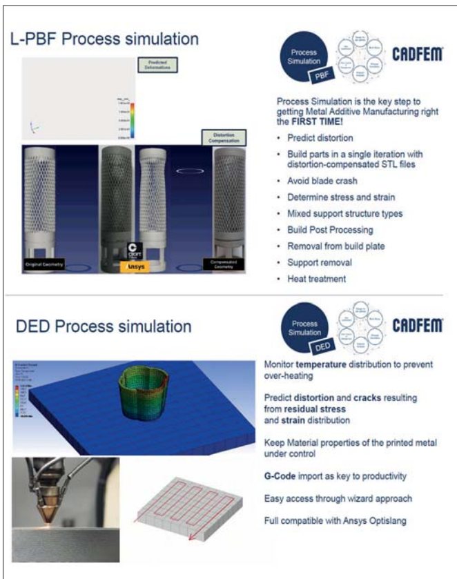
Figur 11: Simulering av LPBF och DED processerna.
