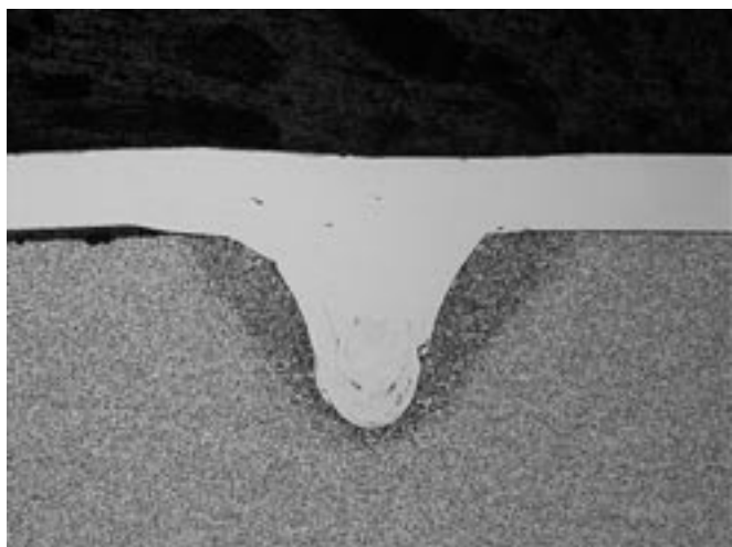
Figur 1. Lasersvets i brytbricka som finns i gasgenerator för krockkuddar.
