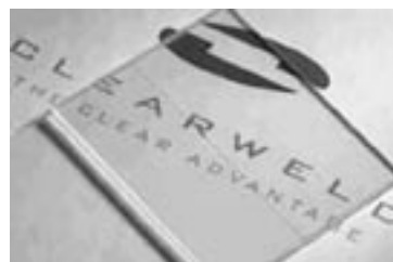
Figur 8. Två 1,5 mm tjocka plattor i transparent polykarbonat lasersvetsat med transmissionsfog med ett tunt lager Clearweld mellan plattorna [3].
