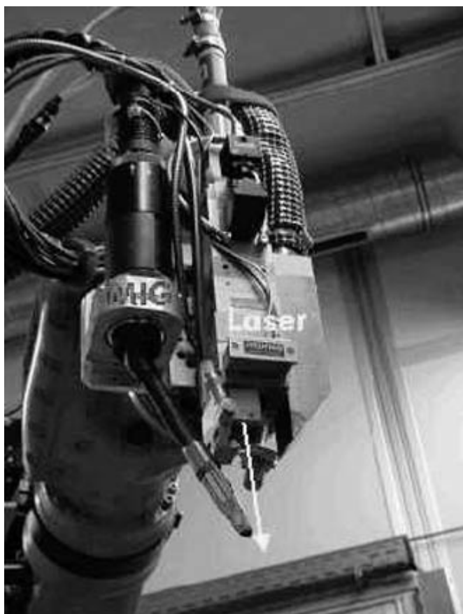
Figur 4. Detaljbild på det laserhybridsvetshuvud som används vid svetsning av VW Phaetons aluminiumsidodörrar.
