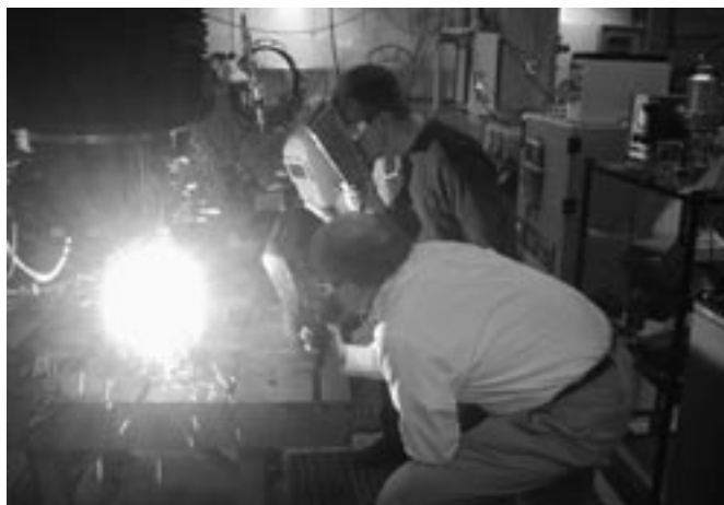
Figur 1. Laserhybridsvetsning av tvärbalk gav bra resultat konstaterar nöjda kursdeltagare.
