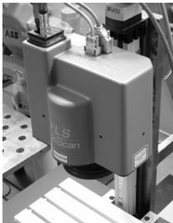
Figur 4. FLS ironScan strålpositioneringsenhet integrerad med processhuvudet till Fisba Optik FLS Ultra.
