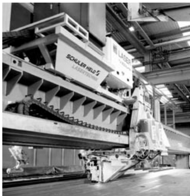
Figur 6. Laserhybridsvetsning av däckspaneler vid Meyerwerft i Tyskland.
