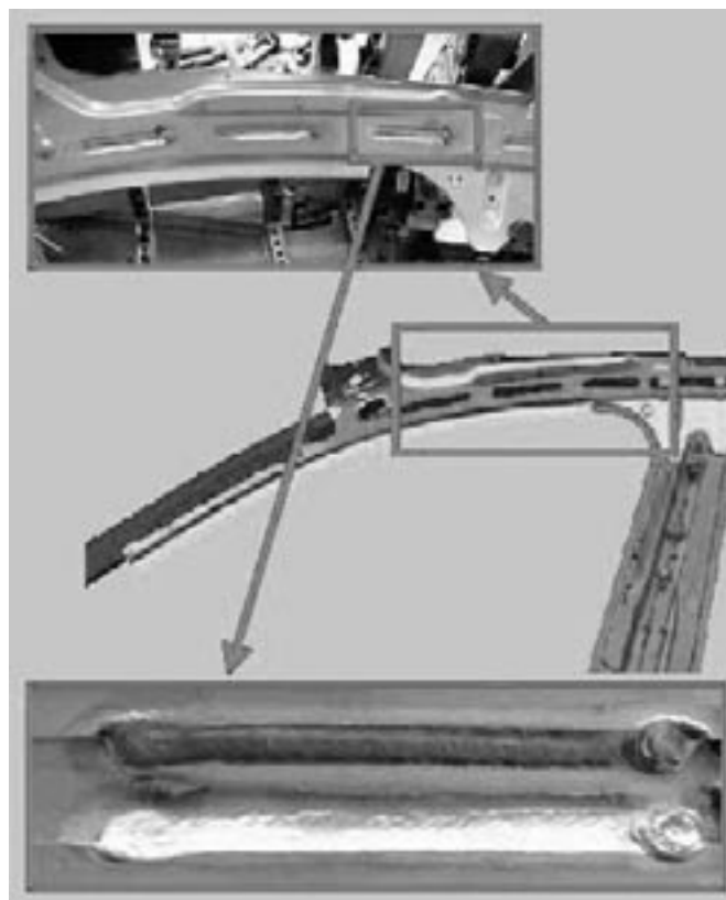
Figur 6. Exempel på svetskvalitet vid laserhybridsvetning i taksvällarområdet. Svetsparametrar: Lasereffekt 3.8kW, svetshastighet 3.6m/min, trådmätningshastighet 4.5m/min.
