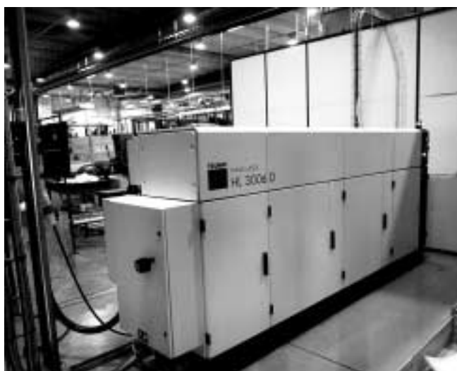
HL 3006 D, laserenheten som via en fiberoptisk länk förser laserhuvudet med ljus.
