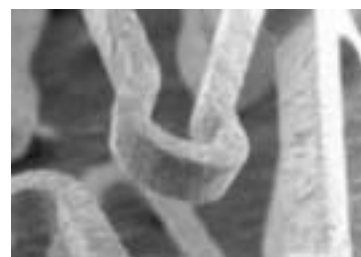
Figur 5. Laserskärning av s.k. stent med fiberlaser efter ultraljudrengöring.
