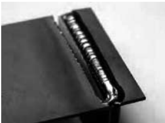
Figur 12. När det inte riktigt går som man tänkt sig! S.k. "samtidig svetsning och skärning"; en kuriositet från diodlaserförsök vid University of Nottingham.
