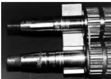
Figur 1. Typiska fartygskomponenter innan (underst) och efter (överst) reparation med hjälp av diodlaser.
