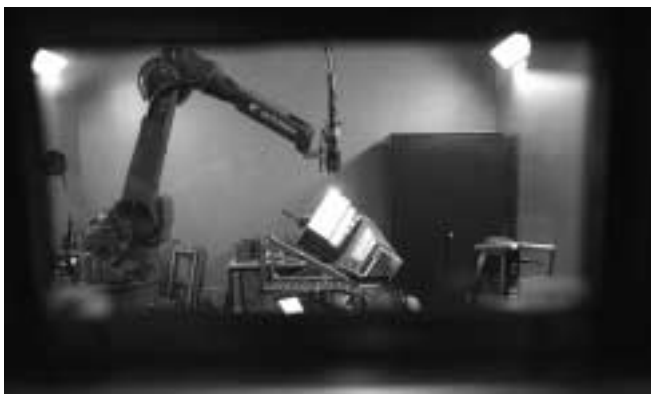
Lasersvetsen i fullt arbete. Notera den fiberoptiska ledningen som kommer uppifrån.
