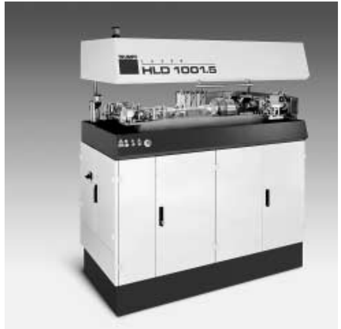
Trumpf HLD 1001.5 - den första serieproducerade högeffektskivlasern.
