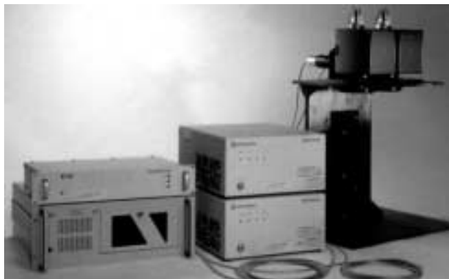
Figur 3. Märksystem med fiberlaser. Systemet består av två fiberlasrar med dubbla scanningshuvuden.
