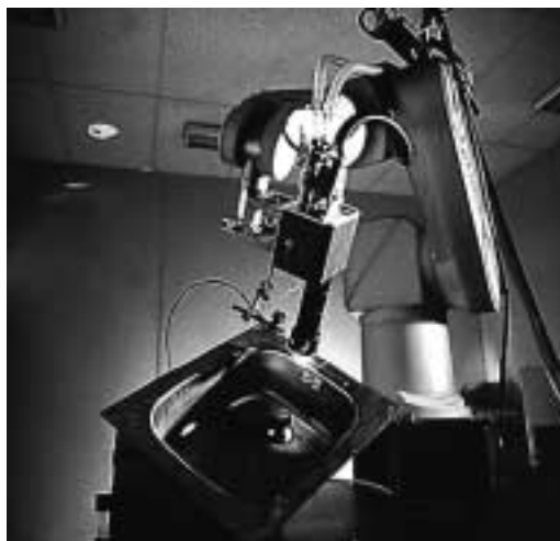
Figur 10. Värmeledningssvetsning av diskho rostfritt stål ger en svets av hög kvalitet. Endast en polering behövs efter svetsningen för att få leveranskvalitet. Exempel på svetsgeometrier nedan (Källa: LaserLine GmbH)
