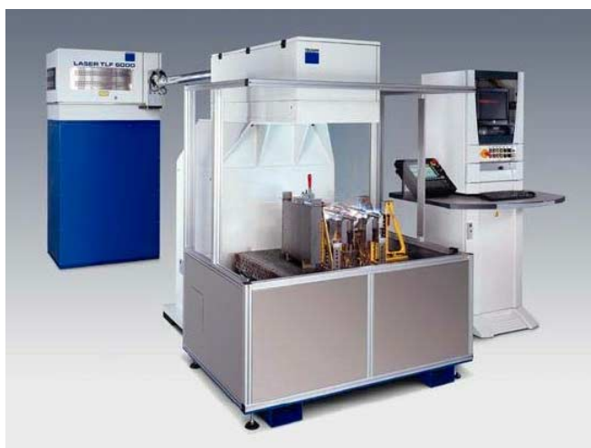
Trumpfs fjärrlasersystem med en 6 kW CO 2 -laser som källa.
