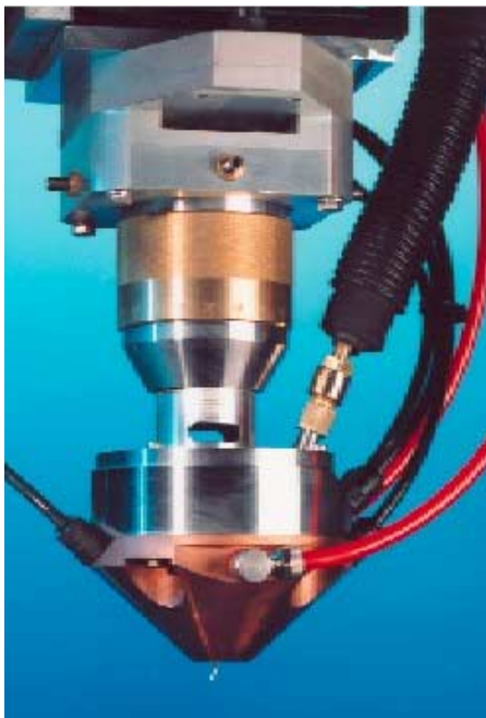
Exempel på "skräddarsydda" laserhybrid-svets huvuden. T.v. ett "heavy duty" monterat under optiken till en CO 2 -laser, och t.h. ett "super slim" kombinerat med en Nd:YAG-optik.
