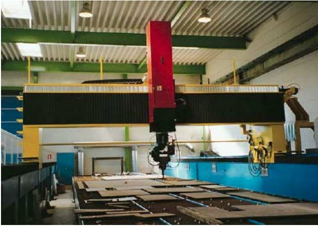
Den numera klassiska lasercellen vid Odense Steel Shipyard (OSS) där "Powercut"-lösningen fått sin slutgiltiga utprovning i verkstadsmiljö.
