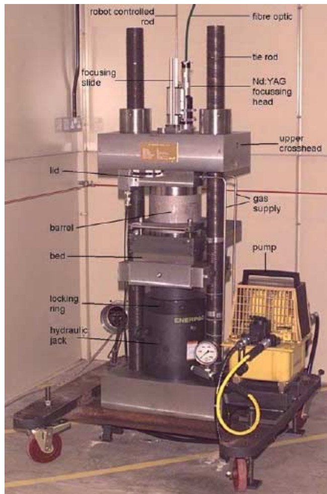
Högtryckssvetskammare vilken använts vid TWI för att utvärdera lasersvetsning i samband med sammanfogning av oljerör på stora djup.
