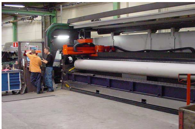
Laserskärning hos Transpo Konstruktions AB. Rörlaser: Bytube 6504, 3kw, arbetsområde 6500 mm Automatisk inmatning: max diagonalmått 175 mm Manuell inmatning: max diagonalmått 320 mm
