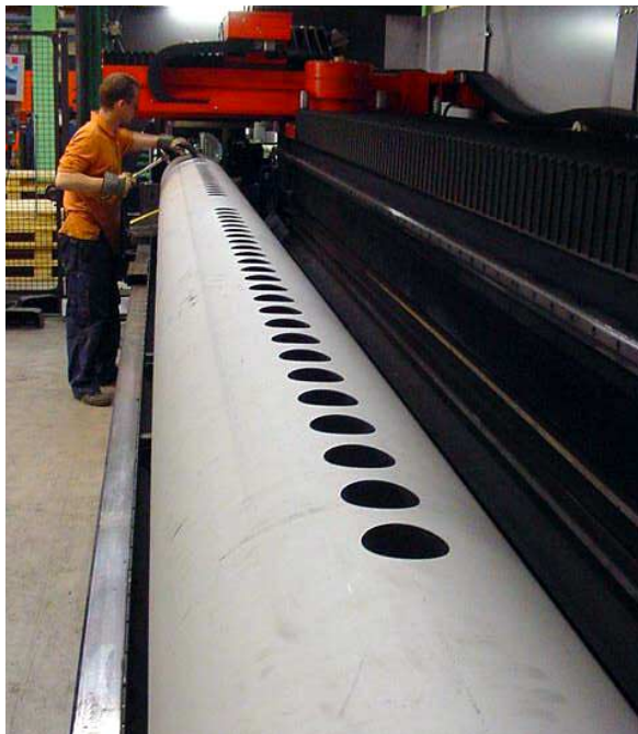
Laserskärning hos Transpo Konstruktions AB. Rörlaser: Bytube 6504, 3kw, arbetsområde 6500 mm Automatisk inmatning: max diagonalmått 175 mm Manuell inmatning: max diagonalmått 320 mm
