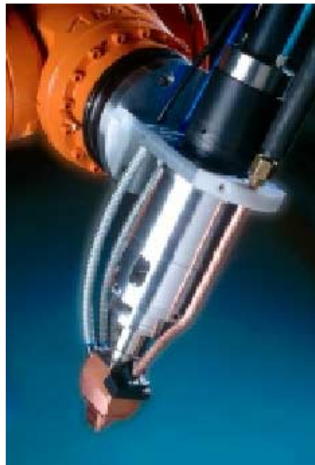
Exempel på "skräddarsydda" laserhybrid-svets huvuden. T.v. ett "heavy duty" monterat under optiken till en CO 2 -laser, och t.h. ett "super slim" kombinerat med en Nd:YAG-optik.
