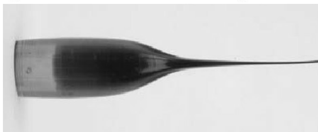
Principupbyggnad av fiber med invändig, dielektrisk spegel (över), samt en förform som delvis har börjat dragas till färdig fiber (under).
