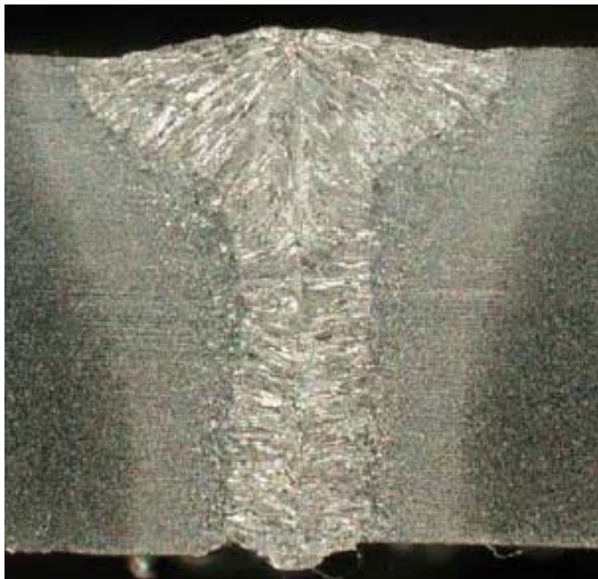
CO 2 -haltens inverkan på svetsbredden vid laserhybridsvetsning; t.v. 0%, t.h. 10% CO 2 -inblandning i den använda skyddsgasen.
