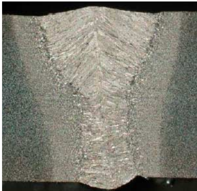
CO 2 -haltens inverkan på svetsbredden vid laserhybridsvetsning; t.v. 0%, t.h. 10% CO 2 -inblandning i den använda skyddsgasen.
