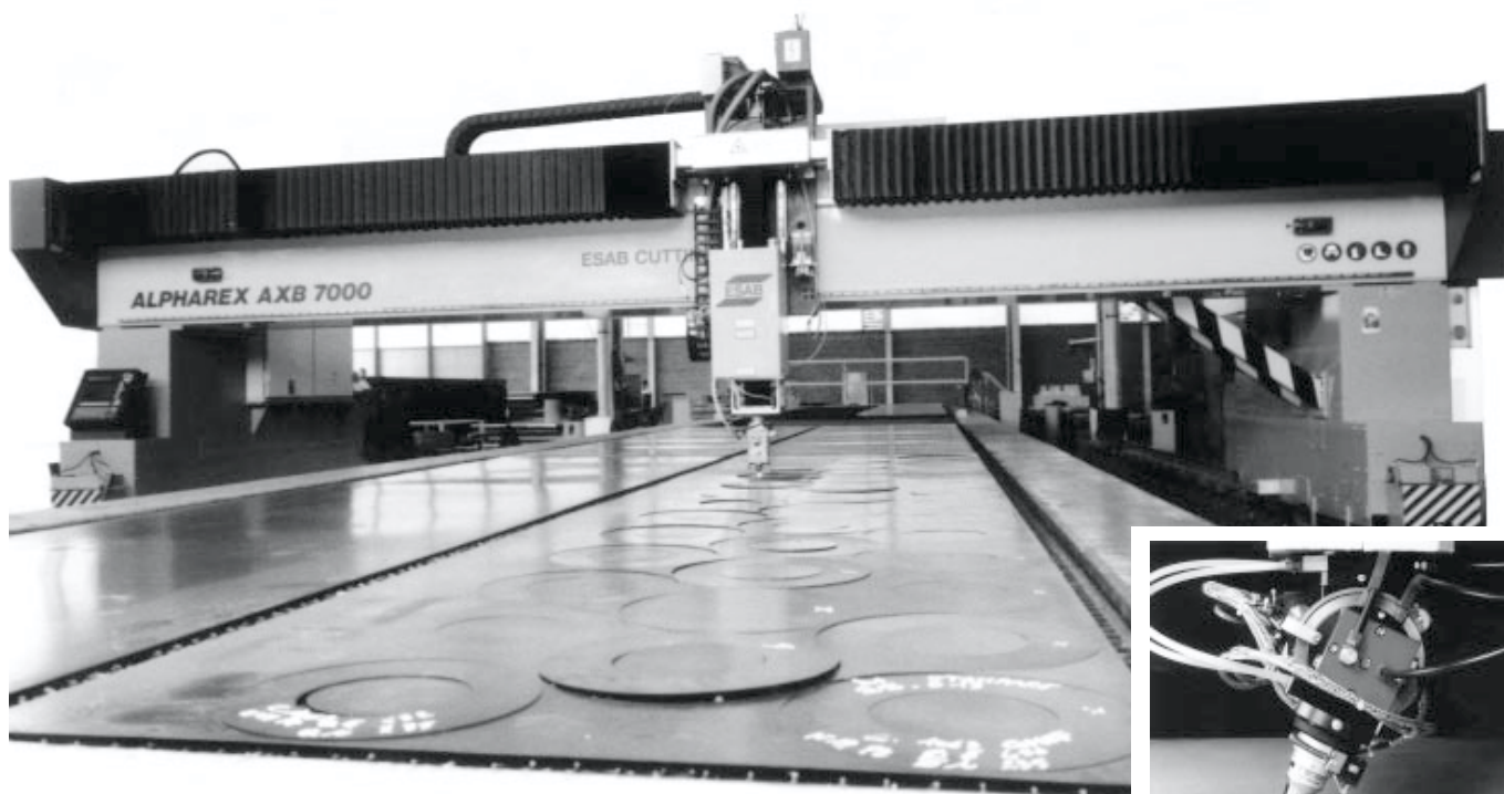
Bild 1. Esab Alpharex är en laserskärmaskin för de stora formaten. Skärning av faser är möjligt med ett fler-axligt skärhuvud.
