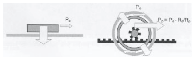
Figur 4. Jämförelse mellan resulterande krafter för linjärmotor och skivmotor med kuggstångsdrivning.
