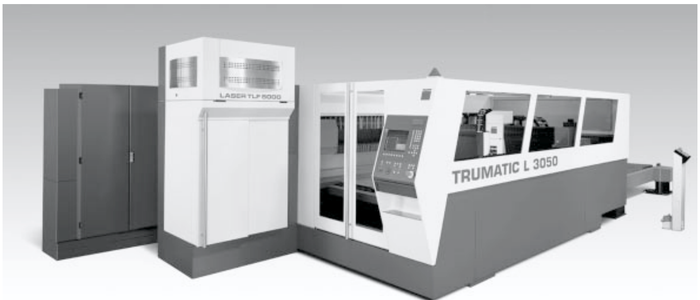
Bild 4. Trumatic L3050 är en ny laserskärmaskin från Trumpf som kombinerar traditionell drivning med linjärmotordrift.
