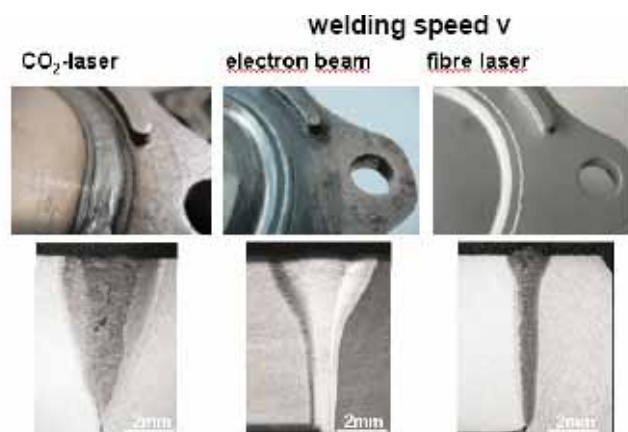
Figur 1. Fiberlaserns exceptionellt goda strålkvalitet slår ut såväl CO 2 -laser som elektronstråle då det gäller penetrationsdjup vid likvärdigt energiinnehåll i strålarna.
