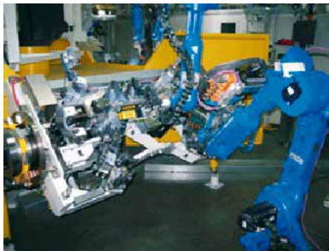
Figur 8. Lasern använd för kvalitetskontroll av smältsvetsar på en krängningshämmare till BMWs 3-serie.
