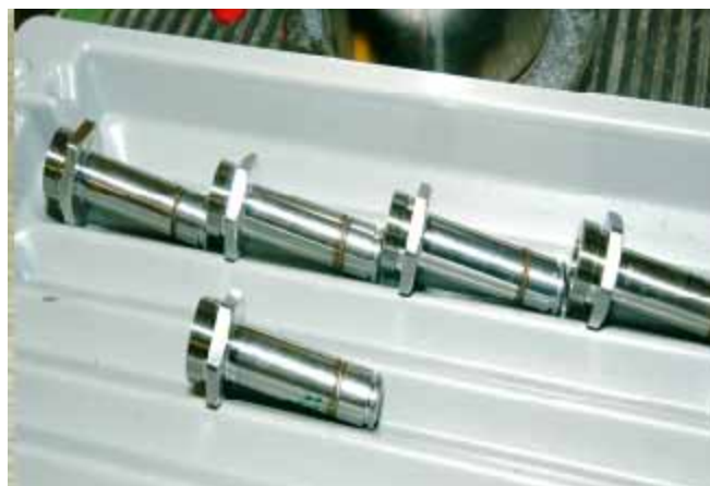
Ankarrör där ferritiskt och austenitiskt rostfritt stål lasersvetsas.
