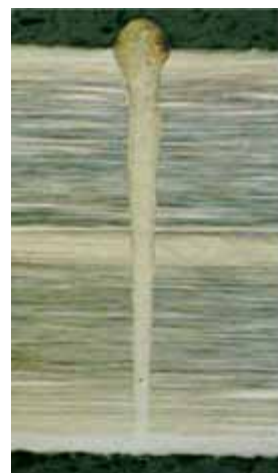
Bild 2: Svetsgeometri i rostfritt stål med fiberlaser (5 kW, BPP 4.5 mm mrad, 100 μm fiber, 4.25 m/min)
