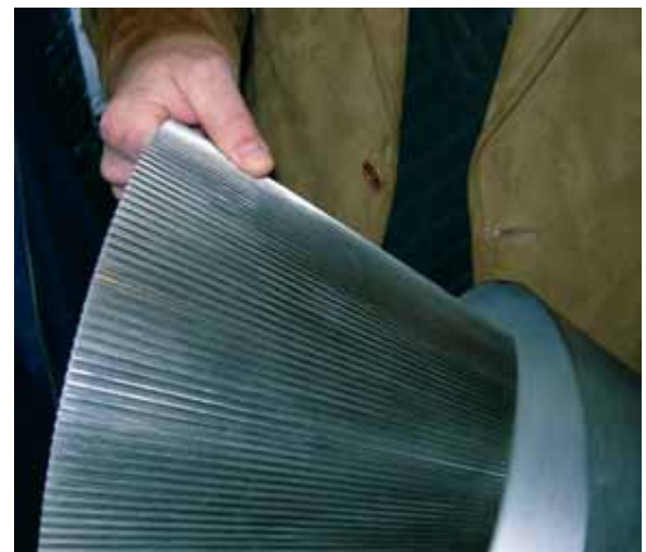
Jakob Nørgaard, FORCE Technology informerade om lasersvetsning av raktetdysor och visar en modell av den dubbelmantlade dysan. I den inre konan han man fräst spår och den ska sedan svetsas till den yttre konan. Det gäller att träffa kammarna i den inre konan där svetsarna är helt dolda. Lösningen är fögföljning med digital röntgenteknik.
