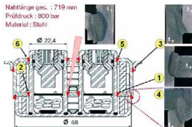
Figur 2. Höga krav föreligger på lasersvetsarna för denna gasgenerator till en airbag.
