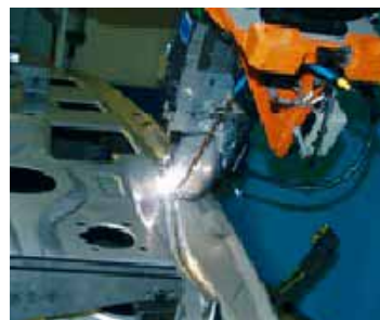
Figur 5. Den numera klassiska lasersvetsningen av aluminiumfrontens mellanbräda på BMW 5-Reihe.
