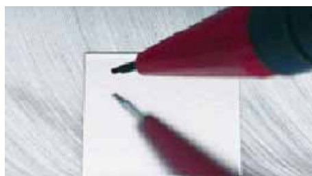
Figur 12. Makro-polering med laser innebär att man omsmälter ett tunt ytskikt och därmed skapar en ytfinhet som överträffar den som man får vid mer konventionella polermetoder.
