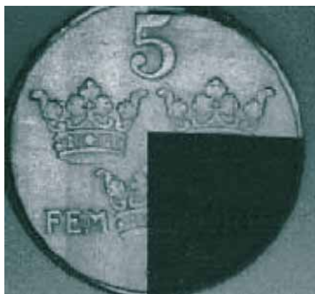
Bild 26: Laserrengöring av oxidskikt på kopparmynt.
