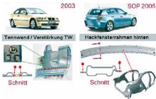
Figur 4. Två intressanta "remote"-applikationer hos BMW; t.v. mellanbrädeförstärkning på BMW 3-seriens tidigare "compact" version och t.h. balk över bakrutan på BMW 3-seriens 5-dörrsvariant.
