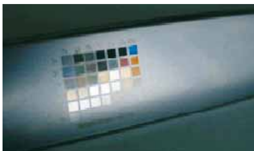
Figur 11. Genom riktad strålningsvärme från en laserkälla kan vissa metallytor, i detta fall Titan, koloreras till önskvärd nyans.
