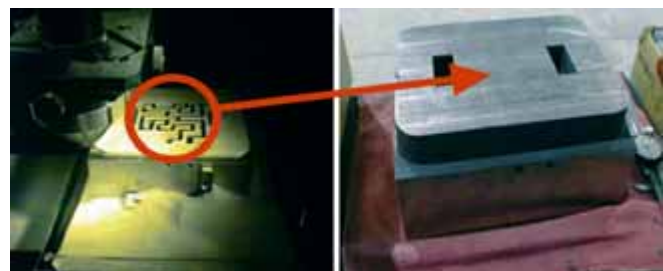
Bild 10: Verktögsstillverkning med LPAW för kylkanaldesign (bild till vänster) i mitten av verktyget (som ses i bilden till höger).
