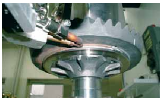
Figur 3. Lasersvetsning med AGAs Lasgon-gas vid tillverkningen av tallriks-hjul för en differentialväxel.
