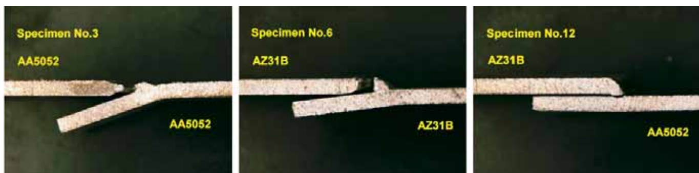
Bild 13: Brottmekanik i lastfallet för tre kombinationer av lättviktsmaterial: (a) Al-Al, (b) Mg-Mg, (c) Mg-Al.
