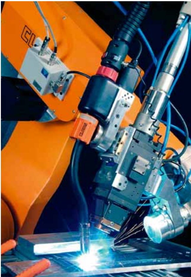
Figur 1. Processövervakning används vid många tillämpningar inom lasersvetsning. Här ett system för övervakning av laserhybridsvetsning.
