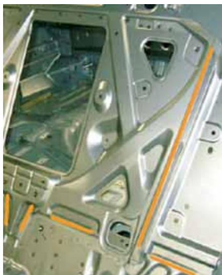
Figur 6. Lasersvetsar i baksätetryggen bidrar till ökad vridstyvhet hos Nissan Skyline-modellen, en konstruktionslösning som vi känner igen från Toyotas presentation vid fjolårets EALA.
