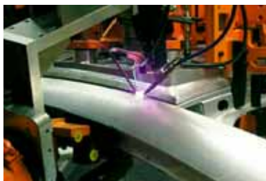
Figur 3. Överst fixeras TT-karossen och under sker taksvetsning med AlSi12-tillsatsstråd och taktill fogföljning.
