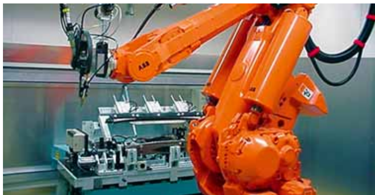
Figur 1. Interiör bild från laserlödcellen i Olofström för tillverkning av den delade ytterpanelen till bakluckan. Längst ner till höger en detalj av den synnerligen högkvalitativa lödfogen.
