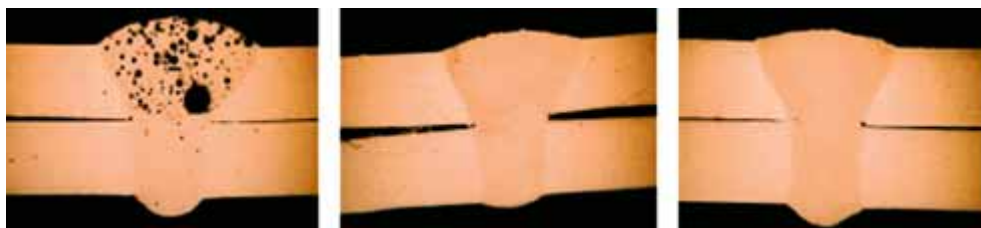
Figur 2. Rengöring av aluminiumytan före lasersvetsning har en signifikant inverkan på svetskvaliteten; Längst t.v. en obehandlad yta, därefter en avfettad och längst t.h. resultatet med LaserClean©.
