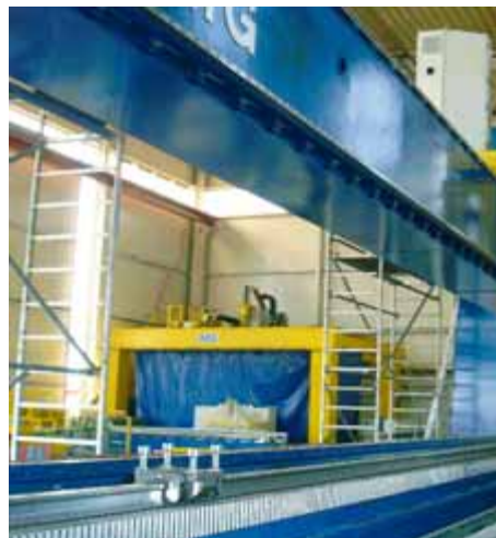
Figur 9. Fiberlaser integrerad i mikropanelenhet för svetsning inom skeppsvarvsindustrin. (med tillstånd från IMG Rostock)
