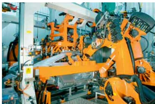
Figur 3. Överst fixeras TT-karossen och under sker taksvetsning med AlSi12-tillsatsstråd och taktill fogföljning.
