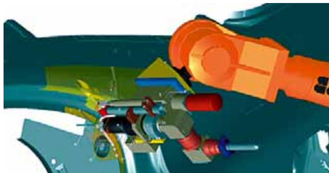
Figur 4. Processimulering för att optimera åtkomsten vid laserskärning av referenshålsplåtar i bakre sidodörrsöppningarna.
