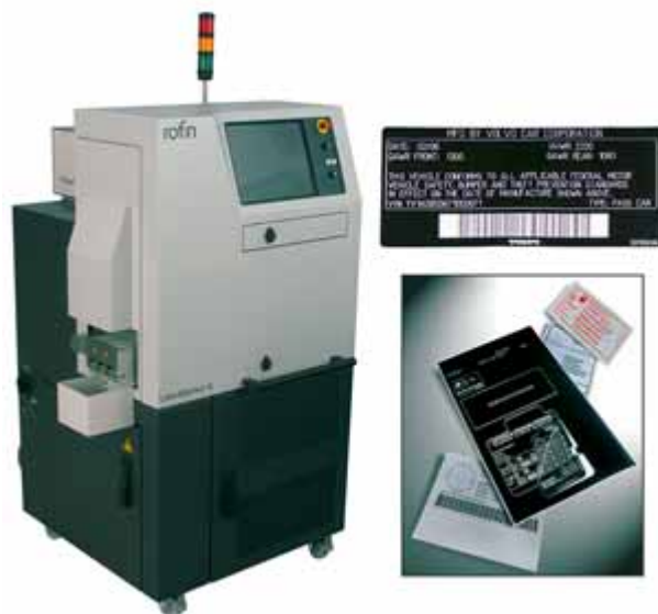
Figur 5. Rofin Sinars märklasar LabelMarker E (t.v.) som används för unik märkning av etiketter i slutmonteringsfabriken. En utmärkt lösning för att sätta stopp för "piratkopiering"!
