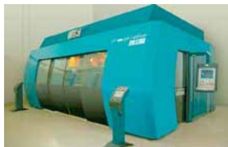
Figur 2. RAPIDO Evoluzione, ny 3D-laserskär-maskin från Prima Industrie.
