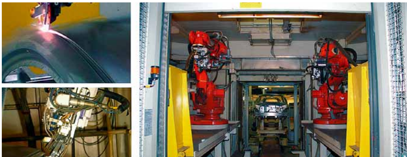
Figur 2. Längst till höger en interiörbild från lasersvetsstationen 55-080 i Torslanda. Ovan till vänster svetsning av tak till karossida med en enkel tryckrulle och därunder svetsning i bakruteöppningen med hjälp av dubbla rullar.
