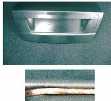
Figur 1. Interiör bild från laserlödcellen i Olofström för tillverkning av den delade ytterpanelen till bakluckan. Längst ner till höger en detalj av den synnerligen högkvalitativa lödfogen.
