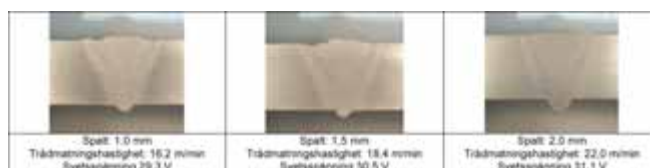
Figur 9. Svetsvärsnittets utseende vid olika spaltstorlek vid stumfogssvetsning.
