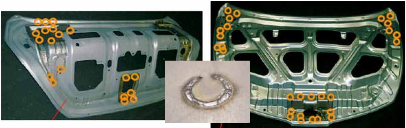
Figur 7. Exempel på "remote"-svetsning av baklucka och motorhuv på Hyundai-modellerna Latio resp. Tiida. Svetsarna utförs mestadels såsom inte helt fullbordade cirklar för att ge bästa hållfasthet.
