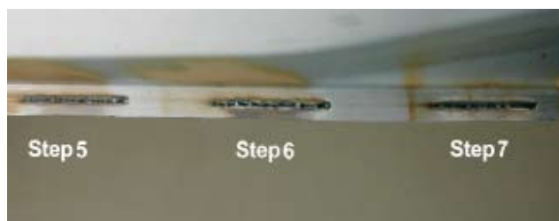
Figur 18. Virvelströmsmätning av svetskvalitén hos lasersvetsar i treplåtsförband. T.v. underkända svetsar och till höger godkända dito.
