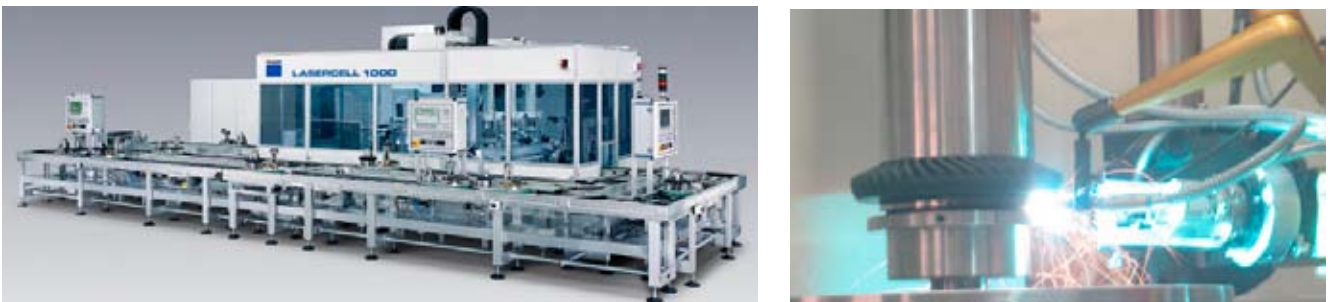
Figur 12. Svetsning av differentialväxlar hos BMW, där man använder tre arbetsstationer och en 5 kW TL5000-laser.
