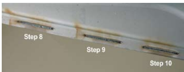
Figur 18. Virvelströmsmätning av svetskvalitén hos lasersvetsar i treplåtsförband. T.v. underkända svetsar och till höger godkända dito.
