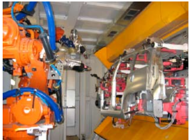
Figur 10. Utvärdering av tekniken med i svetsriktningen oscil- lerande laserstråle, kombinerad med dubbla tryckrullar för fixering av ytter- till innerdetalj, vid lasersvetsför- sök på kompletta karosidor till Peugeot Picasso.
