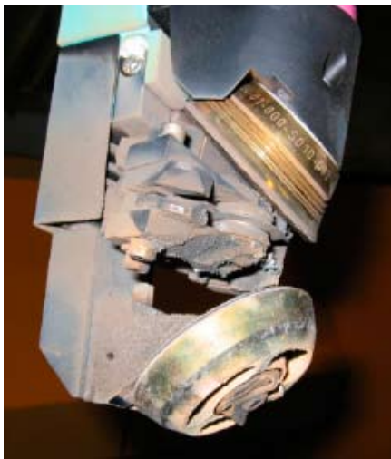
Figur 9. En av de uppen- bara nack- delarna med KruppDrauz' zinkavgasnings- hjul är den höga graden av kon- tamination från svetssprut.
