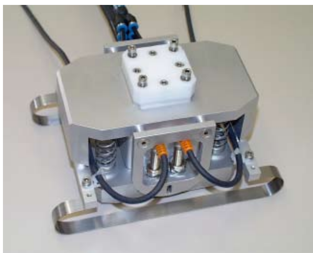
Figur 19. ThyssenKrupps EMUS-verktyg, vars ultraljudssignal t.h. detekterat ett 400 mm långt bindfel i ett skarvat ämne p.g.a. att laserstrålen hamnat 0,25 mm ur position.
