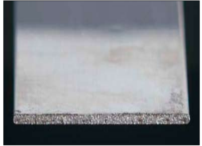
Figur 11. En av "höjdarna" vid årets NOLAMP-konferens: "Remote Laser Cutting" med 200 mm arbetsavstånd. Ovan syns skärsnittet i 0,5 mm tjock rostfri plåt.
