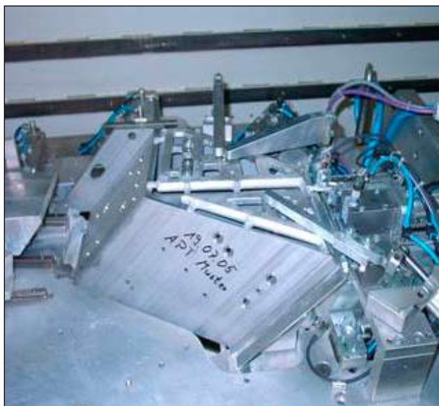
Figur 2. Den vridbara fixtur som används vid lasersvetsningen av torsionsboxen hos det tyska företaget Hago GmbH.
