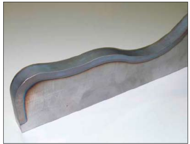
Figur 8. T.v. LASSY-verktyget monterat på en industrirobot tillsammans med det kamerabaserade temperaturövervakningssystemet E-MaqS. Härövan ytutseende och tvärsnitt av simultant härdad skäregg på ett klippverktyg av höglegerat (1.2379) stål.
