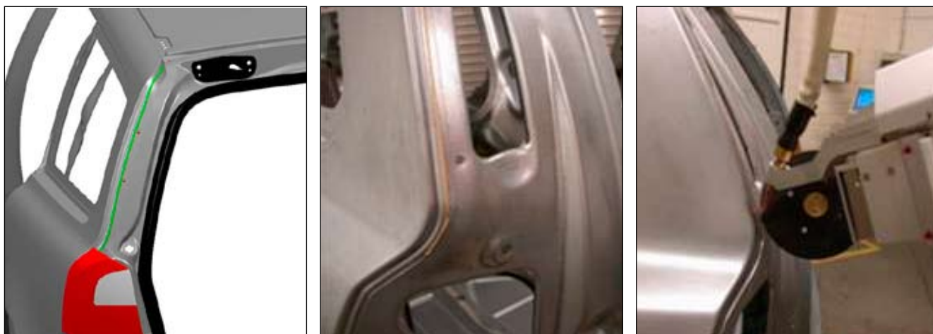
Figur 10. Till vänster lasercellen i Södra fabriken i Olofström där man laserlöder bakluckan till Volvo-modellen S80. Ovan bakluckan med detalj på den högkvalitativa fogen.
