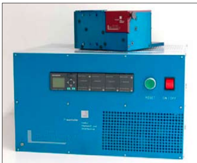
Figur 7. Överst en principskiss över laserstrålens rörelse inuti scanner-optiken LASSY, och under det verkliga verktygen med tillhörande effektförsörjningsenhet.
