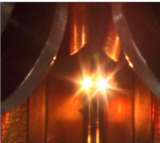
Figur 9. Simultan härdning av en styrskena med hjälp av två diodlasrar med hög effekt. Material: 58CrV4, Hårdhet: 700 HV0.05, Härdjup: 0,9 mm
