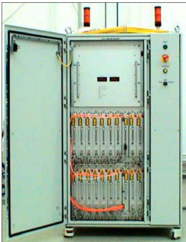
Figur 10. En 10 kW fiberlaser med öppen frontdörr. Energiförsörjning överst och därunder lasermoduler à 400 W, allt på endast 860×800 mm golvyta.
