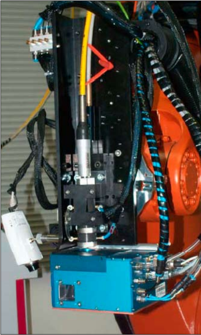
Figur 8. T.v. LASSY-verktyget monterat på en industrirobot tillsammans med det kamerabaserade temperaturövervakningssystemet E-MaqS. Härövan ytutseende och tvärsnitt av simultant härdad skäregg på ett klippverktyg av höglegerat (1.2379) stål.
