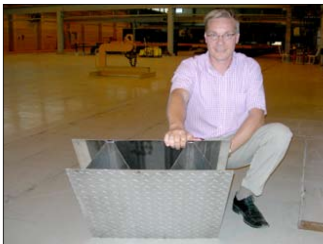
Ilpo Maavanen, vd vid Hybri-Steel Oy visar en lasersvetsad sandwich panel i rostfritt stål. I bakgrunden syns delar av den stora fabrikslokalen.
