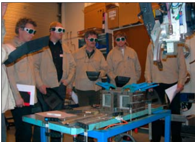
Skyddsglasögon på – ett oomkullrunkeligt krav när man arbetar med fiberlaser och laserhybridsvetsning
