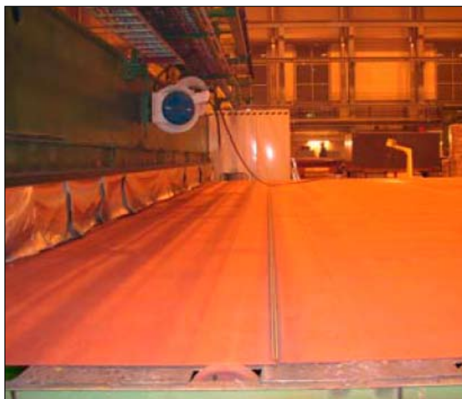
Figur 12. T.v. laserhybridsvetsning med fiberlaser vid paneltillverkning hos Aker Yards. T.h. Mikrotvärsnitt av en hybridkälsvets i 12 mm tjock plåt. Effekt 10 kW, svets hastighet 1,5 m/min.
