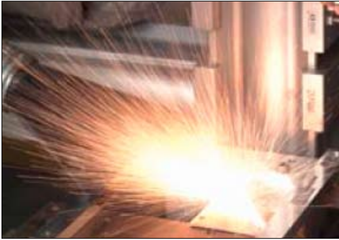
Figur 11. En av "höjdarna" vid årets NOLAMP-konferens: "Remote Laser Cutting" med 200 mm arbetsavstånd. Ovan syns skärsnittet i 0,5 mm tjock rostfri plåt.
