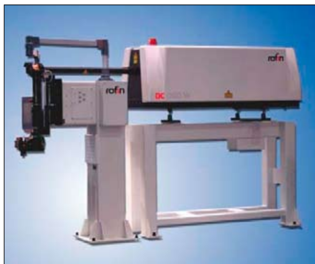
Figur 3. Rofin Sinars profilsvetsningssystem PWS, här avbildat med en 6 kW CO 2 -slablaser som källa.
