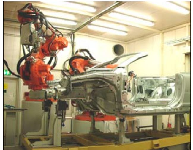
Figur 9. Laser cellen i Volvos Uddevalla-fabrik utrustad med en 4 kW Nd:YAG-laser med fyra fiberutgångar till tre svets- och ett lödverktyg.
