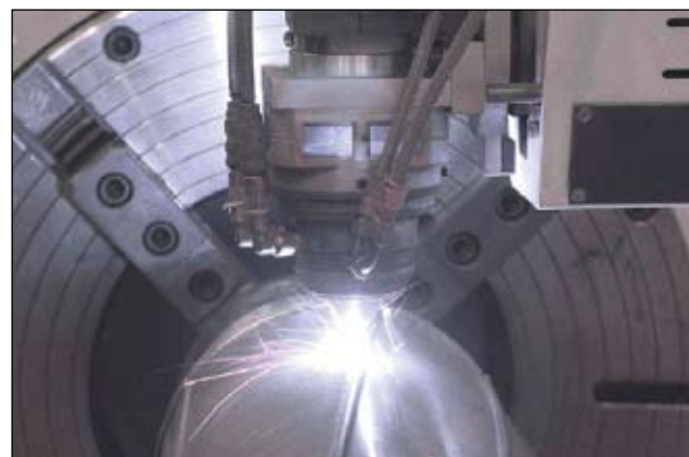
Figur 5. Påläggning av verktygsslititor med hjälp av en fiberkopplad diodlaser.
