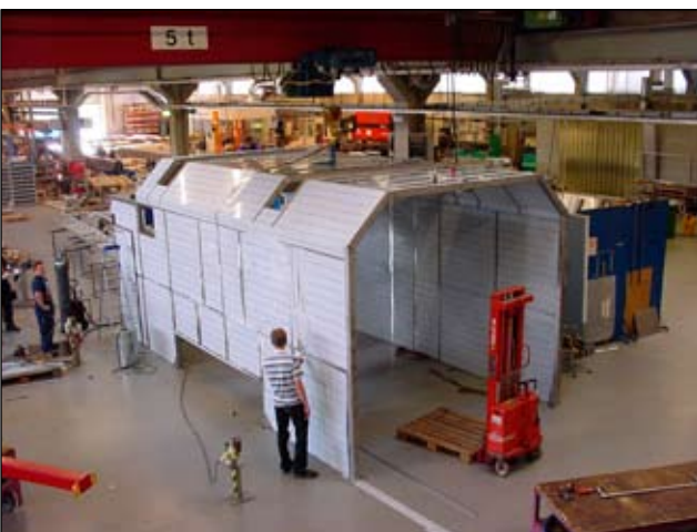
High Metal Production tillverkar olika konstruktioner med hjälp av lasersvetsade sandwich element. Målet är att tillverka lätta konstruktioner som går enkelt att installera.
