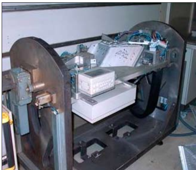
Figur 2. Den vridbara fixtur som används vid lasersvetsningen av torsionsboxen hos det tyska företaget Hago GmbH.
