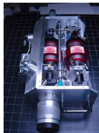
Figur 9. T.v. grundprincipen att vända en återreflekterad laserstråle med linjär polarisation till en cirkulär sådan för att undvika skador på övriga optiska komponenter. Vid en mer ospecificerad polarisation hos den återreflekterade laserstrålen används en uppsättning som den i mitten där strålen bryts i två mot varandra vinkelräta polarisationer och via två Faraday isolatorer och en strålkombinator återkopplas till en utgående laserstråle. T.h. ett verktyg som bygger på den senare principen och som använts vid skärförsök på reflektiva material som koppar och aluminium.
