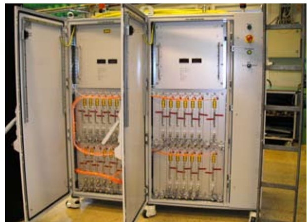
Fiberlasern från IPG Laser GmbH är uppbyggd av många fiberlasermoduler.
