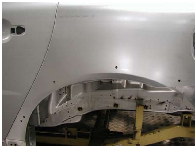
Figur 6. Laserskurna monteringshål i bakskärmen på V70-karossens XC-version för fastsättning av de modellunika skärmbreddarna i plast.
