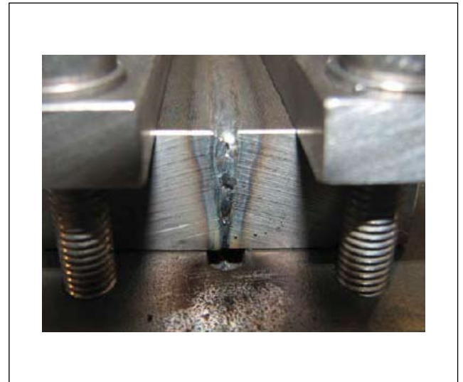
Figur 11. Tvärsnitt genom en lasersvetsad V-fog utförd med oscillerad stråle och lagd i flera strängar.
