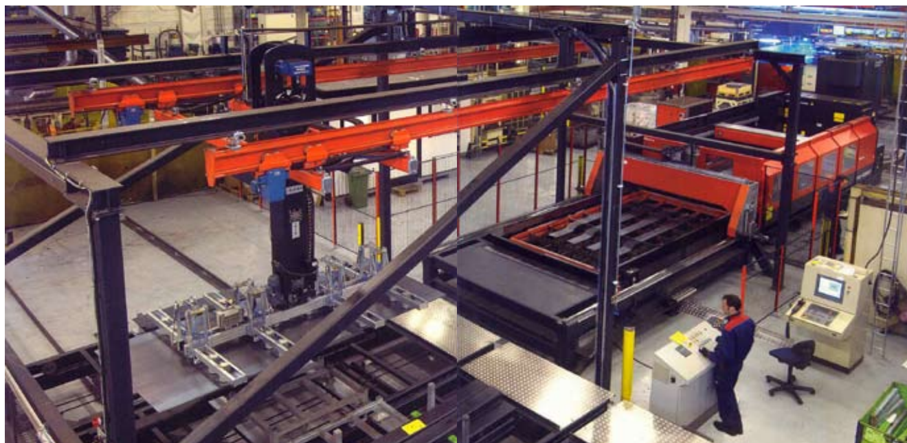
Amada FO 4020 NT lasersystem för samtidig borrar och laserskärning.
