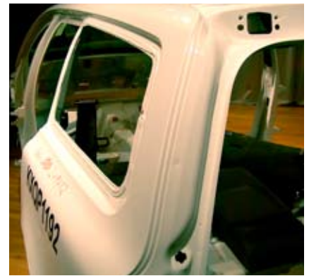
Lödning av "Tail gate" på Volvo V70 t.v. och det färdiga resultatet efter lackering.
