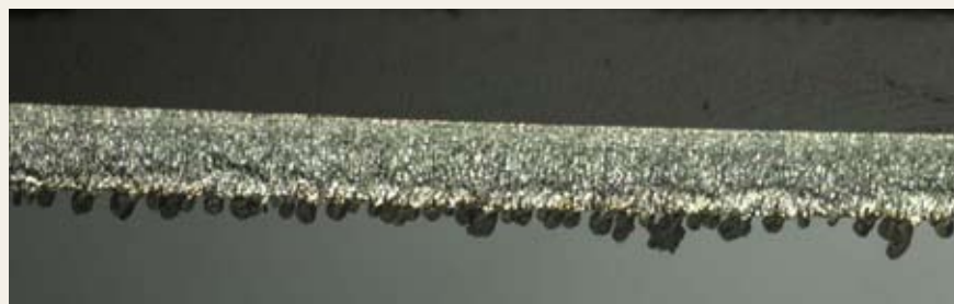
Figur 3 a: Skæring i 2 mm rustfrit stål med én laserstråle, 2,1 meter/minut.
