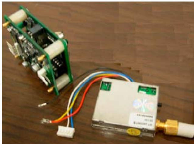
Figur 32. En av CRIF utvecklad sensorenhet för trådlös kommunikation vid t.ex. processövervakning vid lasersvetsning. T.v ses den s.k. "Voltage to Frequency Converter" (VFC) och t.h. en sändarenhet.
