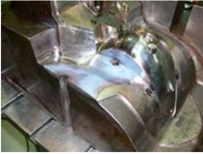
Figur 26. Några exempel på lokal härdning med LASSY®-verktyget: T.v. ett formverktyg för strålkastare och i mitten ett klippverktyg i höglegerat stål 1.2379 med tillhörande tvärsnittsbild t.h.
