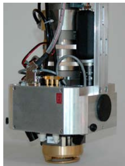
Figur 21. Integrerat laserverktyg med fogföljning, s.k. "Perimetric sensor", utvecklat vid University of Twente.
