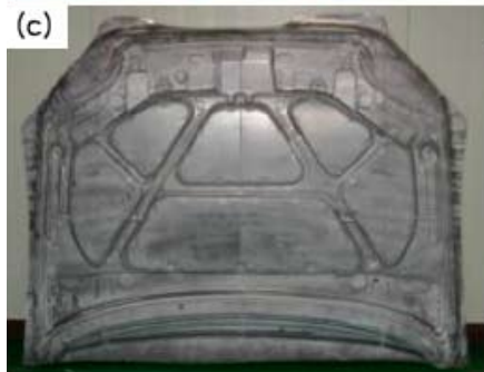
Figur 7. Den tilltänkta ämnesskarv-applikationen i magnesium AZ31, en motorhuv, svetsad utan (a och c) och med (b och d) tillsatsmaterial. Längst t.h. tvärsnitt genom de näst intill porfria svetsarna (utan tillsats ovan och med tillsats underst).
