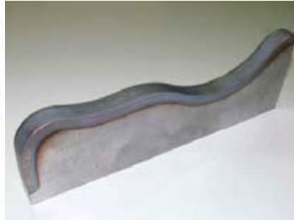
Figur 26. Några exempel på lokal härdning med LASSY®-verktyget: T.v. ett formverktyg för strålkastare och i mitten ett klippverktyg i höglegerat stål 1.2379 med tillhörande tvärsnittsbild t.h.
