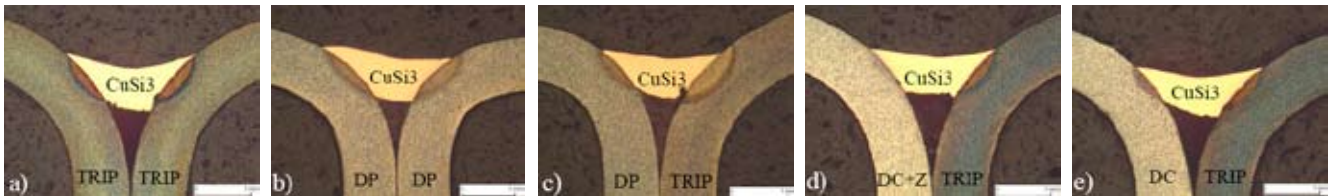
Figur 3. Materialkombinationer laserlödda med en framföringshastighet av 1,8 m/min och en trådmatningsdito på 2,75 m/min. Använd laserenergi var 2,2 kW för kombinationerna a och b, medan blott 2,0 kW använts för övriga.
