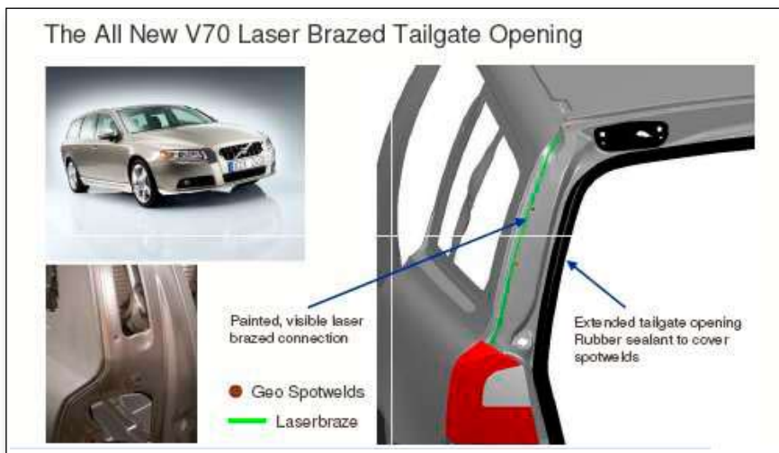
Lödning av "Tail gate" på Volvo V70 t.v. och det färdiga resultatet efter lackering.
