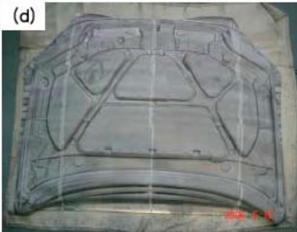
Figur 7. Den tilltänkta ämnesskarv-applikationen i magnesium AZ31, en motorhuv, svetsad utan (a och c) och med (b och d) tillsatsmaterial. Längst t.h. tvärsnitt genom de näst intill porfria svetsarna (utan tillsats ovan och med tillsats underst).
