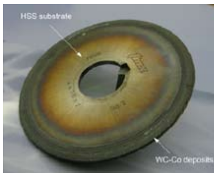
Figur 28. T.v. påläggning av WC-Co som slitmaterial på ett sågblad med hjälp av laserteknik. I mitten sågbladet direkt efter påläggningsoperationen och t.h. i färdigt leveranstillstånd efter slipning.
