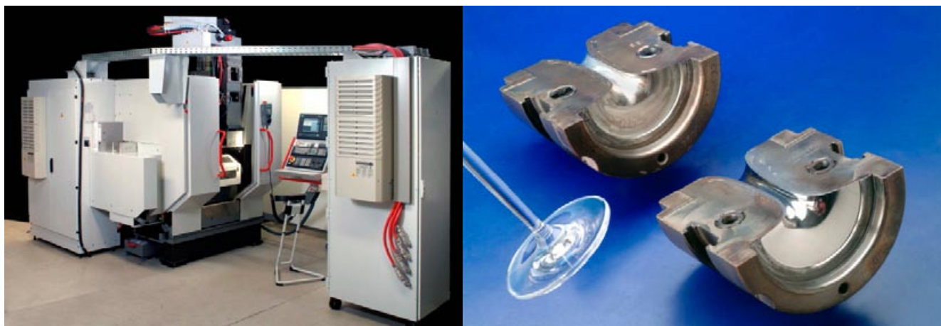
Figur 30. T.v. en maskin för laserpolering utvecklad inom projektet POLAR som kan hantera objekt inom 300×300×200 mm. T.h. laserpolering av formverktyg för tillverkning av glas; Ra = 0,17 µm med en polerhastighet av 25 minuter per verktygshalva.
