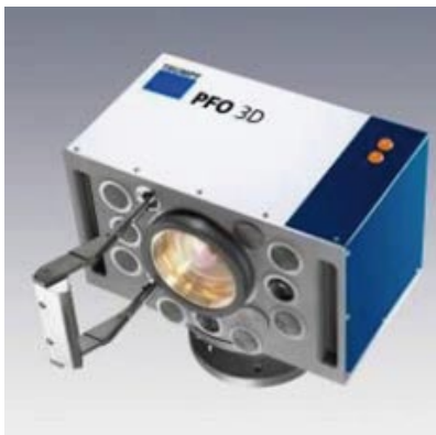
Figur 4. Senaste nytt då det gäller laserverktyg – PFO (Programmable Focussing Optics) 3D. Denna scanner-enhet innehåller utöver de två traditionella galvo-speglarna en funktion som möjliggör automatisk reglering av fokalpunktsavståndet.
