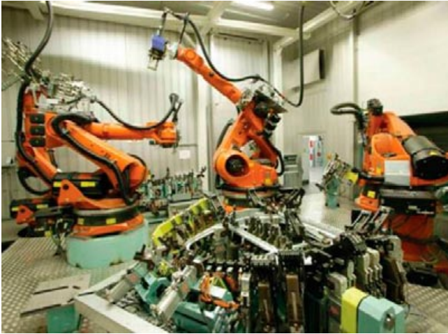
Figur 2. En av produktionscellerna i Bremen Werk för sammansättning av sidodörrarna till Mercedes' C-Klasse-modell med hjälp av RobScan-teknik. 12 stycken disklasrar och lika många scanner-verktyg fördelade på 4 produktionsceller tillverkar 6 olika dörrvarianter med sammanlagt mellan 79-86 svetsar/dörr och en cykeltid på blott 35 sekunder.
