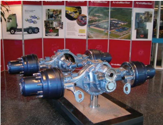
Bakaxlar med tandemdriving är en variant som tillverkas vid Meritor HVS AB i Lindesberg.
