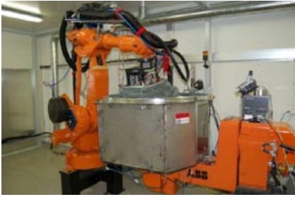
Lasersvetscell vid PTC/HV
