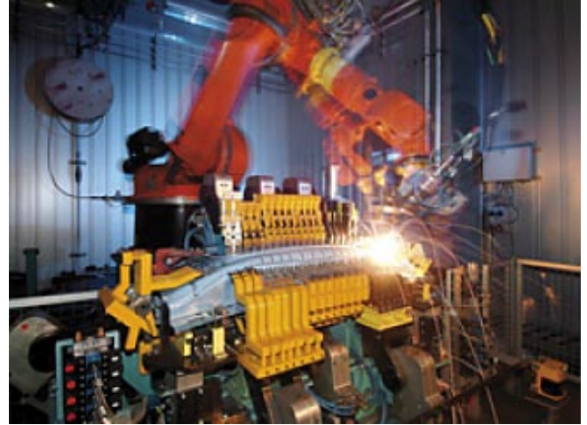
Figur 3. Daimlers allra första RLW-applikation; bakstycket under bagageluckeöppningen, populärt kallat "Heckmittelstück", på Mercedes S-Klasse. Med scanner-teknik sätts 62 stycken lasersvetsar med olika form under 37 sekunder, medan ett motsvarande punktsvetsupplägg skulle innebära en sammanlagd tid för svetsoperationerna på över 2½ minut.
