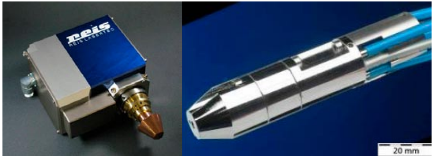
Figur 25. T.v. ett kompakt verktyg avsett för invändig beläggning av rör, och t.h. en zoom-optik som möjliggör variation mellan 0,6-4,0 mm av spårbreddens vid "laser cladding".
