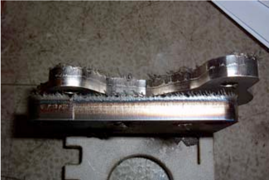
Fig 2. Skärprover. Övre biten är skuren med industrinotrogen. Den undre biten är skuren med nitrogen från en generator med otillräcklig kapacitet.
