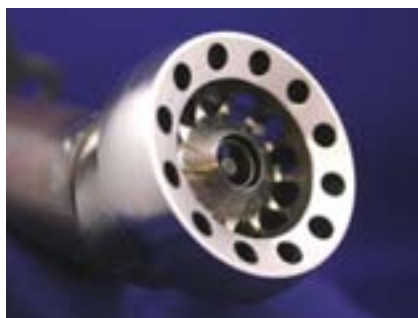
Figur 14. T.v. ett skadat munstycke för bränsleinsprutning i en jetmotor. De övriga bilderna visar samma komponent efter reparation medelst laserpåläggning och efterföljande finishoperationer.
