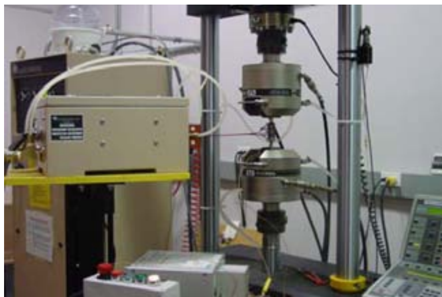
Figur 15. Utrustning för utmattningsprovning under högtemperatur. I detta fall 649° C för att verifiera de reparerade insprutningsmunstyckena under realistiska drifts-förhållanden.
