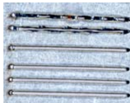
Figur 1. "Remote Laser Cutting" med 4 kW lasereffekt i 0,7 mm tjock elförzinkad stålplåt indikerar problem vid höga skärhastigheter. Nedifrån och upp illustreras resultaten vid skärning med 2, 4, 6, 8, 10 respektive 11 m/min.
