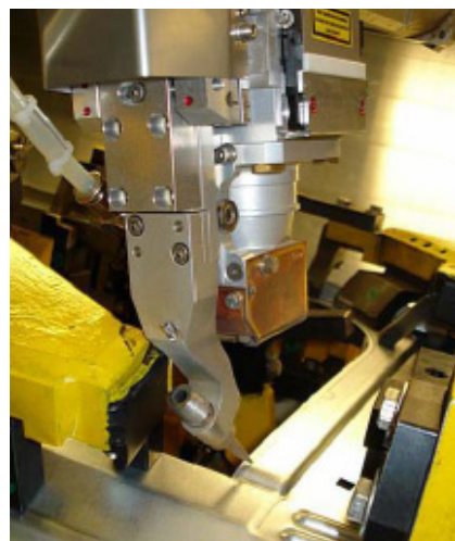
Figur 15. Uppställningar för laserlödning och fjärr-lasersvetsning (närmast) vid Peugeot-Citroëns utvecklingscenter i Vélizy utanför Paris.
