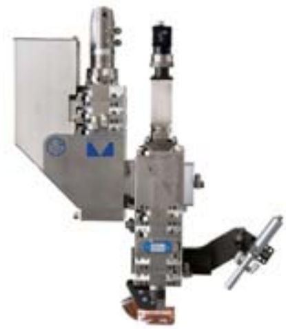
Figur 10. Senaste nytt i laserverktyg från Precitec – den sk ”Wobble Tracker”, vilken kombinerar fogföljning med pendling och därför är ett utmärkt hjälpmedel vid svetsning i komplexa fogbanor med mindre exakt positionering mellan fogytorna.
