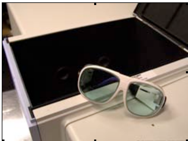
Uppmätningen har utförts i en spektrofotometer, med 20dB dämpning i referensstrålen.
