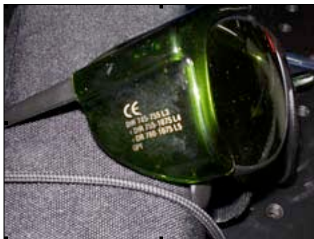
Exempel på CE märkning av glasögon. Glasögonen på bilden har även OD märkning enligt ANSI på vänster skalm.
