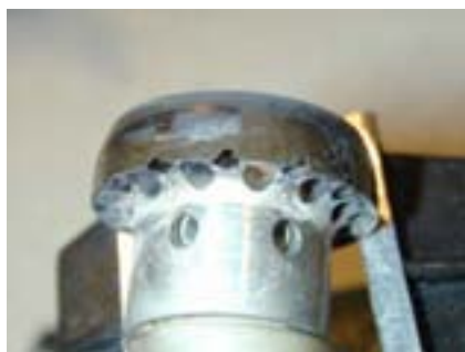
Figur 14. T.v. ett skadat munstycke för bränsleinsprutning i en jetmotor. De övriga bilderna visar samma komponent efter reparation medelst laserpåläggning och efterföljande finishoperationer.
