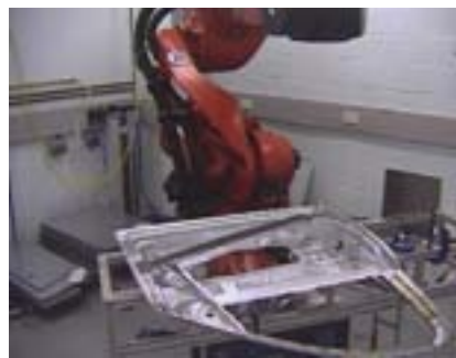
Figur 12. Framgångsrika "scanner"-svetsförsök vid University of Warwick på Jaguar XF:s ståldörrar (t.v.) och de dörrbåglösa aluminiumdörrarna för XJ-varianten (t.h.).
