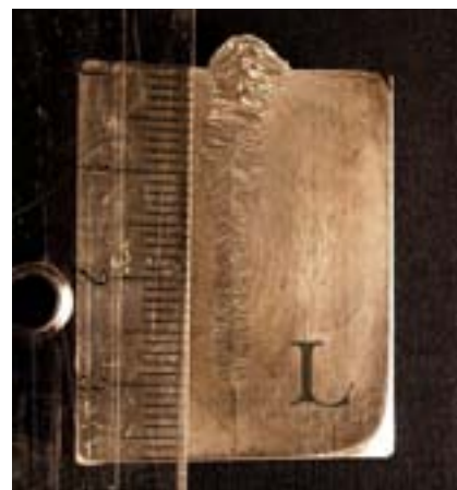
Penetrationstest i rostfritt stål, 15 kW fiberlaser med 300 mm/min svetsningshastighet.
