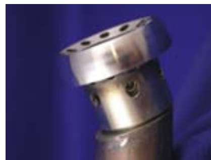
Figur 14. T.v. ett skadat munstycke för bränsleinsprutning i en jetmotor. De övriga bilderna visar samma komponent efter reparation medelst laserpåläggning och efterföljande finishoperationer.
