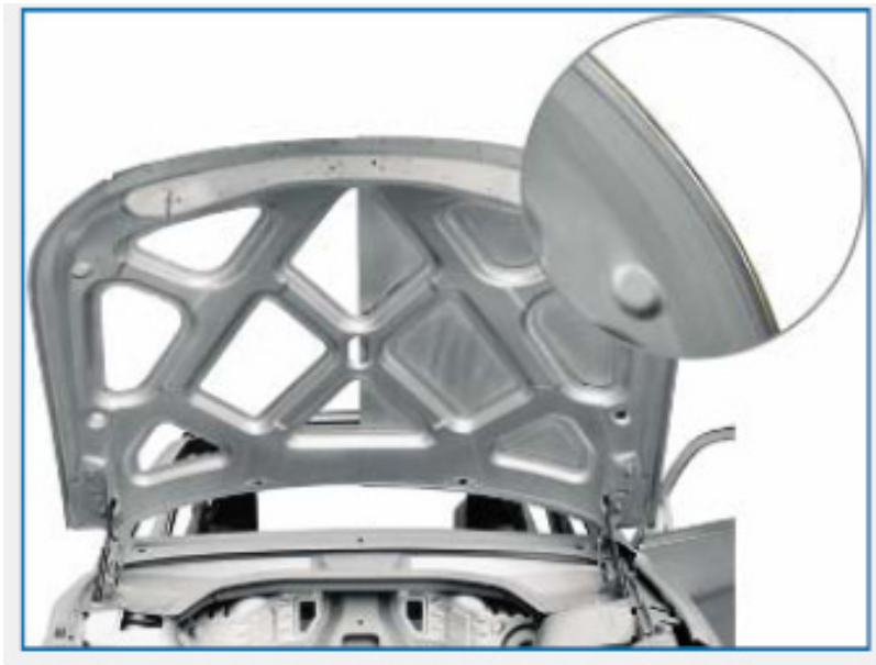
Figur 8. En av många innovativa tekniklösningar i InCar®-projektet; en laserlörd skarv i motorhuven mellan en ytterpanel i laminatplåt och en 180° falsad innerstruktur.
