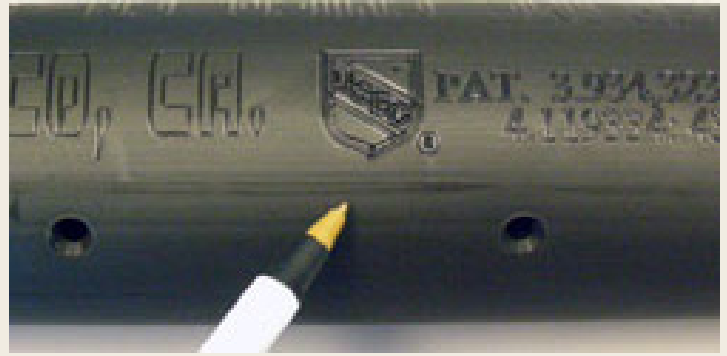
Figur 3. Märkning med god kontrastverkan utörd på ett polypropylenrör med 80 W lasereffekt och en märkningshastighet av 305 mm/s. Märkytan uppgår till 19 × 292 mm och består av 64 tecken plus en detaljerad logotyp allt skapat på strax under 9 sekunder!
