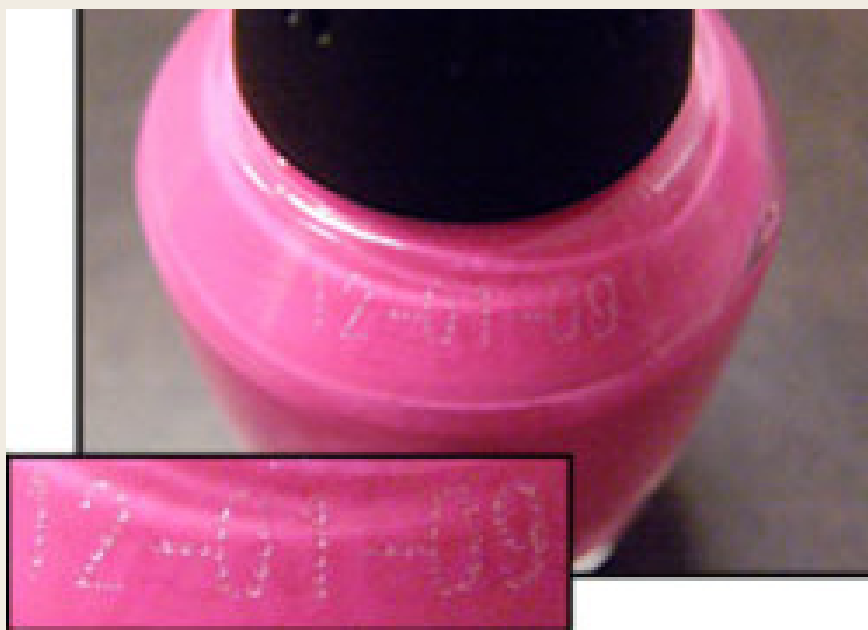
Figur 1. En åttaställig datumkod med 3,8 mm teckenhöjd graverad på en glasflaska för nagellack med hjälp av en 10 W CO 2 -laser. Processhastigheten ligger kring 127 mm/s vilket innebär att det tar 0,34 sekunder att märka en flaska!
