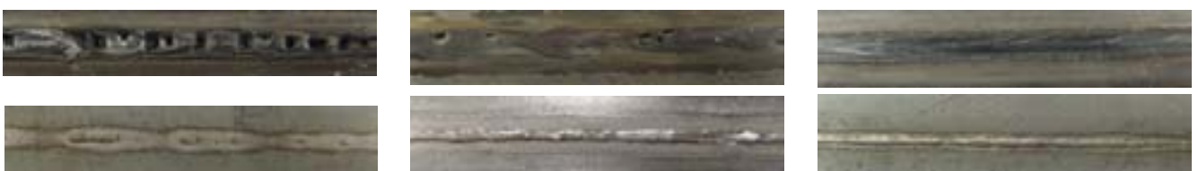
Figur 3. Topp sida (överst) och rotsida (underst) för de olika svetsförfarandena fr.v. ren laser, laserhybrid med en smälta och laserhybrid med två separata svetsmältor.
