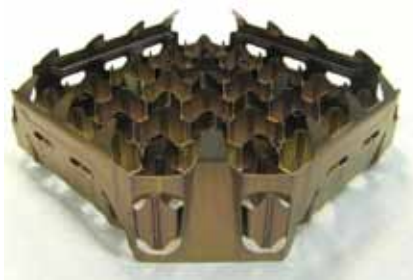
Figur 12. Tunnbränslestavkonstruktionen som håller bränslestavarna på plats, med ett visst individuellt avstånd, lasersvetsas med hjälp av ett dedikerat verktyg.
