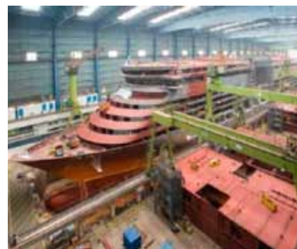
Figur 16. Lasersvetsning på öppna ytor som är fallet vid skeppbyggnad ställer speciella krav på lasersäkerheten! T.h. ses tillverkningen av kryssningsfartyget AIDA Diva vid Meyer Werft i Papenburg, som varit något av en banbrytare för att föra in lasertekniken i varvsbranschen.
