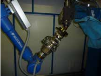
Bild 4. Vid laserpåsvetsning av tätningsytorna till kulventilerna använder man en 3 kW diodlaser från LaserLine med svetshuvud från Precitec KG.
