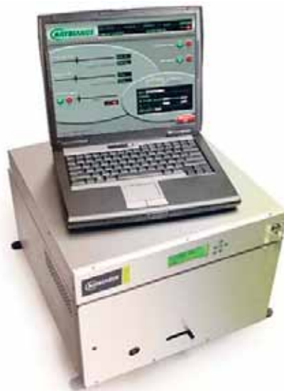
Figur 2. Fascinerande möjligheter erbjuds med femtosecond-teknik; T.v. Radiance's företagslogo ingraverad med hjälp av ablation på en tändsticka, och t.h. det laserskurna fackverksmönstret för så kallade artificiella blodkärl, eller stents, där godstjockleken blott är 20 \mu\text{m} . I mitten Radiance's SmartLight 50, en laser med 1552 nm våglängd, medeleffekt 5 W, topp effekt per puls > 50 MW (!), vilket innebär mellan 5-50 \mu\text{J} pulsenergi.
