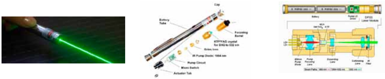
Fig. 17. T.v. en 200 mW laserpekare från företaget ArmLaser.com, och nedan den principiella uppbyggnaden av densamma där man speciellt bör lägga märke till SHG (Second-Harmonic Generation) –elementet som gör det möjligt att genom frekvensdubbling av ljuset från en liten IR-laser skapa grönt ljus med våglängden 532 nm.
