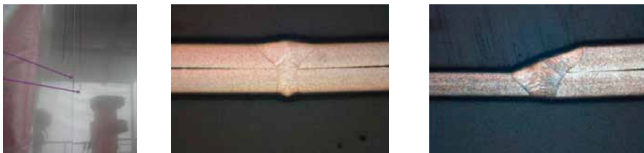
Figur 11. T.v. de parallella lasersvetsar, med ett individuellt avstånd på 3 mm, som sammanbinder två rostfria membran, och därpå tvärsnitt genom desamma varav en är en kälsvets medan den andra är en överlappsfog.
