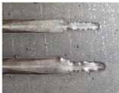
Bild 5. ZnS kan användas som optiskt material för transmissiv optik för 1 µm lasrar. T.v. visas svetslut och t.h. ett svetsvärnsnitt båda utförda med skräddarsydd optik.
