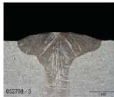
Bild 5. ZnS kan användas som optiskt material för transmissiv optik för 1 µm lasrar. T.v. visas svetslut och t.h. ett svetsvärnsnitt båda utförda med skräddarsydd optik.
