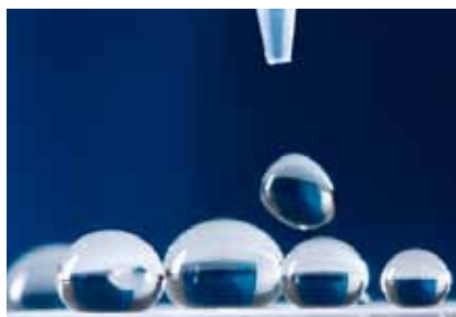
Figur 3. Kortpulstekniken ger möjlighet att konturskära utgångshålen (t.v.) i exempelvis turbinblad för att ytterligare kunna öka kylprestanda, men också för att genom texturering skapa hydrofoba, vattenavvisande ytor (.t.h).
