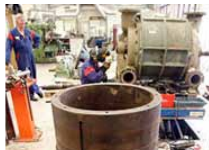
Bild 1. Renovering av sugvalsgavlar genom laserpåsvetsning.
