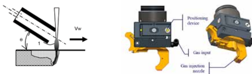
Figur 20. T.v. funktionsprincipen för AirLiquids LASAL Jet Nozzle och t.h. tredimensionella skisser på verktyget.
