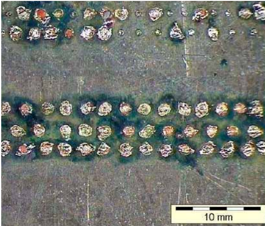
Figur 26. Överst laserpunktsvetsar utförda med enbart 1.064-våglängd, och därunder svetsar utförda med Lasags speciella kombination av infrarött och grönt ljus. Skillnaden i processtabilitet är uppenbar!
