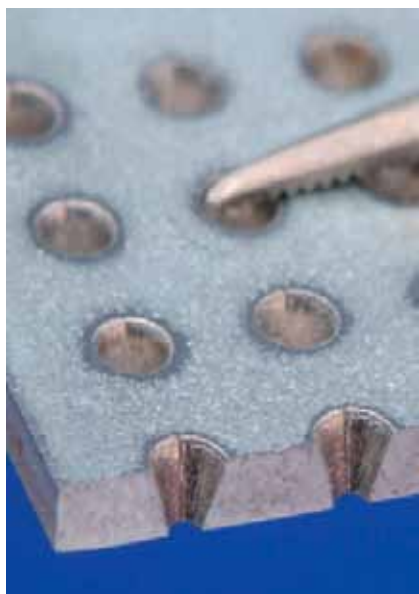
Figur 3. Kortpulstekniken ger möjlighet att konturskära utgångshålen (t.v.) i exempelvis turbinblad för att ytterligare kunna öka kylprestanda, men också för att genom texturering skapa hydrofoba, vattenavvisande ytor (.t.h).
