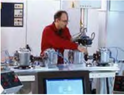
Figur 2. T.v. fixeras tre gjutgodsdetaljer med en vägg tjocklek på 5 mm, vilka sedan stumsvetsas i en dubbelstation med en taktid på blott 4 sekunder.
