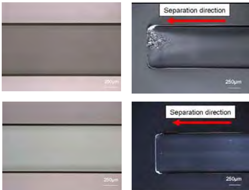
Figur 30. De i säkerhetsglas inbyggda dragspänningarna har betydelse för snittkvaliteten vid separation med hjälp av laser; glaslet överst representerar en spänning på 45 MPa medan det undre endast har 26 MPa.
