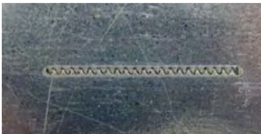
Figur 22. Ovan det typiskt zigzag-formade utseendet hos ett laserstygn applicerat med "Laser Seam Stepper"-metodiken, och t.h. den uppenbara flänsbreddsreduktion som är möjlig i jämförelse med punktsvetsning.
