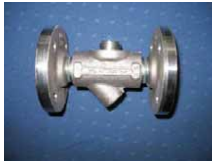
Figur 2. T.v. fixeras tre gjutgodsdetaljer med en vägg tjocklek på 5 mm, vilka sedan stumsvetsas i en dubbelstation med en taktid på blott 4 sekunder.
