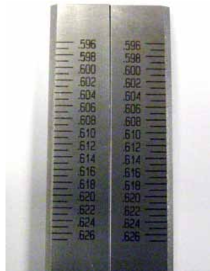
Figur 3. En permanent märkning av dessa rostfria, koniskt utformade måttstockar gjordes med 100 W lasereffekt och en processhastighet på 380 mm/sek. Den högkontrasterande märkningen består av 190 tecken och utfördes på 21 sekunder.
