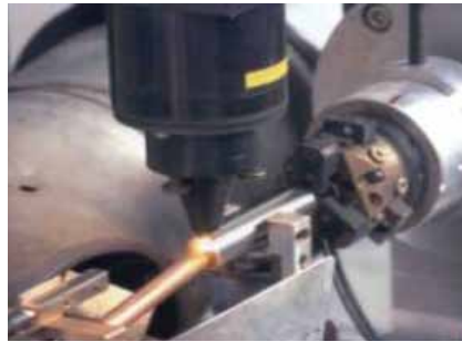
Figur 3. Rörskäring med en "single-mode" fiberlaser på 100 W. Skärlängden per rör uppgår till 50 mm vilket den helautomatiska processen klarar på 2 sekunder.
