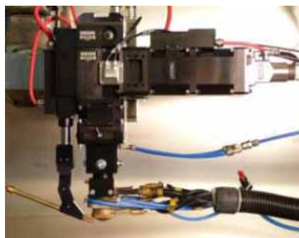
Figur 5. T.v. principen för svetsning av aluminium till stål där en laserstråle kombineras med en plasmabrännare med ringformad elektrod, och t.h. den experimentella uppställningen.
