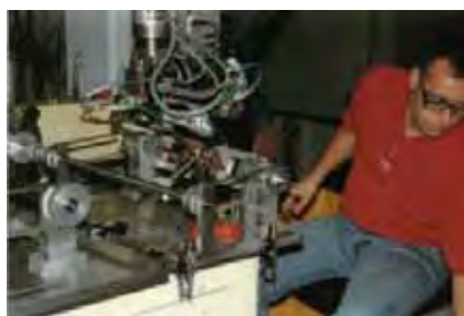
Figur 1. Något spartanska produktionsförhållanden vid Nutech i Neumünster där man bland annat värmeledningssvetsar rostfria dörrhandtag i en dubbelstation med hjälp av en 5 kW CO 2 -laser.
