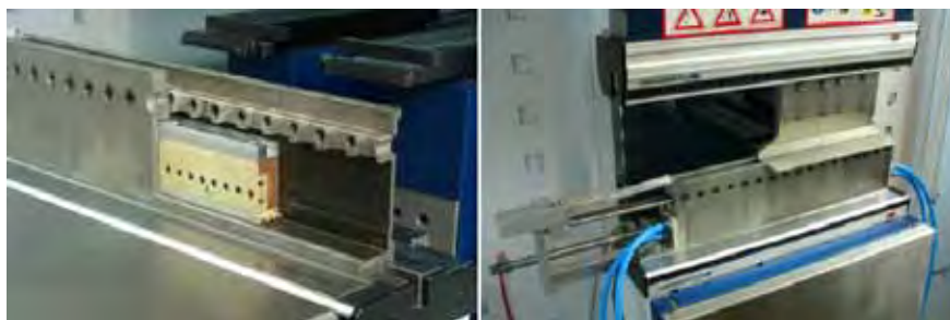
Figur 26a. Laserunderstödd bockning med en diodlasermodul monterad i det undre bockverktyget.
