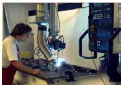
Figur 6. Lasertekniken används för såväl borrning som svetsning av denna komponent i rostfritt 1.4301-material med en vägg tjocklek på 1 mm.
