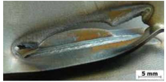
Figur 4. Olika brottmoder vid lasersvetsning av 0,88 mm tunnplåt med olika fokalpunktsdiametrar. En brytpunkt tycks ligga vid 400 \mu\text{m} , där mindre storlekar resulterar i fogytebrott (t.v.), medan större ger fullgoda pluggbrott (t.h.).
