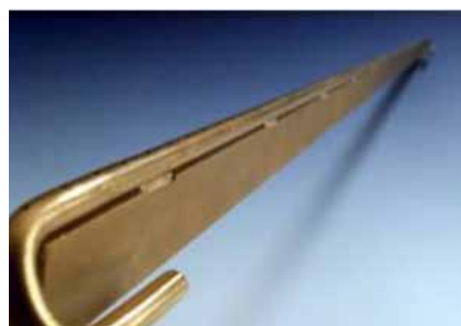
Figur 6. Lasertekniken används för såväl borrning som svetsning av denna komponent i rostfritt 1.4301-material med en vägg tjocklek på 1 mm.
