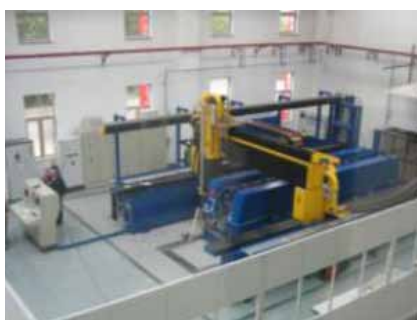
Figur 9. BIAS har lång erfarenhet av laserhybridsvetsning och ovan syns en dylik svets applicerad i en stumfog mellan två 10 mm tjocka A36-plåtar. T.v. hybridsvetscellen i det egna laboratoriet, och t.h. en bild från det tyska PaLas-projektet riktat mot hybridsvetsning med fiberlaser och där en av intressenterna var Meyer-Werft i Papenburg.
