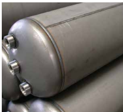
Figur 10. Ovan lasersvetsade tryckbehållare hos Weil Engineering i Müllheim, och t.h. de ingående komponenterna: mantel, gavlar och muffar.
