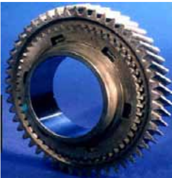
Figur 16. Ett kuggdrev till en växellåda som dels svetsats med 2,2 kW från en diffusionskyld DC025-laser (t.v.) respektive 1,6 kW från en FL020-fiberlaser (t.h.). Den senare resulterar i såväl något bättre penetration 3,5 jmf. 3,4 mm, som högre framföringshastighet; 2,5 jmf. 2,25 m/min.
