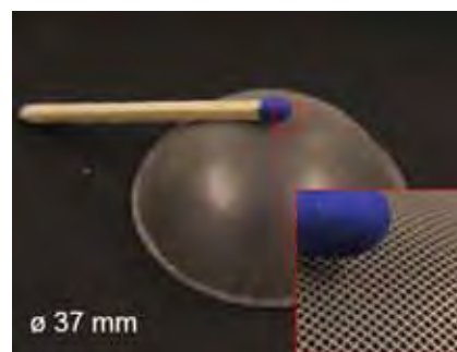
Figur 10. Strukturering och djupdragning av nätkalotter till elektronikindustrin kan med fördel utföras med laserteknik.
