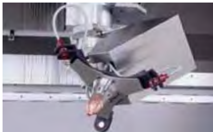
Fig. 19. Det av Trumpf framtagna specialmunstycket för laserpåläggning med inte mindre än tre separata gasflöden; ett för skyddsgas, ett för pulvertransport och ett för formning av pulvertillförslan.
