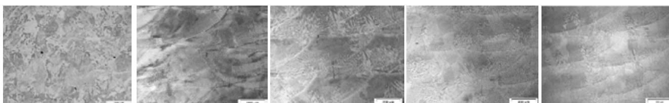
Figur 18. "Skräddarsydda" påläggningslager med olika blandningsförhållanden mellan pulver av det värmebeständiga stålet "Marlok" och den koboltbaserade legeringen Stellite31 resulterar i en varierande hårdhet, vilket också framgår av diagrammet t.v.
