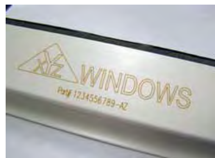
Figur 1. Denna mycket tydliga logotyp med tillhörande artikelnummer på en fönsterram av vinyl märktes med en 25 W CO 2 -laser och ett dedikerat märkverktyg.
