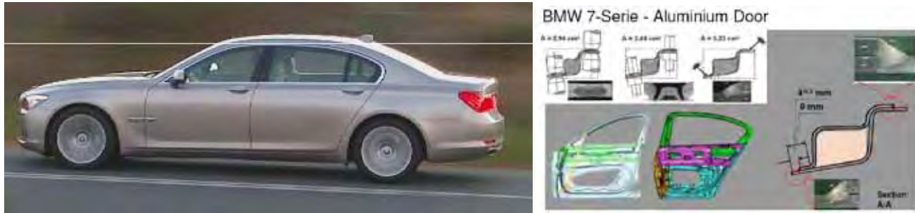
Bild 9. Tvärsnittsarean i en dörrprofil hos BMW 7-serie har nästan kunnat fördubblats tack vare lasersvetsning.
