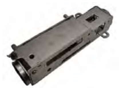
Figur 13. Den numera "världsberömda" "Spannkassetten" t.h., vilken möjliggör att de tio detaljer som ingår i rattstängslösningen t.v. kan sammansvetsas med "remote"-teknik på endast 12 sekunder.
