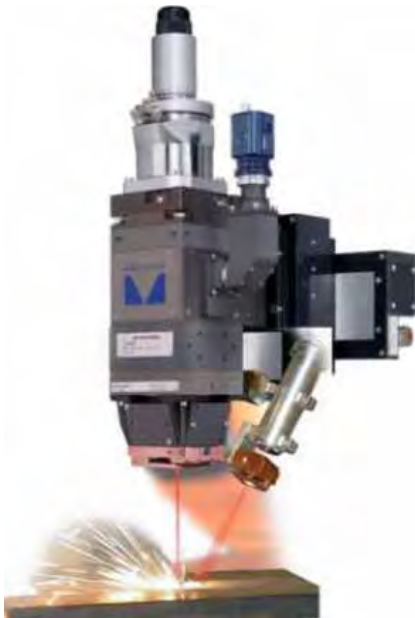
Figur 19. Precitecs nya fogföljningsverktyg LPF med en extern linjeprojektion för bestämning av fogens läge och med en koaxial kameraövervakning. Via en "scanner"-spegel kan fokuspunktens läge gentemot fogen justeras, men denna funktion kan även användas för "wobbling" av laserstrålen om man behöver överbrygga större gap vid stumfogs-svetsning.
