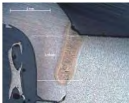
Figur 5. Vid stumsvetsning av tandade kuggdrev används en 3 kW Nd:YAG-laser. Under produktionen sker löpande stickprovsuttag för att validera såväl geometri som att ett insvetsdjup på minst 2 mm uppfylls (t.h.).
