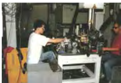
Figur 1. Något spartanska produktionsförhållanden vid Nutech i Neumünster där man bland annat värmeledningssvetsar rostfria dörrhandtag i en dubbelstation med hjälp av en 5 kW CO 2 -laser.
