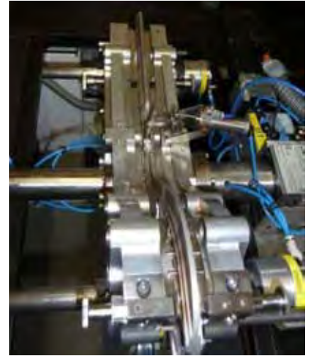
[Fig. 11]. Tidigare svetsades gavlarna som överlappsfogar med MAG [Metal Active Gas] -metoden, men genom att gå över till en lösning som innebär stumsvetsning med laser har man både kunnat reducera vikten hos komponenten och förbättrat svetskvaliteten med reducerad kassationsprocent som resultat. Muffarna pressas på plats i förstansade hål och lasersvetsas sedan med hjälp av en rotationsoptik.
