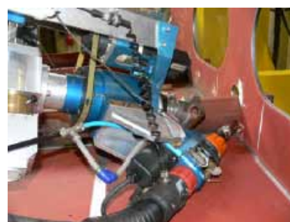
Figur 9. BIAS har lång erfarenhet av laserhybridsvetsning och ovan syns en dylik svets applicerad i en stumfog mellan två 10 mm tjocka A36-plåtar. T.v. hybridsvetscellen i det egna laboratoriet, och t.h. en bild från det tyska PaLas-projektet riktat mot hybridsvetsning med fiberlaser och där en av intressenterna var Meyer-Werft i Papenburg.
