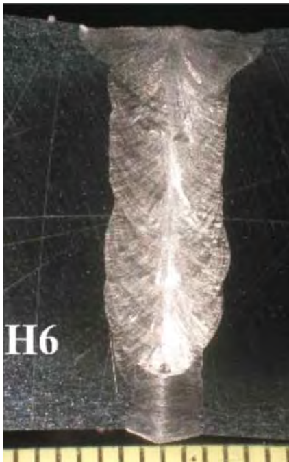
Fig. 11: Laserhybridsvetsade rotpass och 6 laserstabiliserade ljusbåglager
