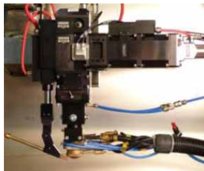
Figur 20. T.v. principen för svetsning av aluminium till stål där en laserstråle kombineras med en plasmabrännare med ringformad elektrod, och t.h. den experimentella uppställningen.
