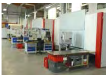
Figur 7. Några av laserutrustningarna hos BBW Lasertechnik. T.v. en skärcell vilken kan förses med laserenergi från såväl en Nd:YAG- som en 500W "single-mode"-fiberlaser, och t.h. en annan skärstation betjänad av en 1kW SM-fiberlaser och med en maximal skärlängd på 3,5 meter.
