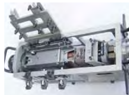
Figur 13. Den numera "världsberömda" "Spannkassetten" t.h., vilken möjliggör att de tio detaljer som ingår i rattstängslösningen t.v. kan sammansvetsas med "remote"-teknik på endast 12 sekunder.
