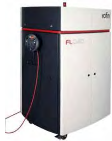
Figur 15. RoFinSinar har numera såväl "single"- som "multi-mode" fiberlasrar i sitt produktprogram. De senare byggs upp av diodmoduler på 130 W (t.v.) och ovan ses en FL040 med 4 kW lasereffekt och längst t.h. en kompaktversion (FL010C) av en 1 kW-enhet.
