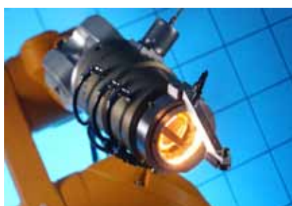
Figur 17. Principen för laserhybridsvetsning med halogenlampor, och t.h. ett integrerat processverktyg med tryckfinger från företaget TwinWeld3D.
