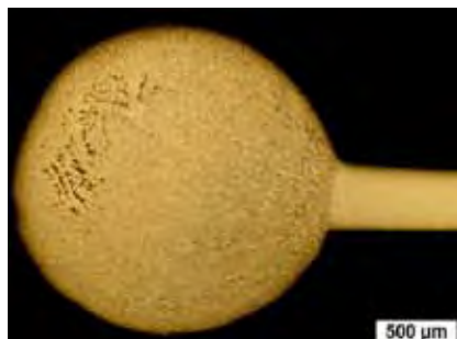
Figur 24. Detaljfoto och tvärsnitt av ovanstående formning av rostfria stavar där lasertekniken möjliggör ett L/d-förhållande på 45.
