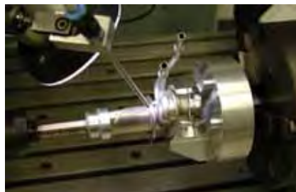
Figur 9. En av många produkter konstruerade för lasersvetsning som tillverkas hos BBW Lasertechnik är denna "avgasledare". Komponenten består av 11 detaljer, och med olika fixturkoncept kan en max. spalt på 0,1 mm säkerställas inför lasersvetsningen. Två av dessa fixturer ses ovan; t.v. den för kylröret och t.h. den för en oval hylsa.
