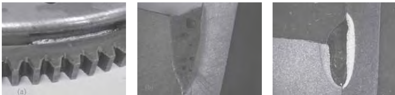
Figur 1. Vid autonom lasersvetsning av nidtridbelagda komponenter kan den visuella delen av svetsen se nog så bra ut, men ett tvärsnitt genom densamma avslöjar en ansamling av stora gasinneslutningar (mitten). Detta kan motverkas om man använder en Titan-pulverfylld tillsatsstråd.
