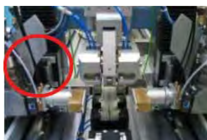
Figur 6. Ovan beskrivs schematiskt hur man på BIAS fogar samman aluminium med titan, där två motstående laserstrålar smälter ner aluminiumet och låter det väta mot titanytorna i denna typ av stumfog. Ovan t.v. ses slutresultatet och t.h. den försöksuppställning som använts. Inringad är en sensor som övervakar laserprocessen, men också eventuella formförändringar hos de sammansvetsade delarna.
