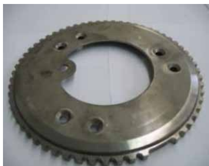
Figur 5. Vid stumsvetsning av tandade kuggdrev används en 3 kW Nd:YAG-laser. Under produktionen sker löpande stickprovsuttag för att validera såväl geometri som att ett insvetsdjup på minst 2 mm uppfylls (t.h.).
