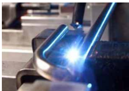
Figur 6. Lasertekniken används för såväl borrning som svetsning av denna komponent i rostfritt 1.4301-material med en vägg tjocklek på 1 mm.
