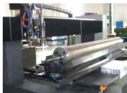
Figur 7. Några av laserutrustningarna hos BBW Lasertechnik. T.v. en skärcell vilken kan förses med laserenergi från såväl en Nd:YAG- som en 500W "single-mode"-fiberlaser, och t.h. en annan skärstation betjänad av en 1kW SM-fiberlaser och med en maximal skärlängd på 3,5 meter.
