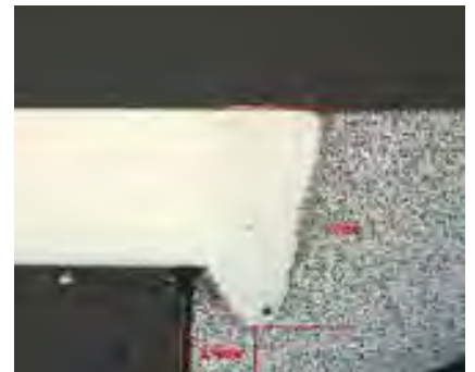
Figur 4. T.v. den fixtur som används vid lasersvetsning av svängningsdämpare för att innehålla toleranskraven på mellan 0,1-0,2 mm. Gråjärn svetsas till en CrNi-legering med 3,6 kW effekt och ett inbränningsdjup (t.h.) på 2 mm.
