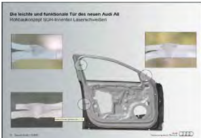
Bild 10. Exempel på lasersvetsning av (inner)dörrar i aluminium hos Audi A8.
