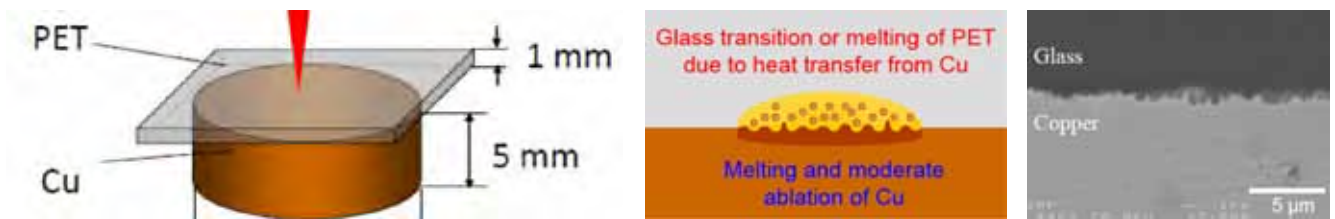
Fig. 10: (a) fs-laserpulssvetsning av Cu med PET, (b) svetsmekanism, (c) mikroskopbild av gränsskiktet
