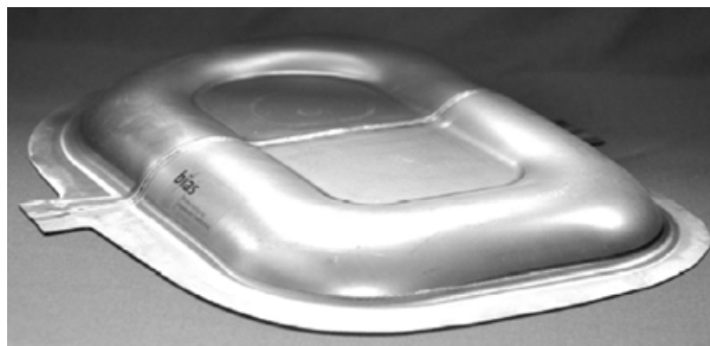
Fig. 3: (a) Laserhybridsvetsning av aluminium med stål, (b) förstörd svetsning efter plåtformning
