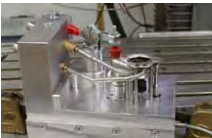
Figur 9. En av många produkter konstruerade för lasersvetsning som tillverkas hos BBW Lasertechnik är denna "avgasledare". Komponenten består av 11 detaljer, och med olika fixturkoncept kan en max. spalt på 0,1 mm säkerställas inför lasersvetsningen. Två av dessa fixturer ses ovan; t.v. den för kylröret och t.h. den för en oval hylsa.
