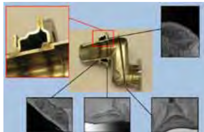
Figur 8. En matarkanal för kablar som byggs upp av 13 stycken laserskurna detaljer som sedan sammanfogas med laser-svetsning i olika fixturer, varav den för täckplåtssvetsningen ses t.h.
