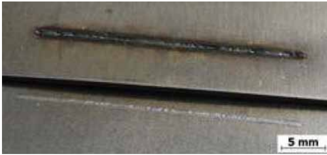
Figur 4. Olika brottmoder vid lasersvetsning av 0,88 mm tunnplåt med olika fokalpunktsdiametrar. En brytpunkt tycks ligga vid 400 \mu\text{m} , där mindre storlekar resulterar i fogytebrott (t.v.), medan större ger fullgoda pluggbrott (t.h.).
