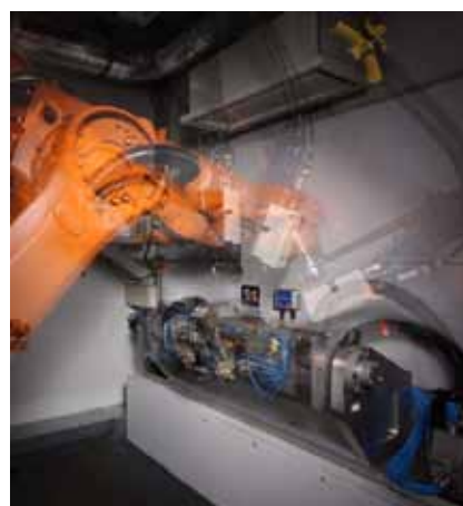
Figur 12. Närmast interiör från laserbearbetningscellen ERLASER® ROTATION100 utrustad med robot och lägesomställare, och längst t.h. växelbordet i processupplägget där en CCD-kamera övervakar att detaljerna läggs på korrekt sätt i fixturen.
