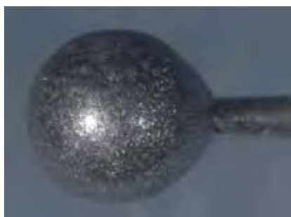
Figur 24. Detaljfoto och tvärsnitt av ovanstående formning av rostfria stavar där lasertekniken möjliggör ett L/d-förhållande på 45.
