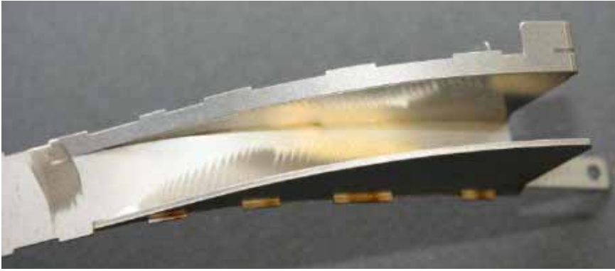
Figur 8. En matarkanal för kablar som byggs upp av 13 stycken laserskurna detaljer som sedan sammanfogas med laser-svetsning i olika fixturer, varav den för täckplåtssvetsningen ses t.h.
