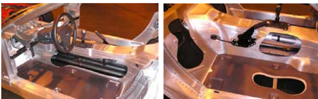
Figur 5. Karosstrukturen i aluminium för nischmodellen Chevrolet Corvette Z06 innehåller en stor mängd stansnitar, men också hela 14 meter lasersvets.
