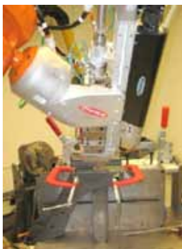
Figur 13. T.v. ett laserhybridverktyg utvecklat av Fronius och med optik från Precitec. Med 3,5 kW lasereffekt sammansvetsas 6 mm tjockt kolstål med en hastighet på 2,5 m/min. T.h. en prototypcell från Lincoln Electric för hybridsvetsning med en 10 kW fiberlaser.
