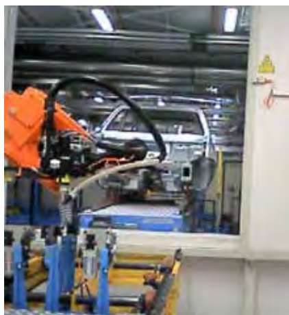
Figur 3. Totalt 36 monteringshål skärs i karosidorna på Fusion UAV-modellen, där skärverktyget manipuleras av Comaus s.k. SmartRobot med en optisk fiber integrerad i robotarmen.
