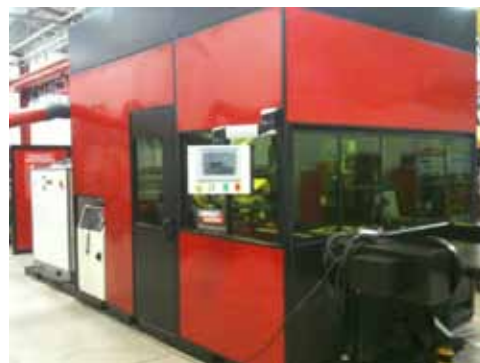
Figur 13. T.v. ett laserhybridverktyg utvecklat av Fronius och med optik från Precitec. Med 3,5 kW lasereffekt sammansvetsas 6 mm tjockt kolstål med en hastighet på 2,5 m/min. T.h. en prototypcell från Lincoln Electric för hybridsvetsning med en 10 kW fiberlaser.
