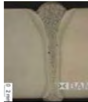
Figur 8. BIMO-verktyget kan kombineras med en endimensionell linje-scanner vilken använts vid lasersvetsning av pipelines t.v. Med en spalt på 0,5 mm ses resultaten utan inkopplad scanner-funktion närmast, att jämföras med en 0,7 mm stor pendling med 200 Hz frekvens t.h.
