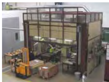
Figur 2. Olika utrustningar för laserpåläggning hos Sulzer Innotec; Längst t.v. en station baserad på en 2 kW CO 2 -laser och därefter mobila enheter med en 1,5 kW fiber- resp. en 150 W Nd:YAG-laser.
