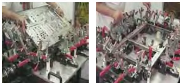
Figur 9. Fixering inför fjärrlasersvetsning av sätesramar i en flexibel tillverkningscell levererad av VIL Laser Systems.
