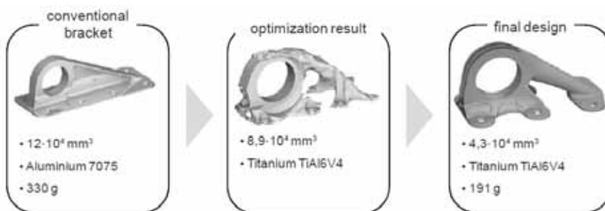
Figur 8. Framgångsrik lättviktsoptimering av en konsol för Airbus där man genom att kombinera LAM-processen med ett strukturoptimeringsprogram lyckats halvera vikten trots materialbytet från Aluminium till Titan.
