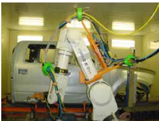
Figur 2. Varianthållsskäring av F150-hytten i MTP i Dearborn med hjälp av en Kawasaki -robot. Man använder 700W från en Trumpf -laser; skärverktyg från Precitec , samt ett visionsystem av fabrikatet Perceptron .
