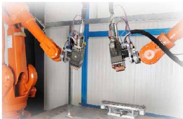
Figur 10. ABBs dual-robot system erbjuder hög produktivitet vid fjärrlasersvetsning. Tillsammans med Degen Development Ventures LLC erbjuder man ett kostnadseffektivt alternativ till Daimlers Robscan-lösning.
