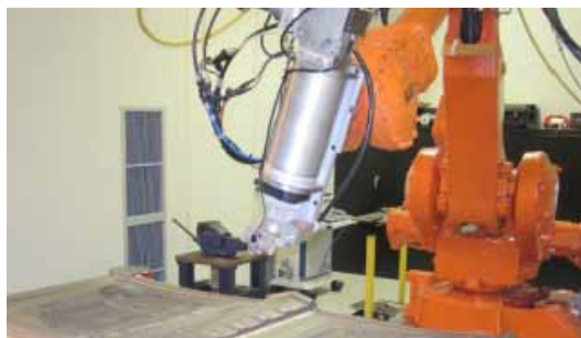
Figur 12. Laserhårdning av komplexa formverktyg hos Magna Stronach med temperaturkontroll i realtid för bästa resultat.
