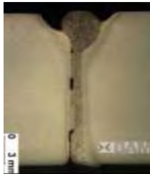
Figur 8. BIMO-verktyget kan kombineras med en endimensionell linje-scanner vilken använts vid lasersvetsning av pipelines t.v. Med en spalt på 0,5 mm ses resultaten utan inkopplad scanner-funktion närmast, att jämföras med en 0,7 mm stor pendling med 200 Hz frekvens t.h.
