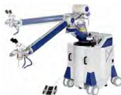
Figur 2. Olika utrustningar för laserpåläggning hos Sulzer Innotec; Längst t.v. en station baserad på en 2 kW CO 2 -laser och därefter mobila enheter med en 1,5 kW fiber- resp. en 150 W Nd:YAG-laser.
