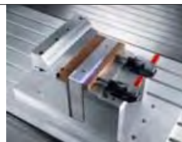
Bild 2. Lasersvetsat batterihölje för en single cell i ett batteriblock till en elbil.
