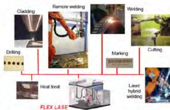
Figur 11. De flexibla lasercellerna FlexLase (t.v.) och FlexLase Pro (t.h.) vilka marknadsförs av VIL Laser Systems. Cellerna kan hantera de flesta laserprocesser såsom skärning, svetsning, borrarning, påläggning och härdning, men är även lämpliga för "remote"-bearbetning och hybridsvetsning.
