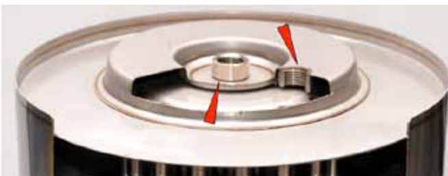
Figur 15a. Överlappssvetsning av två muffar där en monteras direkt på locket medan den högra svetsas i en s.k. vatten-fördelare.
