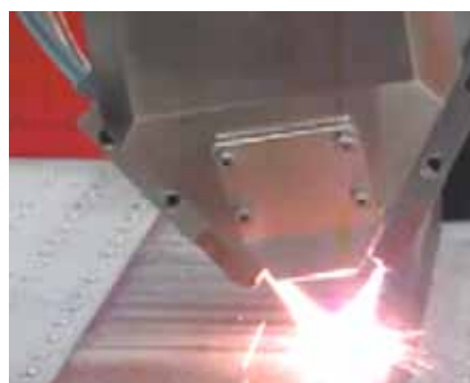
Figur 26. Med en negativ lins integrerad i strålförningsmodulen kan man ändra brännfläckens utbredning. Vid denna typ av rektangulära fokuspunkter bör pulvertillförsel ske längs de två långsidorna.
