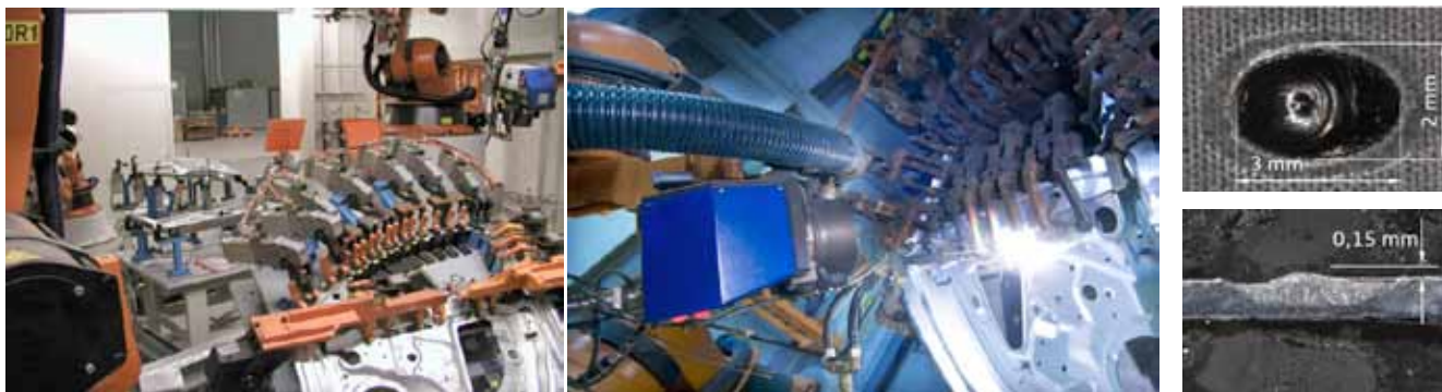
Figur 9. "Scanner"-svetsning av sidodörrar till Audi A4-modellen. Genom att på singeldetaljerna skapa små noppor (t.h.) med hjälp av en pulsad fastkroppslaser säkerställs en god svetskvalitet vid dessa överlappsfogar anbringade på detaljer av zinkbelagd stålplåt.
