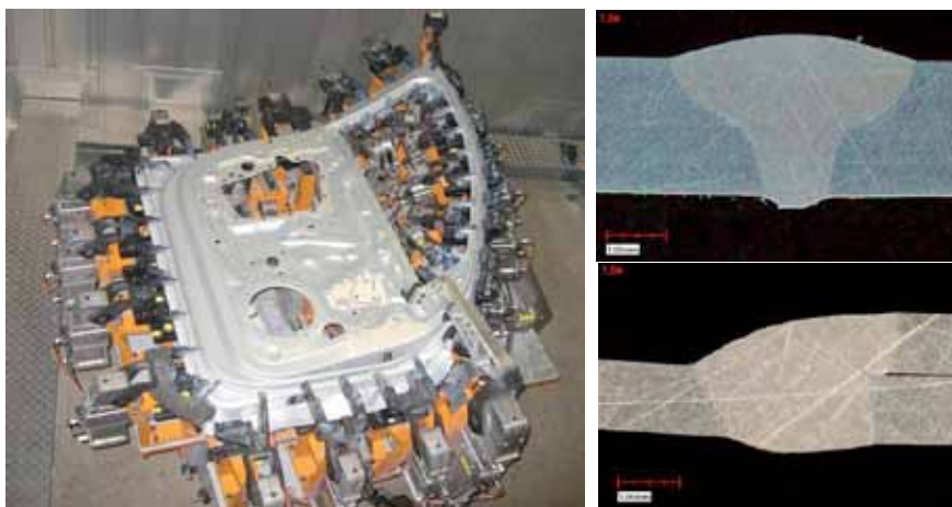
Figur 10. Avancerad fixering av detaljerna inför lasersvetsning av aluminiumsidodörrar till Audi A8-modellen. Svetsningen utförs både som överlapps- och kantsvetsar i plåttjocklekar mellan 1,2 och 1,7 mm.
