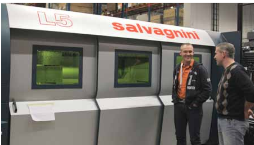
Daniel Petterson (VD) och Lennart Karlsson på Gårö Plåtprodukter berättar att valet föll på en 3 kW Salvagnini L5 fiberlaser eftersom den är idealisk för deras produkter vilka mestadels är i tunnplåt.
