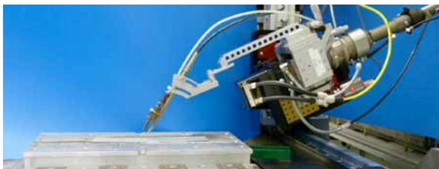
Figur 21. Genom att låta laserstrålen ha en "släpande" infallsvinkel på endast 24° åstadkommer man en förvärmning av plåtytan vilket medger att man kan löda med hastigheter upp till 9 m/min. Tillsatsmaterialet matas däremot fortfarande in i 60° "släpande" (t.v.).
