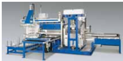
Figur 14. Mantlarna till termobatteriernas behållare rullformas och stumsvetsas med en disk laser i denna Flexistar-maskin.
