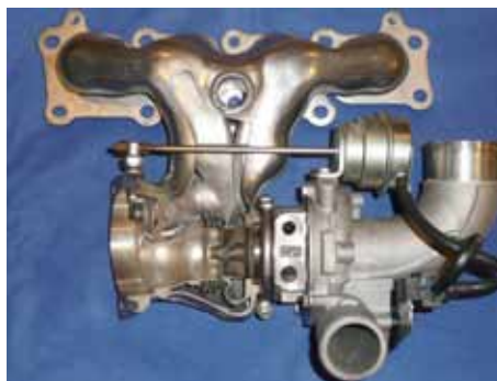
Figur 19. Såväl plåthus i X15CrNiSi20-12 (t.v) som gjutna hus i 1.4828-material (t.h.) har med framgång lasersvetsats hos NUTECH GmbH. 2,5 kW effekt från en Nd:YAG-laser ger ett minsta insvetsdjup på 1,5 mm vid en svets hastighet på 3 m/min.
