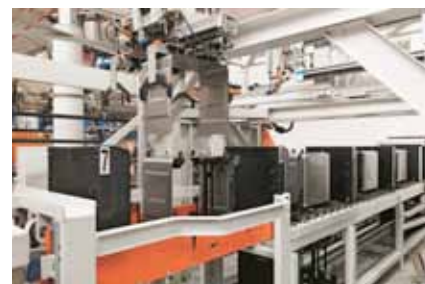
Robotar placerar lock, mantel och bottenplåt i 0,6 mm stål på en paletttransportör.
