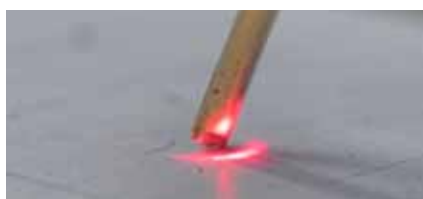
Figur 21. Genom att låta laserstrålen ha en "släpande" infallsvinkel på endast 24° åstadkommer man en förvärmning av plåtytan vilket medger att man kan löda med hastigheter upp till 9 m/min. Tillsatsmaterialet matas däremot fortfarande in i 60° "släpande" (t.v.).
