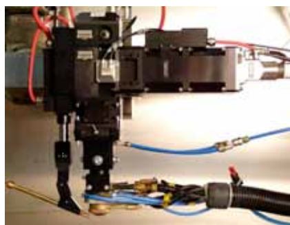
Figur 20. Genom att kombinera laserstrålen med en plasmaelektrod kan man svetsa aluminium utan användning av flussmedel. Den ringformade elektroden (t.h.) omges av tre gasflöden; plasmagas, fokusergas och skyddsgas. Man använder sig vidare av en taktlig följning samt en kraftig cross-jet för att skydda optiken.
