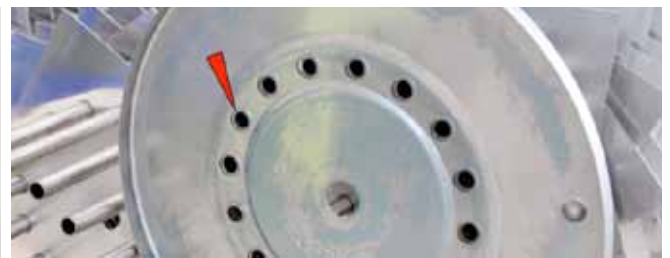
Figur 15b. 16 stycken rör för varmvattentransport fjärlasersvetsas till locken i en viss följd för att minimera värmedistorsioner.
