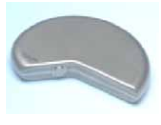
Figur 24b. Tätsvetsning av hjärtpumpar och pacemakers går att åstadkomma med hjälp av en pulsad laser med 50 W medeleffekt.
