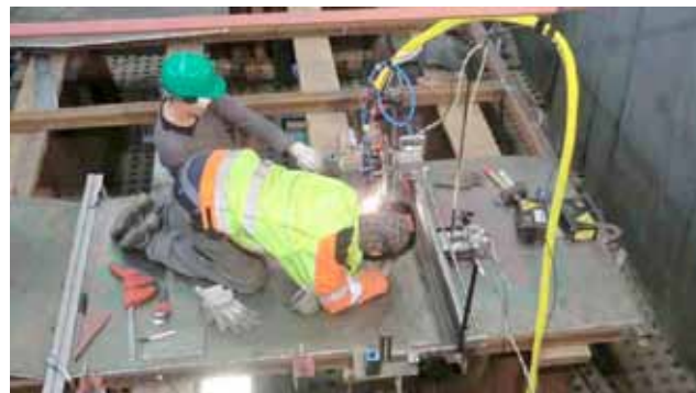
Figur 12. Sektioner i sandwichmaterial lasersvetsas med en 5 kW diodlaser och linjärxlig robot i öppna varvslokaler.
