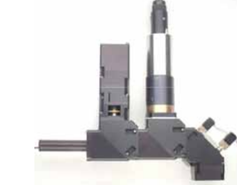
Figur 22. ILT's CPC-verktyg med koaxial kameraövervakning av svetsmältan och extern belysning av densamma gör att bedömningen av svetskvalité blir okänslig för vilken typ av material som bearbetas.
