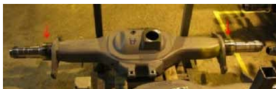
Bild 2. Lasersvetsning av bakaxlar sker nu i en helautomatiserad anläggning hos Ferrufrom AB i Luleå efter ett långvarigt samarbete med LTU. Bilden visar bryggan med axeltappar och pilarna indikerar svetsarnas läge.
