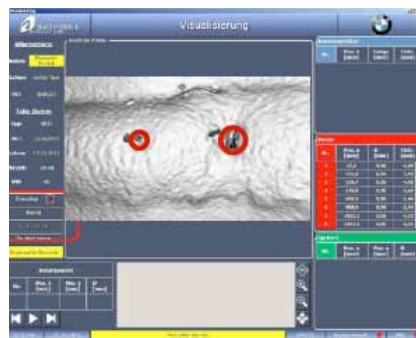
Figur 31. "Off-line"-kvalitetskontroll av laserlödda fogar hos BMW sker idag företrädesvis genom lasertriangulering med ett verktyg från företaget W+R.
