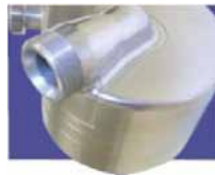
Figur 24b. Tätsvetsning av hjärtpumpar och pacemakers går att åstadkomma med hjälp av en pulsad laser med 50 W medeleffekt.
