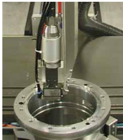
Figur 19. Lasersvetsning inuti en Titanium-hylsa som är en detalj till Airbus A319. Längst t.h. ett detaljsnitt av det svetsade området
