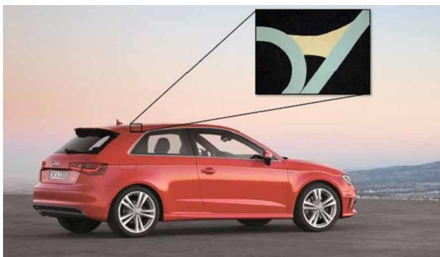
Figur 1. Ett karaktäristiskt tvärsnitt genom en s.k. "nollspalts"-fog. Med en diodlaser med hög verkningsgrad laser-löder Audi taket till karosidorna på A3-modellen. Någon mer omfattande efterbearbetning av lödfogen krävs inte, utan det är tillfyllt med en lätt slipning innan karossen skickas in i lackeringsprocessen.
