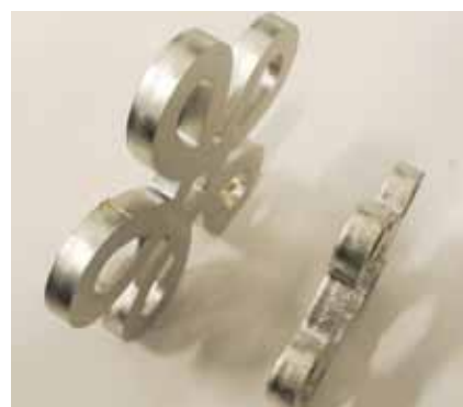
Bild 6. Jämförelse mellan laserskurna detaljer; CO 2 -laser t.v. och 4 kW fiberlaser t.h.
