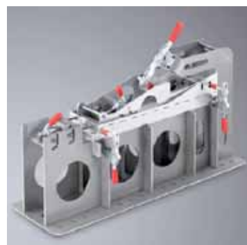
Figur 9. Exempel på några flexibla och modulära fixtursystem som möjliggör en kostnadseffektiv produktion med laserteknik även vid små seriestorlekar.
