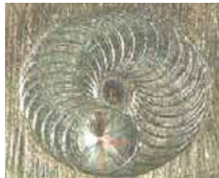
Figur 24a. Några vackra exempel på hermetiska förslutningar av batterier som gjorts med lasermikrosvetsning.
