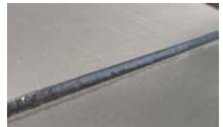
Figur 6. Genom att med en induktionsspole förvärma materialen skapas bättre vätningsförutsättningar för tillsatsmaterialet AlSi3Mn vid denna mixmaterial-svetsning av AA6016 (topplåt) till AlSi-belagt 22MnB5 (basplåt).
