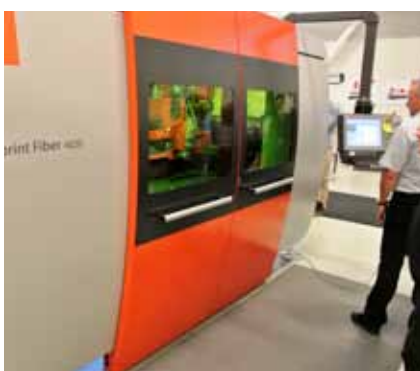
Bild 5. BySprint 4020 med 4 kW fiberlaser skar 10 mm stålplåt, 8 mm rostfritt stål och aluminium med bra resultat.
