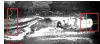
Figur 30. "On-line"-processövervakning av lasersvetsningen av mellanbrädan sker med hjälp av Lessmüllers WeldEye®-verktyg. Ovan t.v. kamera-bilden av en perfekt svets, och t.h. utseendet då laserstrålen hamnat offset i förhållande till kälfgogen.
