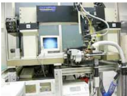
Figur 16. Olika automatiseringskoncept används för manipulering av laserstrålen från pulsade Nd:YAG-lasrar; linjäraxel t.v. och en liten 6-axlig robot t.h.
