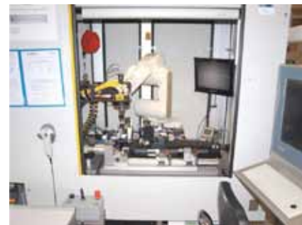
Figur 16. Olika automatiseringskoncept används för manipulering av laserstrålen från pulsade Nd:YAG-lasrar; linjäraxel t.v. och en liten 6-axlig robot t.h.
