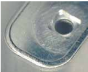
Figur 24a. Några vackra exempel på hermetiska förslutningar av batterier som gjorts med lasermikrosvetsning.
