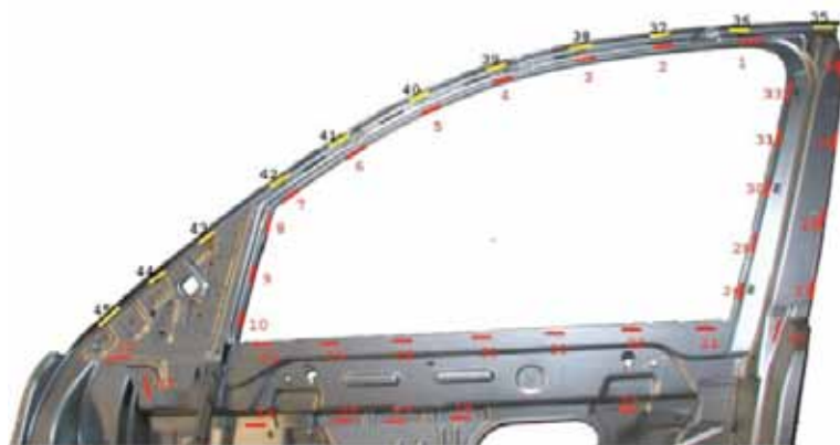
Figur 2. Disklasrar används vid "remote"-svetsning av sidodörrar i stål. Laserstrålen kan med denna teknik flyttas från ett svetsläge till ett annat på extremt kort tid. Också då enkelsidig åtkomst för svetsverktyget föreligger kan komplexa geometrier, som i detta fall en dörrbåge, lasersvetsas på ett effektivt och enkelt sätt.
