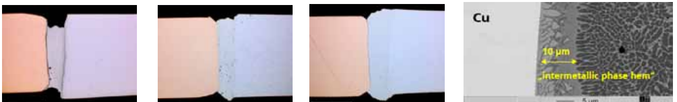
Figur 28. Positioneringen av laserstrålen har stor betydelse för svetskvalitet och hållfasthet i denna typ av stumfog mellan koppar och aluminium. Övan fr.v. positionering 100 µm in på kopparsidan, mitt i fogen samt 100 µm in på aluminiumsidan. Det senare innebär att bredden på de intermetalliska faserna kan minskas från 30 till 10 µm (t.h.).
