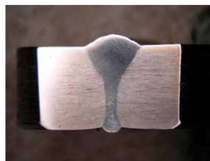
Resultat vid laserhybridsvetsning med pulsåge i rostfritt. Med 0.5 mm spalt försvinner rågen helt vid samma parameteruppsättning för övrigt.
