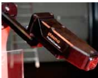
Figur 4. Med Plasmos "ProfileObserver" går det att kontrollera lödfogens bredd, vågighet och eventuella andra ystörningar.
