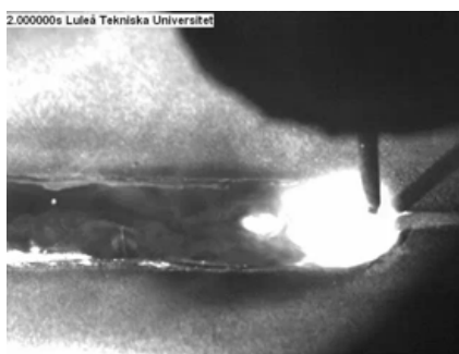
Resultat vid laserhybridsvetsning med pulsåge i rostfritt. Med 0.5 mm spalt försvinner rågen helt vid samma parameteruppsättning för övrigt.
