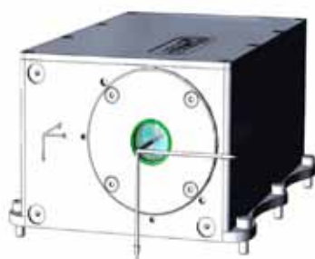
Figur 7. Origo och axlar för sensorenheten. Z-axeln sammanfaller med den optiska axeln.
