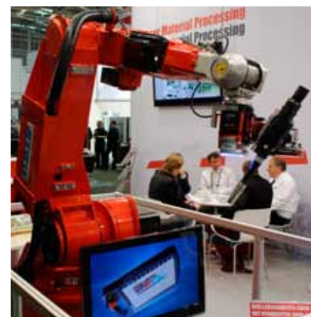
Bild 7. Reis Laserrobot med integrerad stålgång och utrustad för hybridsvetsning.
