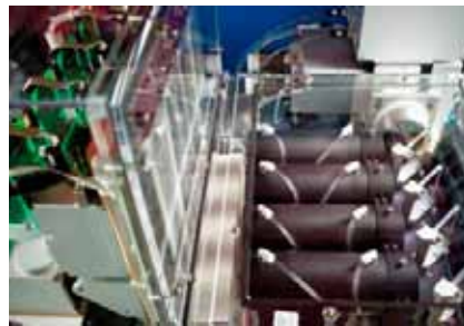
Figur 3. En titt inuti en diodlaserkälla med 8 laserstaplar (t.v.) och 4 kollimeringsenheter med motsvarande våglängdskopplingar.
