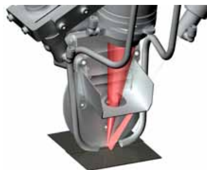
Bild 2. Fogföljningsprincip för Permanovas svets-verktyg WT03 och WT04.
