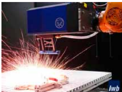
Figur 21. Ablationsskäring (t.v.), s.k. RLAC, lämpar sig bäst för tjocklekar kring 0,1 mm, medan konventionell laserskäring (RLFC, t.h.) rekommenderas för grövre tjocklekar från 0,3 mm och uppåt.
