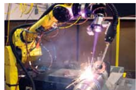
Figur 3. Med avancerade strömkällor som t.ex. Lincoln Electrics Power Wave® i400L (närmast), kombinerad med företagets Synergic Waveform Control™, blir det möjligt att styra såväl spänning som ström och lasereffekt för att erhålla ett optimalt påläggningsresultat.
