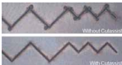
Figur 20. Laserskärning utan respektive med effektövervakning genom den nya funktionen TruControl 1000.
