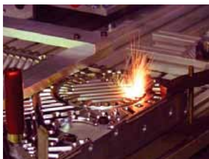
Figur 20. Vid Mars Lasertechnik GmbH har man utvärderat ett kombiverktyg för "remote"-skäring och "remote"-svetsning av plattvärmeväxlare i 0,6 mm tjockt rostfritt material.
