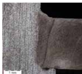
Figur 12. I den nya växellådan till Mercedes A- och B-Klassem modeller hittar vi inte mindre än 16 stycken lasersvetsar, varav sju stycken används vid sammanbyggnaden av den unika oljekylda dubbelkopplingen. Svetsarna utförs som stumsvetsade I-fogar med ett minsta inträngningsdjup på 3 mm (t.v.).
