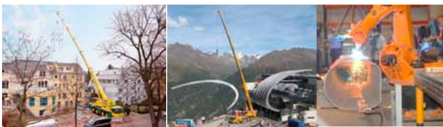
Figur 12. Teleskoprör till mobilkranar är huvudprodukten hos företaget Vlassenroot KSK GmbH i Bochum, vilka numera tillverkas med hjälp av laserhybridsvetsning och en 12 kW fiberlaser. Längst t.h. tidiga svetsförsök från 2008 med utrustning från Fraunhofer IWS.
