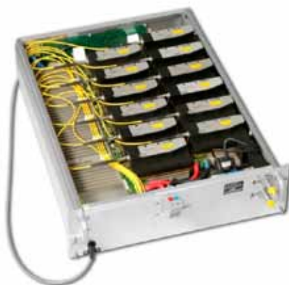
Figur 22. En typisk fiberlasermodul från RofinSinars produktprogram av fiberlasrar. I deras FL-serie erbjuder man "single-mode"-källor med effekter upp till 1 kW, och "multimode"-dito med 6 kW som högsta effekt.
