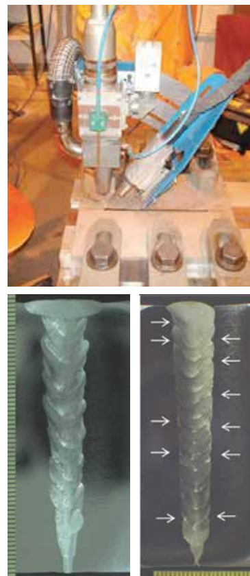
Figur 32. Överst den aktuella försöksupställningen och därintill en stumfog svetsad med tio strängar och en fogberedning med 10,2 mm:s öppning. Om däremot fogöppningen överstiger 12 mm (längst t.h. ovan) är risken för bindfel (vita pilar) uppenbar.
