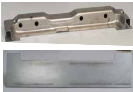
Figur 6. Vidstående ryggstödsbalk serie-produceras hos Johnson Controls där man lasersvetsar ett 1,2 mm tjockt stållock till en 1,2 mm tjock aluminiumsektion i legeringen AA6022-T0.
