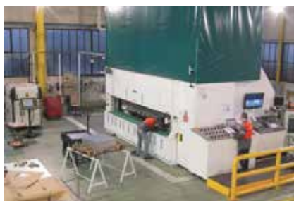
Figur 2. T.v. en översiktsbild över anläggningen för ämnessvetsning med laser i ArcelorMittals utvecklingscenter i Montataire, och t.h. det multifunktionella lasersvetsverktyget med kameraövervakning av fogföljning och svetsgeometri, samt enheter för lasersvetsning och -ablation.
