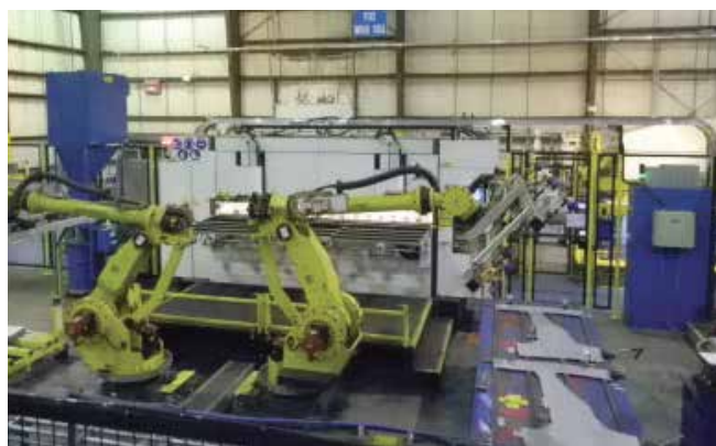
Figur 5. Ämnesskärningsanläggningen hos AMTB i Pioneer, OH, med ytavverkningsstationen t.v. och svetsanläggningen för dörröppningsramen t.h. där en fiberlaser har ersatt den tidigare CO 2 -lasern.
