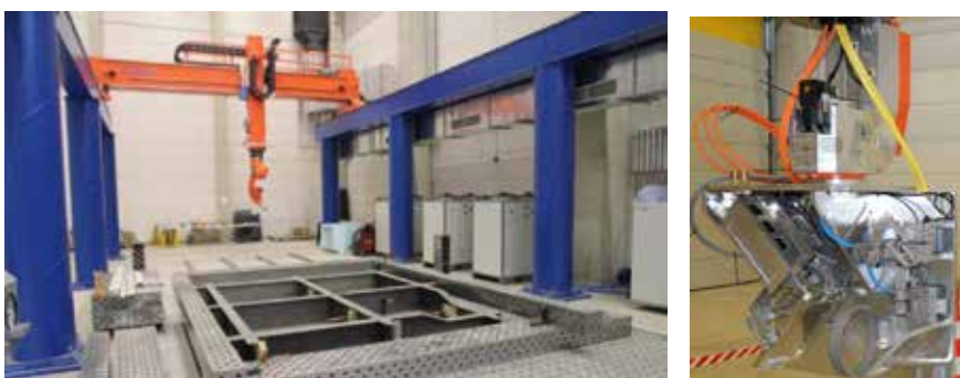
Figur 20. Investeringen i en imponerande portalrobotanläggning möjliggjordes via medel från det BMBF-finansierade QulnLas-projektet. Även i denna anläggning kan man fjärrlasersvetsa med det vid LZN egenutvecklade verktyget "Dragon Concept 4.0" (längst t.v.).
