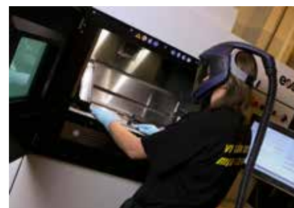
Bild 2. Industriell tillverkning med LAM – pågående process och hantering av färdig detalj.
