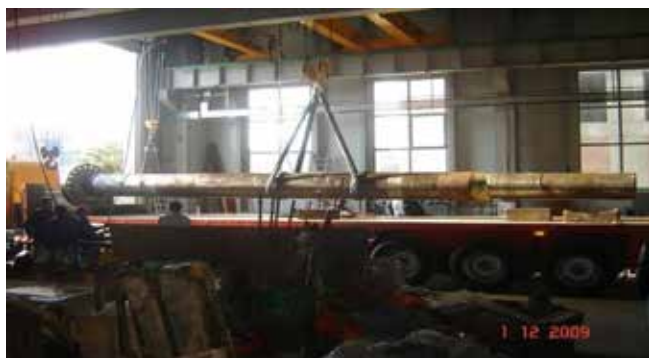
Figur 3. Propelleraxel, 11,5 m lång med en vikt på 26 ton.
