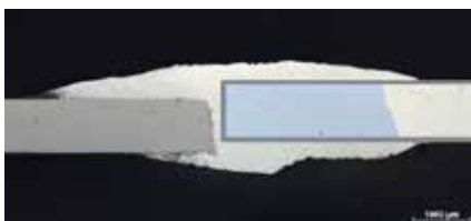
Figur 8. Formsprutade fästelement i PA6.6 utgör den transitiva delen då de lasersvetsas med en diodlaser med 940 nm våglängd till antingen svartpigmenterad PA6.6. (t.v.) eller kolfiberförstärkt sådan (t.h.).
