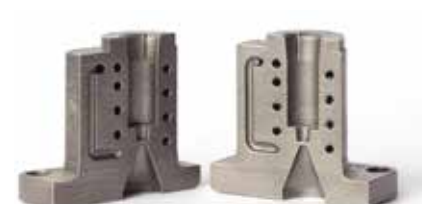
Bild 3. Verktøy med kylkanaler – 3D laserprint i verktygsstål.
