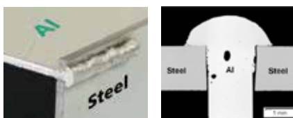
Figur 2. Med denna "tapp/slits"-lösning blir det möjligt att med en oscillerande laserstråle sammanfoga aluminium med stål.
