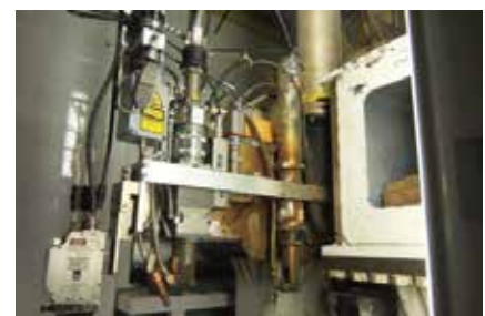
Figur 2. T.v. en översiktsbild över anläggningen för ämnessvetsning med laser i ArcelorMittals utvecklingscenter i Montataire, och t.h. det multifunktionella lasersvetsverktyget med kameraövervakning av fogföljning och svetsgeometri, samt enheter för lasersvetsning och -ablation.
