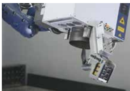
Figur 15. Trumpf-verktyget ”ScanLine“ är avsett för fjärrlasersvetsning och arbetar på samma sätt som välbekanta ”SeamLine Pro“ med pre-, in- och postprocessering.
