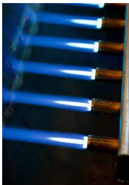
Fig. 7. Förvärmning före påläggning av slitageskikt.
