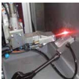
Figur 34. Väggen "A-Protection" består av två skivor med en mellanliggande vätska. Sensorer i denna registrerar temperaturförändringar som är ett resultat av en felriktad laserstråle.
