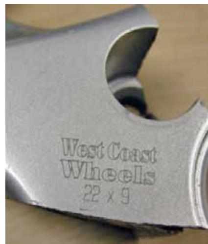
Figur 1. Kundlogotypen på det här utsnittet från ett pulverlackerat hjul märktes med 58 W laser-effekt och en processhastighet på 22,5 ”/sek (=571,5 mm/sek), vilket gav en sammanlagd cykeltid på 0,70 sekunder!
