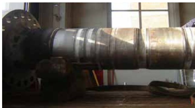
Figur 4. Det skadade området på propelleraxeln.
