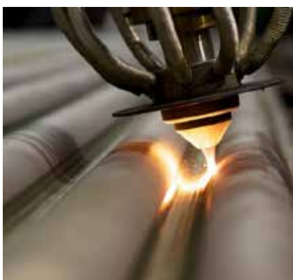
Figur 1. Reparation av långa pannrör genom laserbeläggning. Processhuvudet är monterat på en industrirobot. Bilder: Whertec
