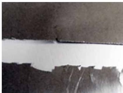
Figur 2. T.v. ett mekaniskt skurit rostfritt stål av 440A-kvalitet, vilket uppvisar en bedrövlig kvalitet då metallklingan skapar skjuvkrafter som resulterar i ojämna och sönderbrutna snittkanter, medan bilden t.h. illustrerar resultatet från en kontaktlös CO 2 -laserskärning med en kontinuerlig och jämn snittkant.
