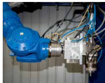
Bild 10. Den nya laserskärcellen hos PDS Manufacturing. En takhängd Motoman med Precitec skärhuvud YK52 skär ämnen och pressade plåtdetaljer med en 4 kW diodlaser från LaserLine.
