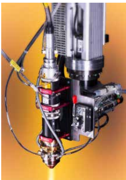
Fig. 6. Detaljbild 2 av utrustningen för laser cladding.
