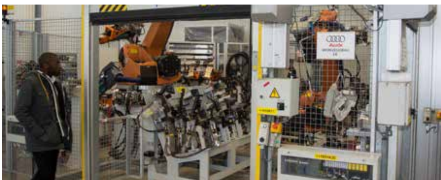
Bild 11. En av de laserceller PDS Manufacturing har övertagit från AUDI för produktion till eftermarknaden.
