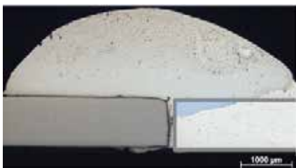
Figur 7. Överst principen för laserlödning med stråloscillering och närmast överst snittbilder genom stumfogar utförda med AlSi12-tråd överst respektive ZnAl4 underst där den senare ger betydligt mindre uppsmältning av aluminiumpartnern.
