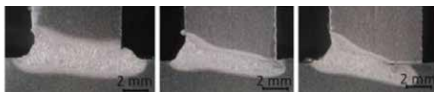
Figur 28. En flackare infallsvinkel på laserstrålen ger en bättre penetration i denna T-fog. Vinkeln mot horisontalplanet är fr. v. 6°, 10° och 15°.
