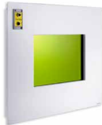
Figur 36. Ett "aktivt" skyddsglas från UVEX LaserVision, vilket kombinerar två passiva filter mellan vilka man placerat en ljusledande mittsektion som övervakas med ett antal sensorer.
