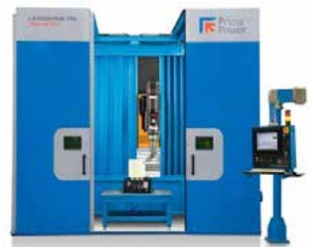
Figur 17. Prima Power Laserdyne modell 795 erbjuds i två varianter; XS med linjäraxlar i x-, y- och z-led på 1 m, och XL som har en x-axel förlängd till 2 m. Linjärmotorerna genererar en max. hastighet på 20 m/min, och arbetsstationen kan tillhandahållas med såväl CO 2 - som disk eller fiberlaser upp till 5 kW.
