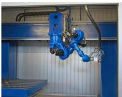
Bild 10. Den nya laserskärcellen hos PDS Manufacturing. En takhängd Motoman med Precitec skärhuvud YK52 skär ämnen och pressade plåtdetaljer med en 4 kW diodlaser från LaserLine.
