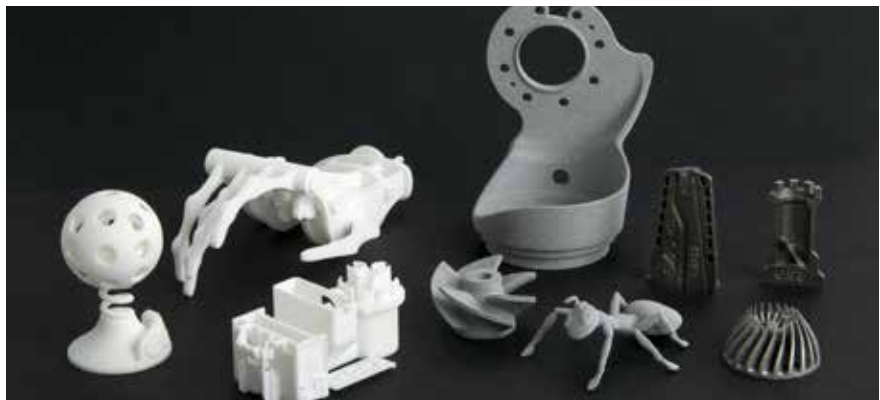
Bild 1. Exempel på komponenter tillverkade i metall och plast med LAM hos Lasertech LSH AB.
