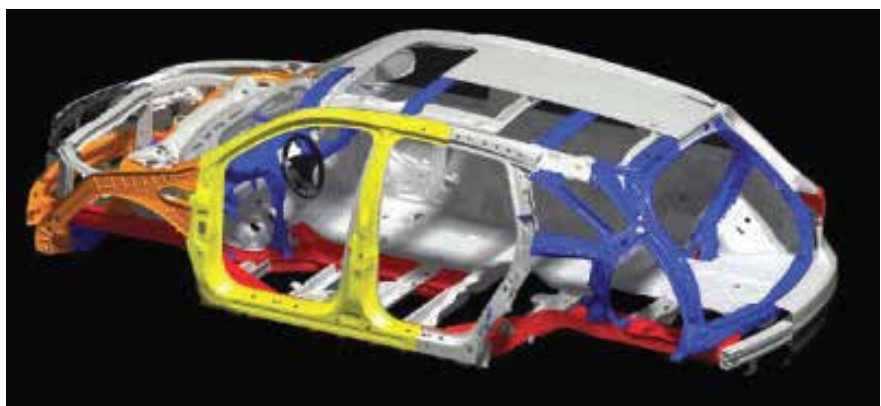
Figur 3. Karosstrukturen för Acura MDX med den ämnesskarvade ”dörröppningsramen” markerad i gult.
