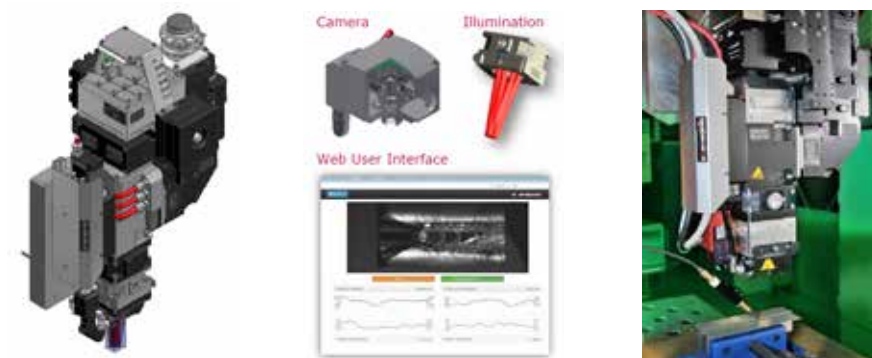
Figur 17. Processövervakningsverktyget SCeye® består av tre komponenter; en kamera, en belysningsenhet med fyra stycken VCSELs samt ett ”web-interface“. Som framgår av bilderna kan SCeye® enkelt integreras i Scansonics ”ALO3“-verktyg för svetsning eller lödning.
