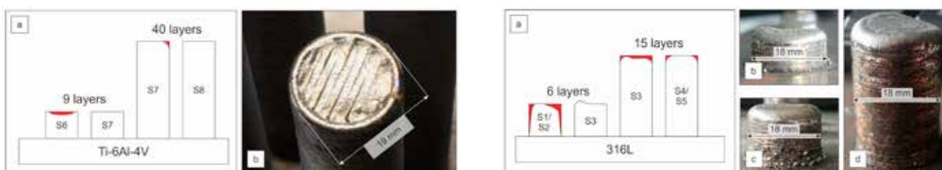
Figur 28. LMD-strukturer tillverkade i Ti6Al4V var lättare att åstadkomma med god kvalitet jämfört med dito i rostfritt 316L-material. T.h. en närbild på mönstret för ett s.k. standard-skikt.
