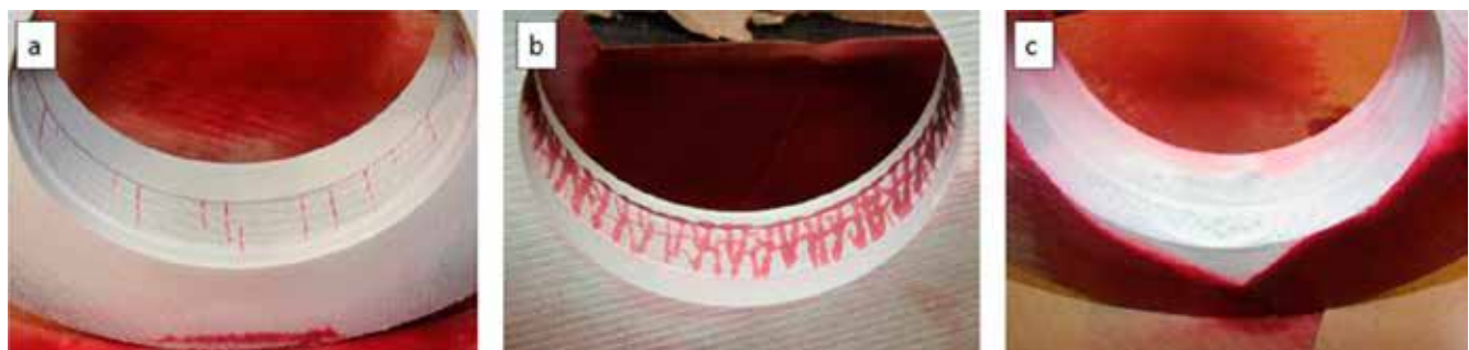
Figur 35. Penetranttest av det pålagda skiktet; a) förvämt utan buffertlager, b) buffertlager utan förvärmning, samt c) både förvärmning och buffertlager.
