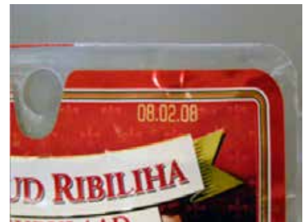
Figur 1. Med 25 W lasereffekt avlägsnades trycket på denna etikett så att den underliggande guldfärgade baskulören frilades. Den åtta-ställiga datummärkning fullbordades med en processhastighet på 25"/sek (= 635 mm/sek) under 0,13 sekunder.
