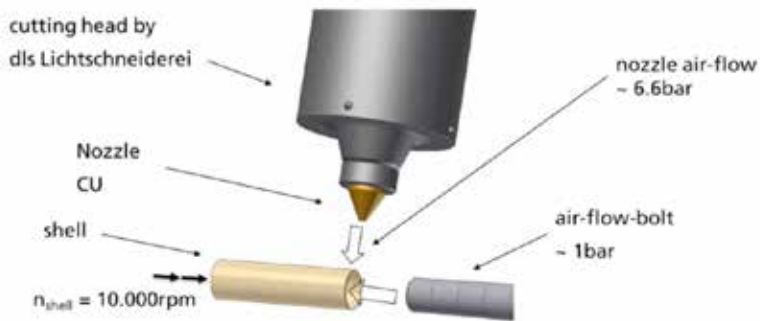
Figur 55. Schematisk illustration av försöksetuppningen med skärverktyg, arbetsstycke och skärgastillförsel.
