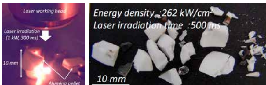
Figur 60. "Laserkrossning" av en keramisk provkropp där slutresultatet efter ett antal 500 ms långa laserpulser syns t.h.
