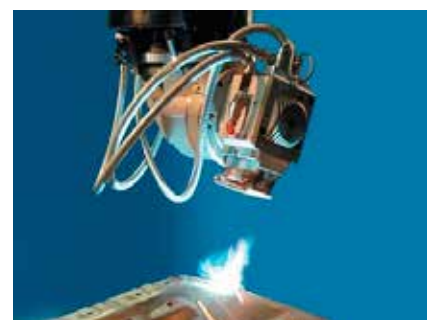
Bild 6. Prima Power Rapido. Lösningar för snabb hantering finns som standardiserade optioner för denna snabba 3D-maskin för både skärning och svetsning i Primas program för högvolumproduktion.
