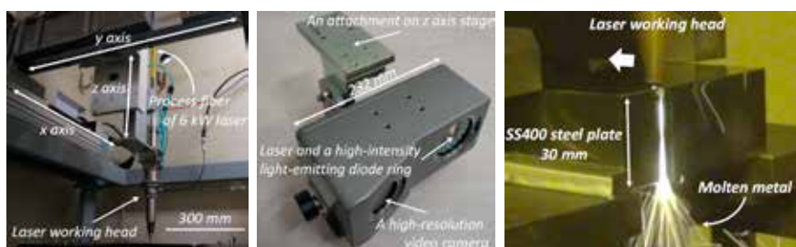
Figur 59. Skärverktyget monterat i en treaxlig portalrobot och därjämte ett ”scanner”-verktyg avsett för montering på robotens z-axel. T.h. ett exempel på laserskärning av en 30 mm tjock stålplatta.
