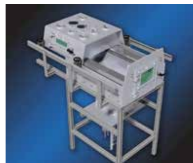
Figur 11. Gamla SLM-klassiker som Nacelle-gångjärnet (t.v.) var ett av många applikationsexempel som Dr. Meiners visade upp, men den stora nyheten var den nya prototypmaskinen (t.h.) vid ILT vilken arbetar med fyra separata laserstrålar för att på så sätt effektivisera uppbyggnadsprocessen.
