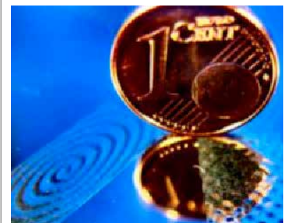
Figur 20. Då lasereffekten varieras sinusformat med allt större amplitud blir profilhöjden på det skapade mönstret högre, och ovan ett exempel på en strukturerad Inconel718-yta.
