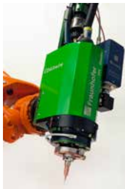
Figur 63. Fraunhofer IWS har utvecklat detta COAX-wire verktyg med koaxiell trådmatning och tre omgivande laserstrålar.
