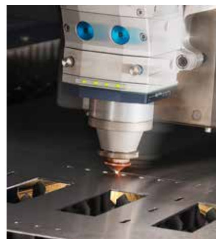
Bild 1. Precitec's nya skärhuvud, ProCutter, är utrustad med ett integrerat, sofistikerat sensorsystem som tar liten plats. Detta övervakar skärprocessen och ger användaren all relevant information om driftssituationen. Statusen visas tydligt med en LED-display.
