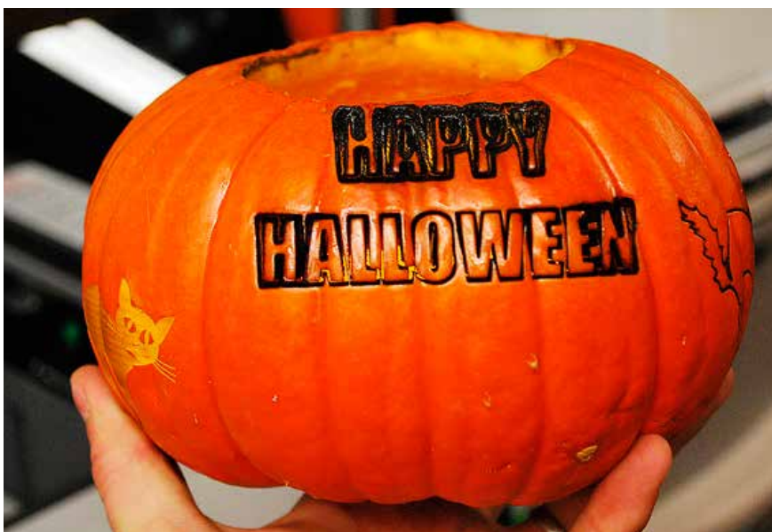
Figur 72. Även om en pumpa har förhållandevis tjockt skal är det ingen match för en \text{CO}_2 -laser på 400 \text{ W} med lång Rayleigh-längd att konfigurera ett "ansikte" på under fyra minuter.
