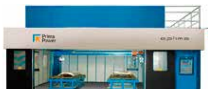
Bild 5. Prima Power Optimo har flexibel delad kabinlösning för maximal "beam on-time". Standardoptioner med styrda skyttelbord ger även möjlighet till bearbetning av långa 3D komponenter.
