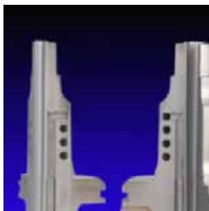
Figur 15. Vid tillverkning av mikroformverktyg med integrerade kylkanaler är det viktigt att laserstrålen har korrekt sekventiell rörelse vid LMD-processen för att inte riskera att kanalerna sätts igen.
