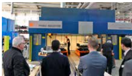
Bild 3. Renskärning av stora flexformade plåtdetaljer sker i Prima Optimomaskinen, som är utrustad med dubbla skärbord.
