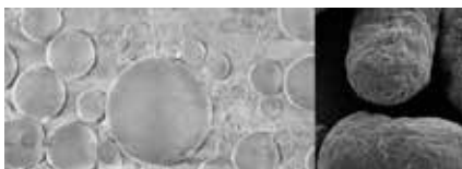
Figur 24. Pulverpartiklar i sfärisk form innebär en optimal SLM-process. T.v. PBT (PolyButylene Terephthalate) -partiklar producerade genom kall våtslipning, att jämföras med kommersiellt tillverkat PA12 (PolyAmid) -pulver.
