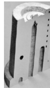
Figur 15. Vid tillverkning av mikroformverktyg med integrerade kylkanaler är det viktigt att laserstrålen har korrekt sekventiell rörelse vid LMD-processen för att inte riskera att kanalerna sätts igen.
