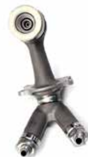
Figur 8. I varje s.k. LEAP (Leading Edge Aviation Propulsion)-motor sitter 19 stycken additivt tillverkade insprutningsmunstycken (t.h.), varfor General Electric raknar med att ha producerat 200.000 sadana fram till ar 2020.
