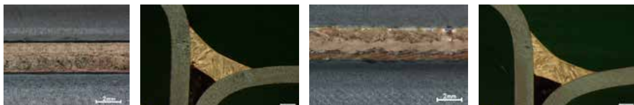
Figur 3. T.v. toppvy och tvärsnitt för en laserlörd fog utförd med trifokal-tekniken och t.h. motsvarande utseende då konventionell laserlödning använts.
