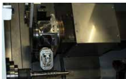
Bild 3. Strukturering med pulshade lasrar av ytor är en av de många processer som IPT arbetar med. Här visas verktyget till ett rattnav med laserstrukturerad yta och det färdiga resultatet som har en välliknande läderlook.
