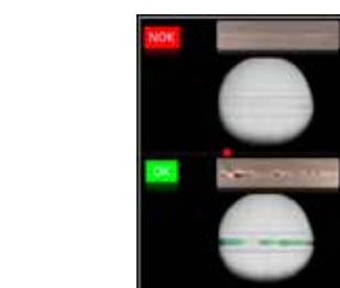
Figur 16. Med det kamerabaserade övervakningssystemet VISAL analyseras en gråskalebild av svetsen och man kan på så sätt bl.a. avgöra penetrationsdjupet.
