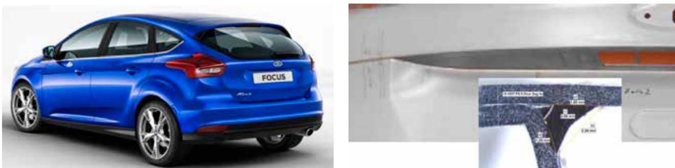
Figur 9. Laserlöddning möjliggjorde ett nytt och modernare designspråk då Focus-modellen var föremål för en årsmodellsändring 2015.
