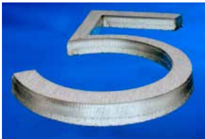
Fig. 4. Typisk snittkvalitet för fiberlaser för 10 mm rostfritt stål. Källa: Fraunhofer ILT, Aachen.
