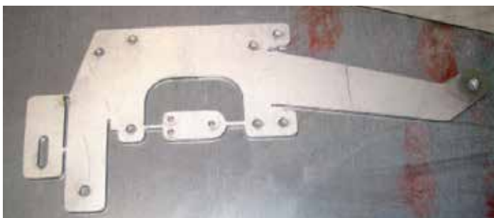
Figur 3. Genom att använda denna form av ”kombinationsprocess” kan MTE på ett effektivt sätt producera små och fina skärkonturer med fiberlasern innan man snabbt ställer om till plasmaskärning av ytterkonturerna. Detta gör att företaget kan dra nytta av det bästa som de två skärteknikerna har att erbjuda.
