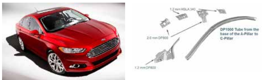
Figur 7. Fords "flaggskepp" Mondeo-modellen har hydroformade vindrutestolpar/taksvällare till vilka 5 olika konsoler monterats med hjälp av fjärrlasersvetsning.
