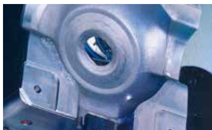
Bild 3. Strukturering med pulshade lasrar av ytor är en av de många processer som IPT arbetar med. Här visas verktyget till ett rattnav med laserstrukturerad yta och det färdiga resultatet som har en välliknande läderlook.
