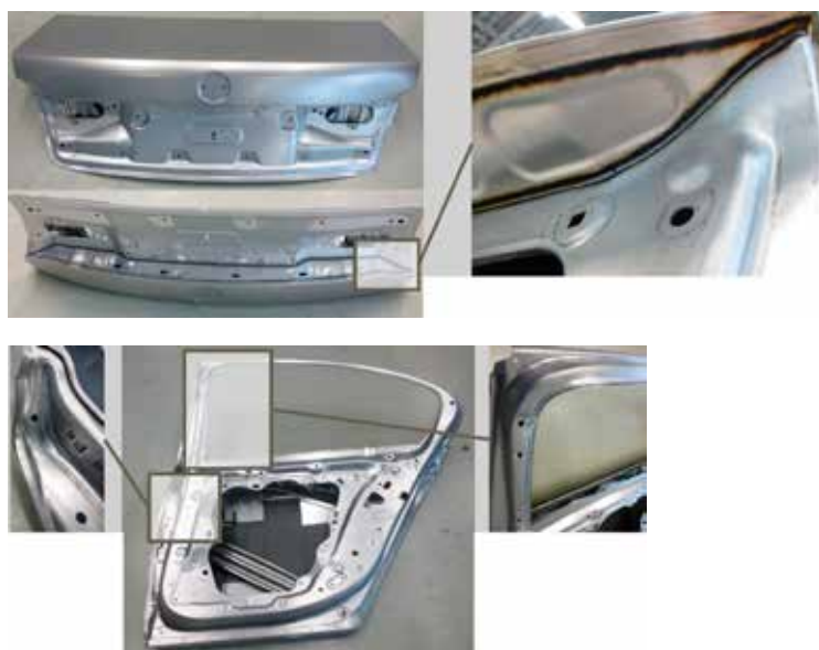
Figur 8. BMWs nya 7 Reihe har baklucka och sidodörrar av aluminium, där lasersvetsningen sker medelst taktillfölgjning med hjälp av den 1,2 mm grova tillsatstråden i legeringen AlMg4,5Mn0,7
