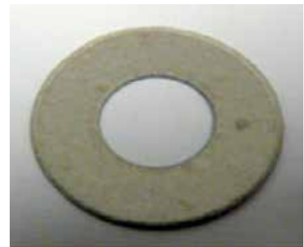
Figur 1. Denna mellanläggsbricka med 20 mm diameter skars med 60 W lasereffekt och en processhastighet på 3"/sec [= 76,2 mm/sek] under en cykeltid på 1,23 sekunder per bricka.
