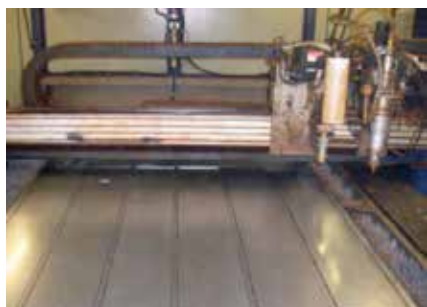
Figur 2. Kombinationen av plasma- och laserskärning i ett och samma maskin erbjuder enorm flexibilitet i materialanvändning hos MTE, där plåttjocklekarna sträcker sig från några tiondels millimeter till som mest 6 mm.
