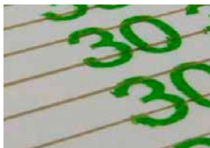
Figur 2. Denna märkning av ett lackerat, industriellt luftreglage fick en hög kontrastverkan genom att använda 25 W lasereffekt och en processhastighet på 20"/sec [- 500 mm/sek] vilket innebär en total märkningstid på 5,42 sekunder.
