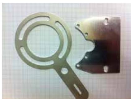
Fig. 1. Typiska detaljer som skärs i en jobshop (rutorna på pappret är 5 mm)
