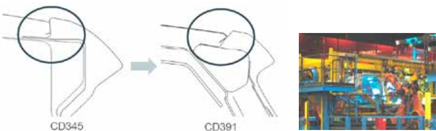
Figur 4. Genom en annan design av takskarven för 2014 års Ford Mondeo-modell har det blivit möjligt att laserlöda taket utan att därefter behöva rotera hela karossen 180°, vilket var fallet med den tidigare generationen (CD345) i Genk-fabrikens ökända ”Elephant Grille” (t.h.).
