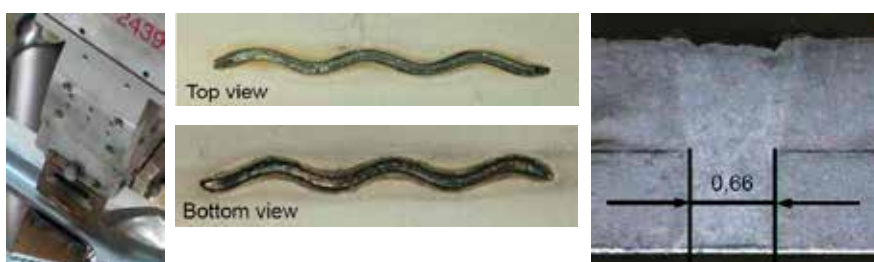
Figur 5. Med IPGs "Seam Stepper" kan man lasersvetsa zinkbelagd plåt, även då nollspalt föreligger, om trifokal-tekniken används.
