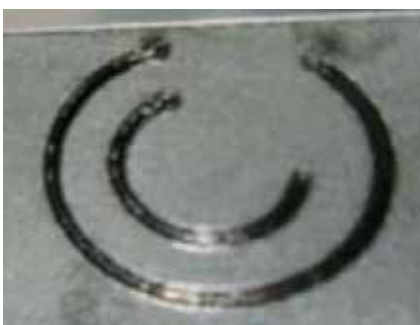
Figur 19. För cirkulära ”remote”-svetsar använder sig Ford av två olika mönster vid noppnings-operationen; ett triangelformat trepunkts-mönster (t.v.) och ett s.k. Etch-mönster som består av två inte helt fullt slutna koncentriska cirklar.
