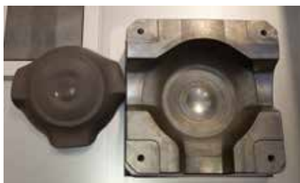
Bild 3. Strukturering med pulshade lasrar av ytor är en av de många processer som IPT arbetar med. Här visas verktyget till ett rattnav med laserstrukturerad yta och det färdiga resultatet som har en välliknande läderlook.
