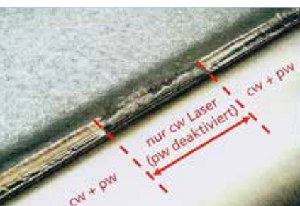
Bild 6. Laserlödning med dubbla laserstrålar där den ena är pulsad gör det möjligt att löda med hög kvalitet utan att använda fluxmedel. Den röda strålen är pulsad och bryter ner oxidskiktet på aluminiumytan.
