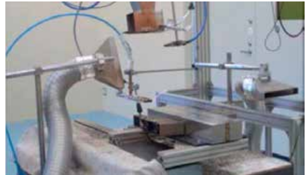
Figur 7. Stumsvetsning av 70 mm tjockt SUS 304-material med 100 kW lasereffekt och två motstående svetssträngar klaras med en processhastighet av 2 m/min.
