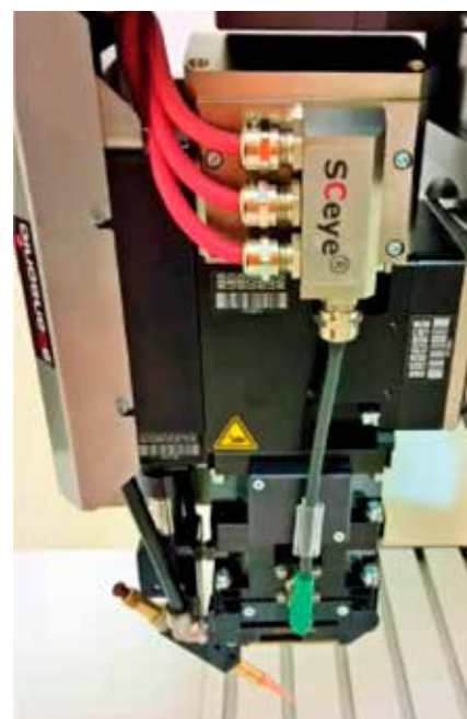
Figur 1. T.v. den experimentella uppställningen vid systemutvecklingen hos ILT, vilken sedan utvecklades vidare till produkten SCeye® (närmast) av Scansonic. Båda verktygen inkluderar en höghastighetskamera och en innovativ belysningsmodul.
