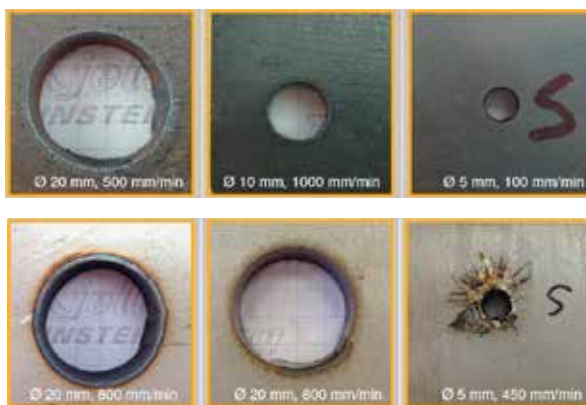
Figur 17. Laserskärningens stora fördel i jämförelse med plasmatekniken är dess förmåga att skära väldigt små hål. Ovan exemplifieras detta i 10 mm tjockt kolstål (ovan) och rostfritt stål (nedan) med fr. v. plasmaskärning, finplasmaskärning och laserskärning med 4 kW effekt.
