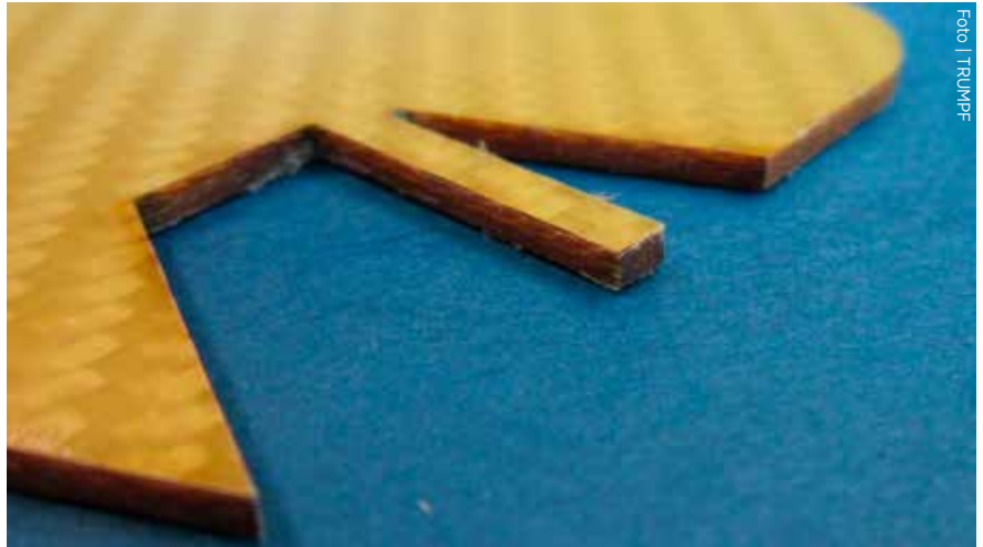
Bild 2. Laser är ett bra val även för andra kompositmaterial av plast förutom CFRP. Den här bilden visar en 2 mm tjock detalj gjord av aramidfiberförstärkt polymer (AFRP) som skurits med en CO 2 -laser.
