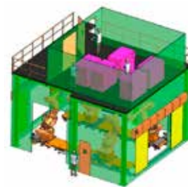
Fig. 8. Volvo XC90 (t.v.) och Volvo S90 (t.h.) är några av de modeller som laserskärs- och svetsas i Torslandaverkens nya karosfabrik TA3, vars lasercell här ses schematiskt illustrerad.
