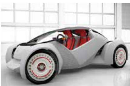
Fig. 14. Hos Local Motors i Phoenix kan man få sin egen specialdesignade personbil tillverkad genom s.k. Selective Laser Melting.
