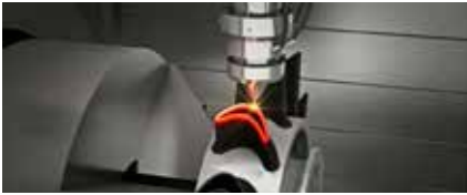
Figur 6. Några exempel på diodlaseranvändning; fr.v. additiv tillverkning hos DMG Mori, påläggning för ökat slit- och korrosionsmotstånd hos WFL och ämnesskarvning hos ArcelorMittal.
