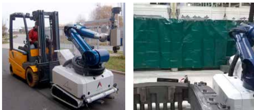
Figur 22. AL-ROCK på väg! Kanske för att laserhärda pressverktyg i Daimlers Bremen-fabrik (ovan).
