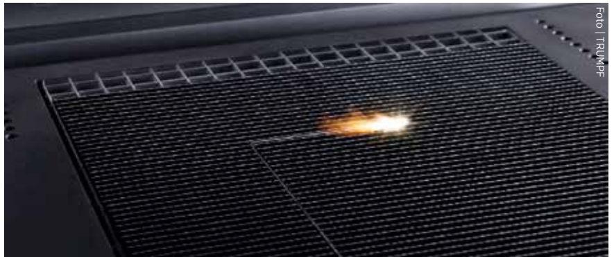
Bild 3. Skärning av en härdad CFRP detalj. Laserskärning av mindre än fyra millimeter tjockt material sker två till tre gånger snabbare än med vattenstråle eller fräsverktyg, och ger dessutom en högre kvalitet på snittet.
