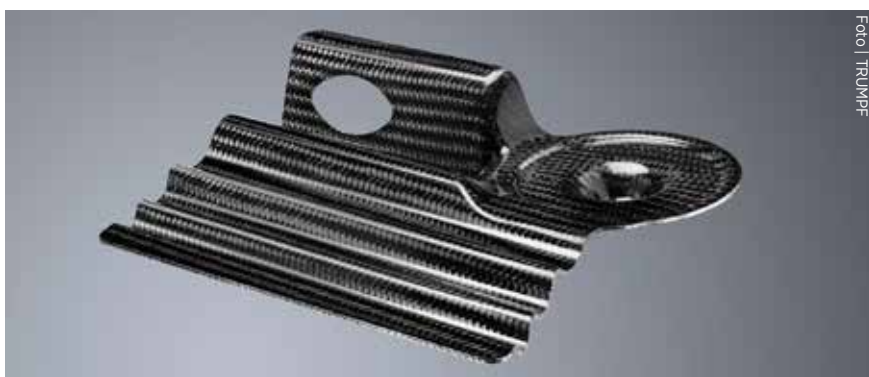
Bild 1. Laserljus möjliggör skärning av vävda delar till nära färdig form. Ingen efterbearbetning krävs för de skurna kanterna.
