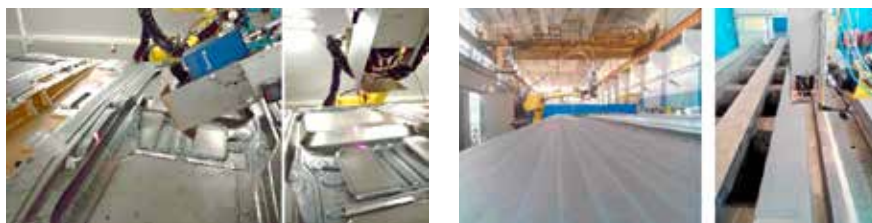
Figur 21. Några imponerande applikationsexempel på laserhärdning; överst ett 14,5 ton tungt pressverktyg och närmas ovan; 13 meter långa slagbommar där en yta på 17 m 2 krävde 54 timmars bearbetningstid.
