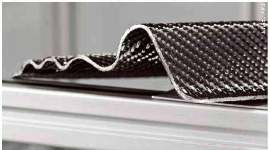
Bild 4. Ljuset från en fastkroppslaser absorberas bra i kolfibrer. Det ger en perfekt skuren kant utan utskjutande fibrer, vilket gör efterföljande hantering snabbare och enklare.
