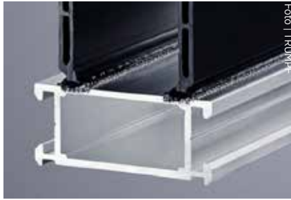
Bild 5. Sammanfogning av metall- och fiberkompositer: en laser med ultrakorta pulser skapar en underskärning i metalldelen, vilket medför att polymeren och den uppvärmda metallen smälter samman ordentligt.
