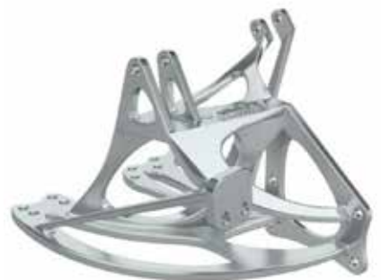
Figur 25. Några additivt tillverkade "aerospace"-komponenter; överst världens första SLM-tillverkade brännkammare i platina, testad med 618(!) tändningar under 1,1 timmar och en max.temperatur på 1.253 °C, och t.h. några typiska konsoler kreerade utifrån topologioptimering och "bionic design".
