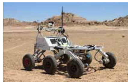
Figur 36. "ExoMars"-projektet avser att landa farkosten "Rover" (t.v.) på mars någon gång under 2018. Med i fordonet finns en liten q-"switchad" diodlaser avsedd för LIBS och LDMS-tekniker, som kan tala om vilka grundämnen som finns i planetens ytskorpa. Spännande!
