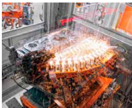
Fig. 11. Bland otaliga exempel på fjärrlasersvetsning ses här dörrsvetsning på BMW Mini (ovan) och Audi A3 (t.v.) modellerna.
