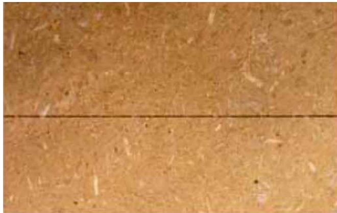
Figur 1. Denna spånplatta fick en tydlig märkning av en anvisningslinje för spikning vid blott 10 W lasereffekt och en processhastighet på 15,2 m/min (50 ft/min).
