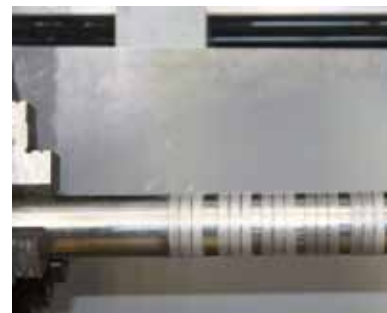
Figur 22. Principen för höghastighetspåläggning bygger på att fokuspunkten befinner sig åtskilliga millimeter ovanför substratets yta så att det tillförda pulvret redan befinner sig i smält tillstånd då det träffar ytan. Därtill en speciellt utvecklad maskin för höghastighetspåläggning från företaget Hornet, och t.h. den rostfria cylinder som under experimenten belades med Inconel625.
