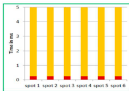
Figur 33. Vid pulsad svetsning av koppar får man ett betydligt stabilare resultat då man använder en "grön" laser (t.v.) istället för en IR-dito. I staplarna ovan anger rött tiden till dess att smältpunkten uppnåtts och orange motsvarande då förångningstemperaturen nåtts för de olika punkterna.
