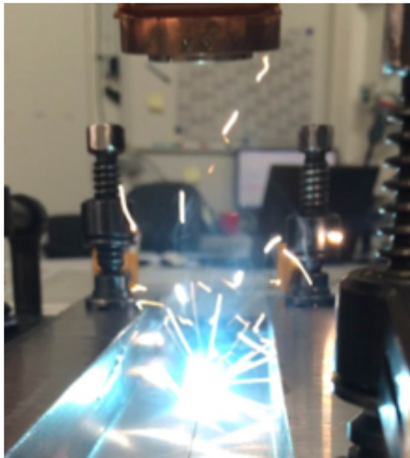
Lasersvetsning med optik för att dela upp laserstrålen i tre strålar.
