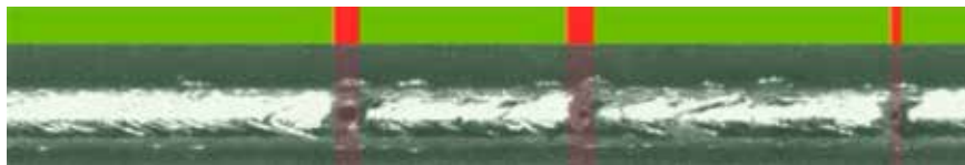
Figur 4. Dokumentation av produktkvaliteten i form av med rött markerade porer i en panoramabild över lödfogens hela längd.
