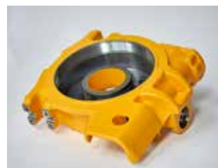
Bild 2. Laserhårdad slityta på rotatorkomponent
