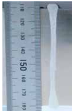
Figur 7. Stumsvetsning av 70 mm tjockt SUS 304-material med 100 kW lasereffekt och två motstående svetssträngar klaras med en processhastighet av 2 m/min.
