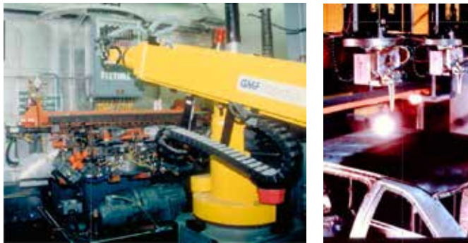
Figur 26. En tidig laserapplikation i amerikansk bildindustri var svetsning av kylarbalken till Chevrolet Caprice vilken utfördes med en 5 kW CO 2 -laser från Spectra Physics och en L-100 Fanuc-robot. Längst t.h. en annan ”klassiker” taklasersvetsning på Chevrolet Beretta i GM:s Linden-fabrik 1985, vilket var den första ”in-line” lasersvetsapplikationen i världen.
