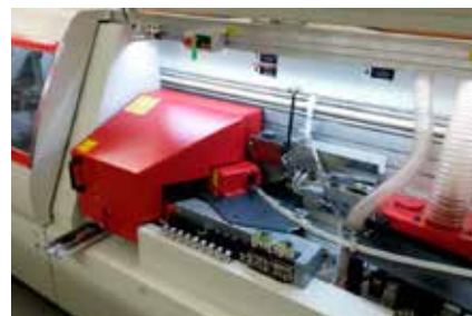
Figur 24. Några av många praktikfall där lasrar av VCSEL-typ används; t.v. utplacering av kolfiber-laminat och t.h. sömlös kantförsegling av träpaneler hos möbelföretaget IMA.
