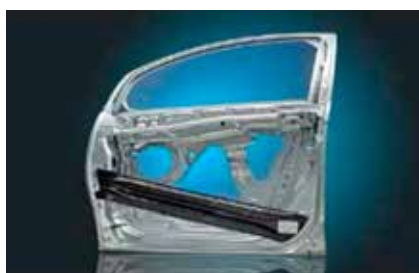
Figur 9. Några exempel från PSA Peugeot Citroën där plastkomposit fogas till metall redan idag men då med lim i kombination med mekaniska förband; fr.v. C4 Picasso bakkörr och bakre golv på EMP2-plattformen. För sidodörrar i kommande modellprogram (t.h.) överväger man dock att använda sig av laser för att foga den fiberförstärkta sidokrockbalken till metallstrukturen.
