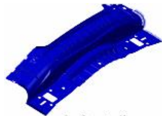
Außenteil (Blechstärke: 0,8 mm)
