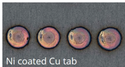
Figur 7. Ovan topp- respektive bottenyta vid pulsad svetsning av tunna nickelbelagda kopparfolier utförd med Coherents skannerverktyg "SmartWeld+". T.h. svetsning av kontaktdon där det "ormlika" svetsmönstret medför en ökad elektrisk ledningsförmåga.
