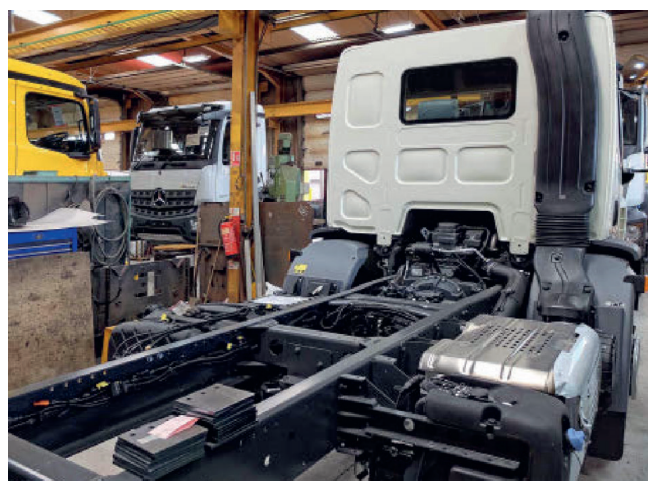
Figur 5. Inledningskedet av påbyggnadsprocessen får varje lastvagnschassi sitt unika serienummer för att förenkla spårbarheten av det färdig-utrustade fordonet.
