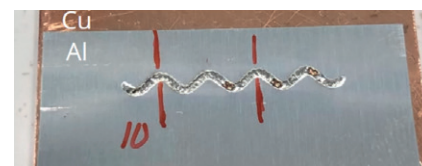
Figur 7. Ovan topp- respektive bottenyta vid pulsad svetsning av tunna nickelbelagda kopparfolier utförd med Coherents skannerverktyg "SmartWeld+". T.h. svetsning av kontaktdon där det "ormlika" svetsmönstret medför en ökad elektrisk ledningsförmåga.
