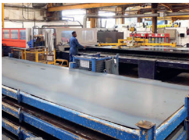
Figur 4. 6 meter långa formatplåtar med standard-bredden 1.830 mm lagras i s.k. racks. I bortre delen av fotot ser man hur en sådan plåt är på väg att överföras till skärslans växelbord.
