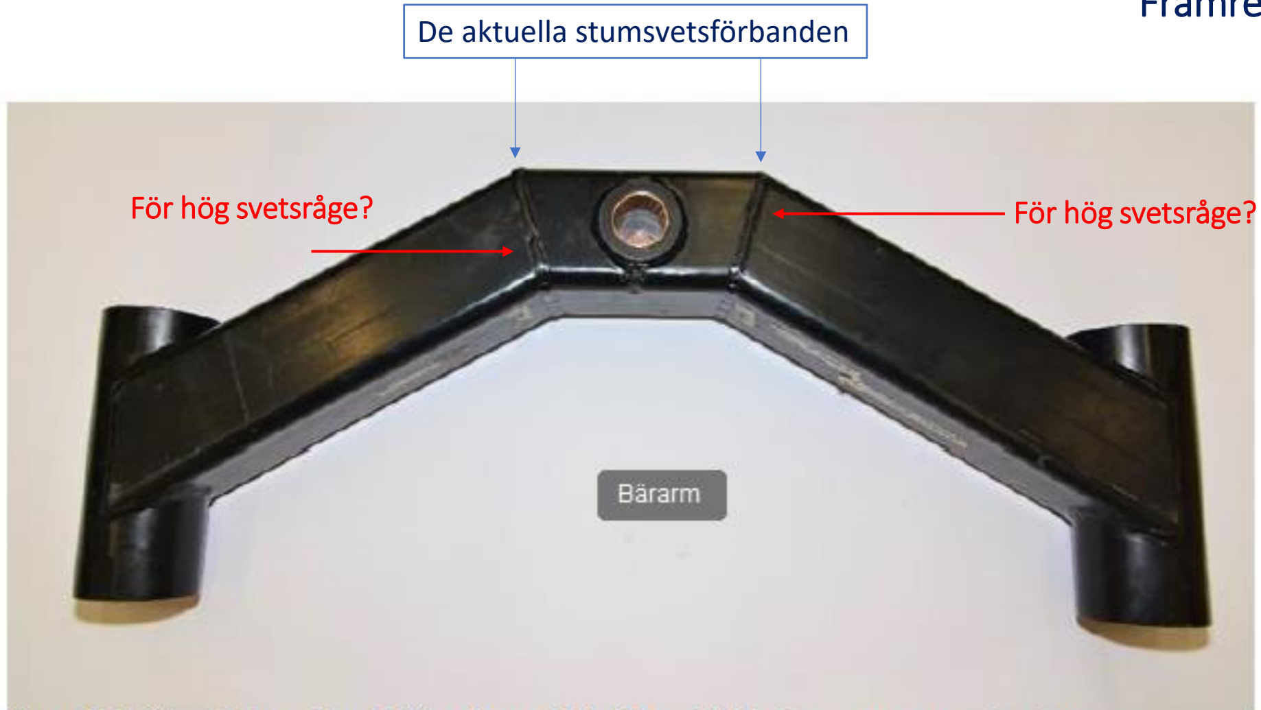
Figur 8. En främre bärarm till ett Jetline-tåg med hålet för axelfästningen mot vagnen i mitten.
