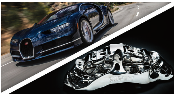
Bromsoken till Bugatti-modellerna Chiron och Veyron är de idag största serietillverkade SLM-komponenterna i bilindustrin.
