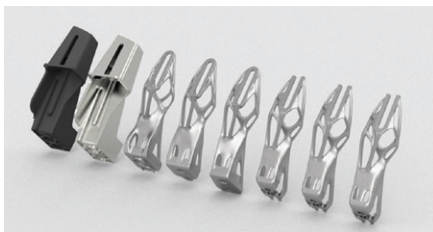
BMW menar sig ha introducerat personbilsindustrins första "volymproducerade" SLM-detaljer i form av två 11g lätta konsoler i mekanismen till det reglerbara taket i cabriolet-versionen av den eldrivna BMW i8 Roadster.
