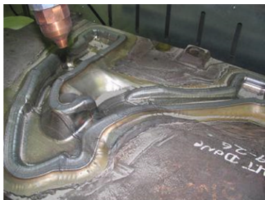
Reparation av pressverktyg och förstärkning av klippverktyg för tillverkning av karoskomponenter är tidiga exempel på där additiva metoder kom till användning i bilindustrin.
