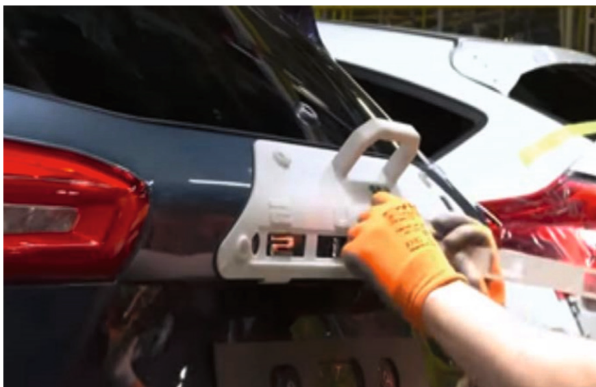
3D-printade plastfixturer för monteringshjälp börjar bli allt vanligare förekommande, t.ex. i Fords slutmonteringslinjer.
