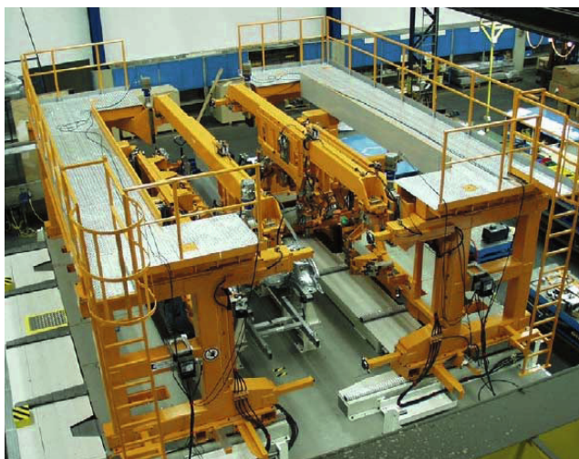
Figur 3. 14 laserkällor som betjänar 1 arbetsstation. Den synnerligen imponerande "framing-stationen" utvecklad i samarbete med KUKA Schweissanlagen i Augsburg. Den är så utformad att den skall kunna klara av hela Volkswagens modellprogram, allt från minstingen Lupo till SUV:n Touareg.
