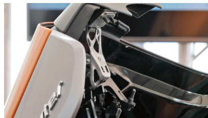
BMW menar sig ha introducerat personbilsindustrins första "volymproducerade" SLM-detaljer i form av två 11g lätta konsoler i mekanismen till det reglerbara taket i cabriolet-versionen av den eldrivna BMW i8 Roadster.
