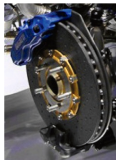
Bromsoken till Bugatti-modellerna Chiron och Veyron är de idag största serietillverkade SLM-komponenterna i bilindustrin.
