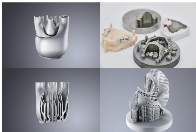
Figur 2: Fantastiska designmöjligheter där man kan bygga olika interna strukturer i en och samma komponent som exempelvis kanaler och nät och därmed efterlikna det mesta.
